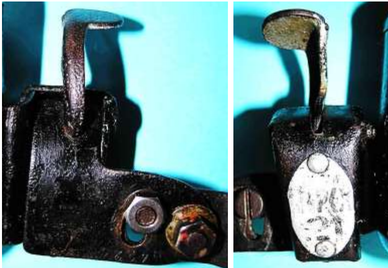
Bild 5.5: Kippvorrichtung: a) Halterblech mit Langloch zur Ausrichtung auf die Radachse, b) Basisblech
