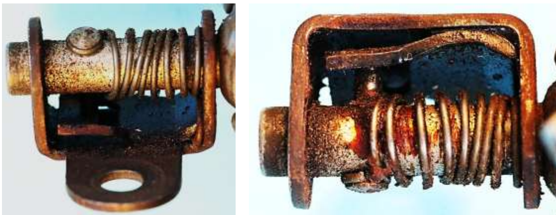
Bild 1.2: Am Basisblech angenietetes Kulissenblech
