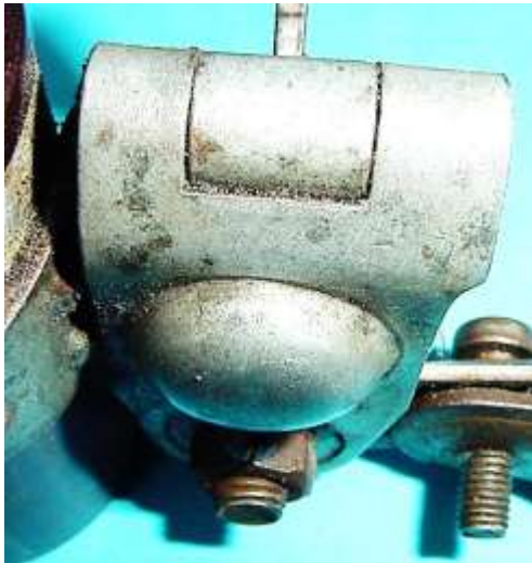
Bild 5.18: Scharnierbolzen in den Augen des Basis- und Halterblechs
