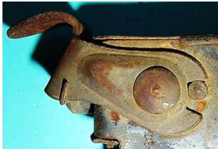
Bild 2.2: Fußhebel zur Entriegelung des Dynamos
