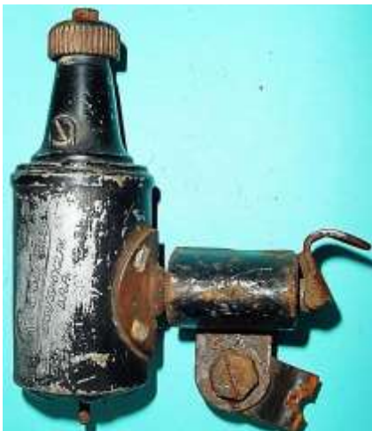
Bild 2.2: Fußhebel zur Entriegelung des Dynamos
