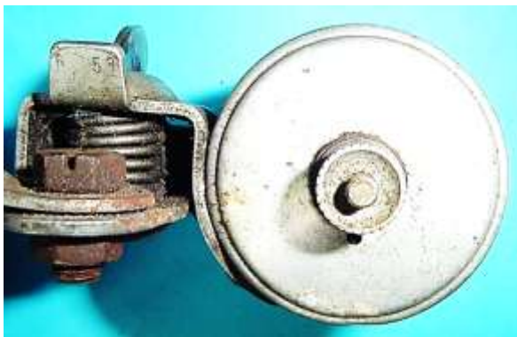
Bild 5.19: Druckfeder: a) Ruhestellung, b) Betriebsstellung
