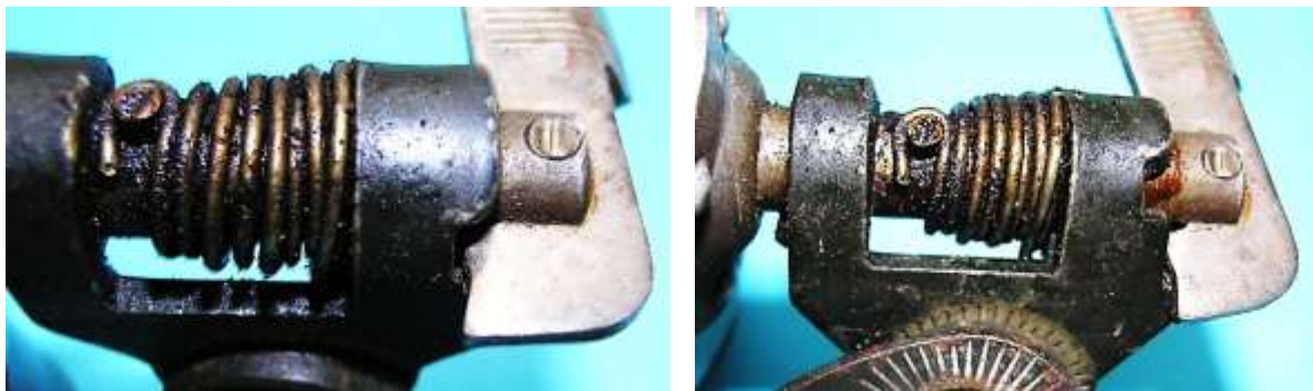
Bild 3.4: Drehpunkt des Bedienungshebels im Drehbolzen: a) Ruhestellung, b) Betriebsstellung
