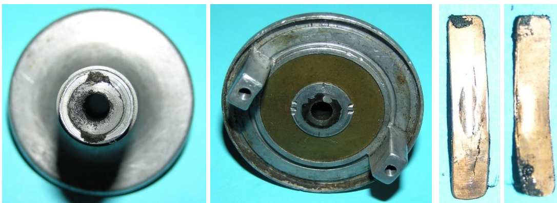
Bild 2.53: Lageschild: a) Stirnseite mit Nuten für den Filz im Öldepot, b) Angegossene Zapfen für Gewindegrundbohrungen und Lageschild, c) Im Lagerrohr quer eingelegtes Schleifblech
