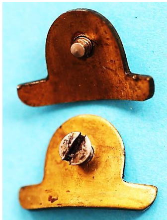
Bild 4.17: Axiale Sicherung des Ankers: a) Senkkopfschraube am Mantelrand, b) Messingbleche, c) Position der Messingbleche im Gehäuse
