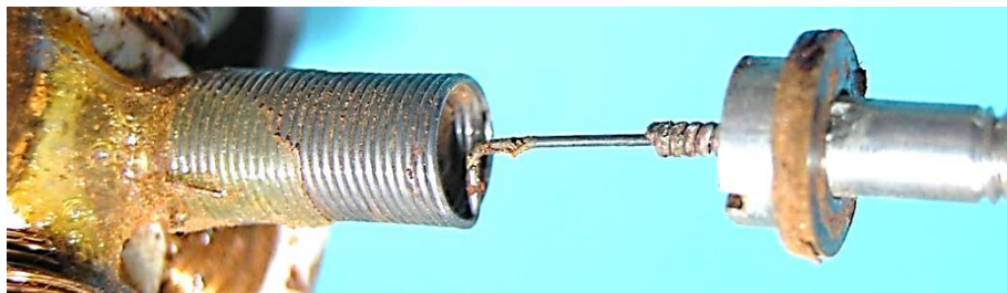
Bild 2.38: Paarung des rotierenden und des ruhenden Kontakts
