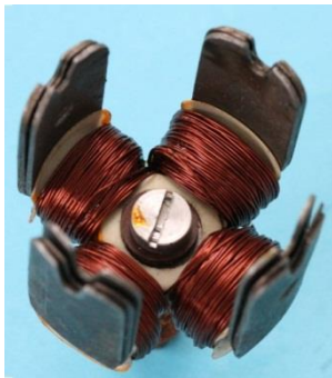
Bild 4.25: Anker: a) Anker mit Kabelbolzen, b) Kontur der Blätterpole, c) Mit drei Blechen verstärktes Joch
