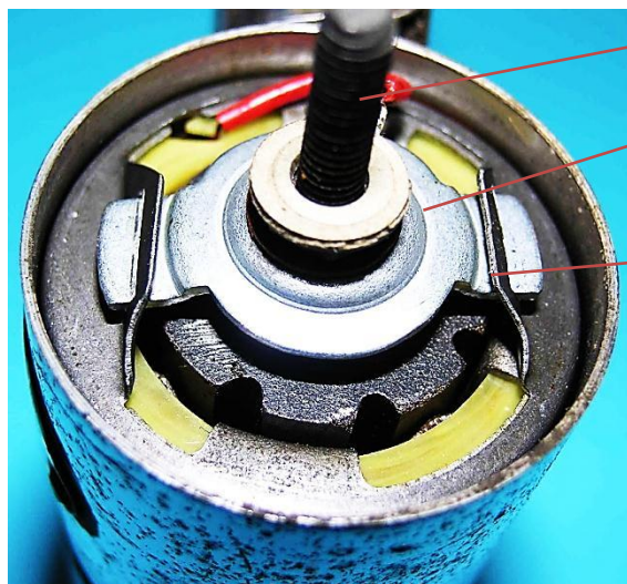
Bild 5.4: Anker, Polrad und Kabelanschlussbolzen bei abgenommenem Boden
