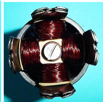
Bild 4.10: Generator und Lagerhals a) Positionierung des Generators im Lagerhals; b) Vierpoliger Blätterpolanker
