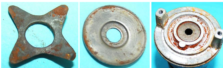
Bild 2.43: Axialspieeleinstellung: a) Blattfeder, b) Andruckteller, c) Lagerhalsfuß
