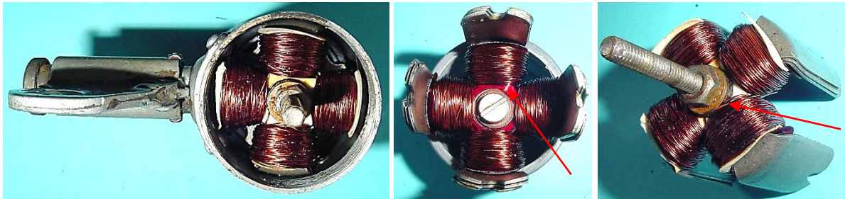
Bild 4.40: Ankerwicklung: a) Gehäuse mit eingebautem Anker, b) Ansicht des Ankers von der Polradseite mit dem Wicklungsanschluss am Ankereisen, c) Ankerwick- lungsanschluss am Kabelanschlussbolzen
