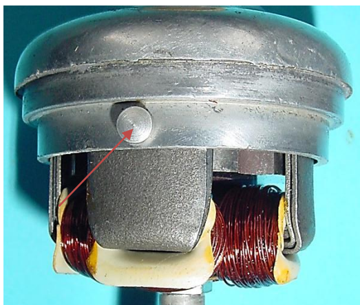
Bild 4.11: Arretierung des Ankers am Lager- halsfuß
