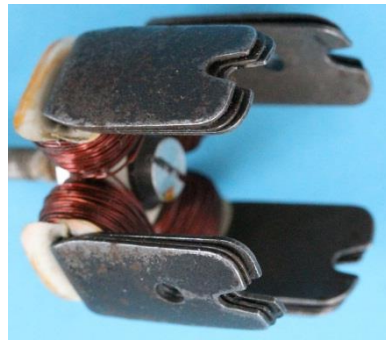
Bild 4.25: Anker: a) Anker mit Kabelbolzen, b) Kontur der Blätterpole, c) Mit drei Blechen verstärktes Joch
