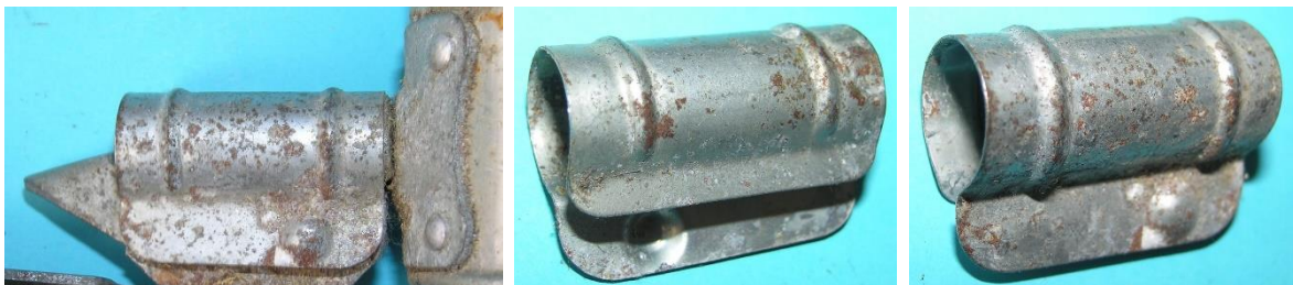
Bild 2.18: Verschiebbare Abdeckung der Kippvorrichtung
