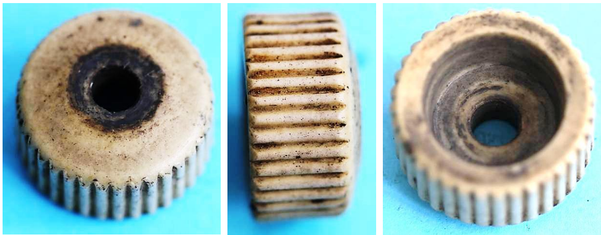
Bild 4.20: Keramikreibrad: a) Obere Ansicht, b) Lauffläche
