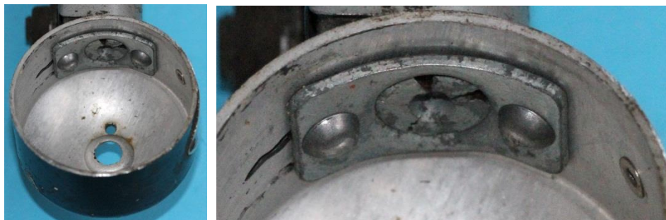
Bild 4.22: Flansch der Kippvorrichtung innerhalb des Gehäusetopfes
