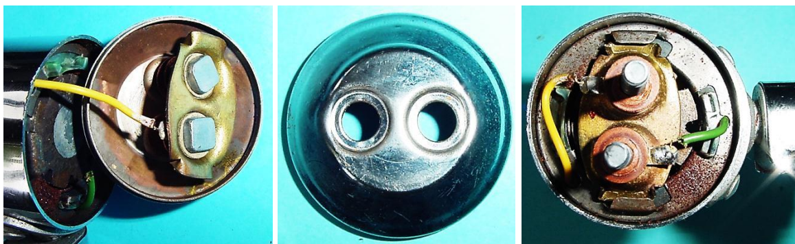
Bild 5.9: Kontakte: a) Bodendurchführung der zwei Kabelbolzen, b) Boden, c) Befestigung des Kontaktstegs durch zwei angeschnittene Blechlaschen
