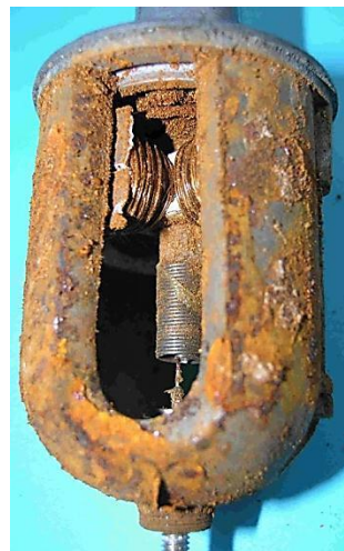
Bild 2.35: Vierpoliger Tulpenmagnet: a) Spannbolzen in einer Pollücke, b) Freie Pollücke
