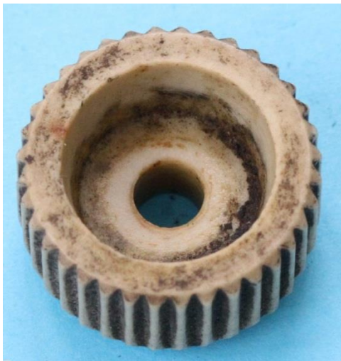
Bild 4.27: Keramikreibrad ohne Konturen für die Verdrehsicherung zwischen den Kontermuttern
