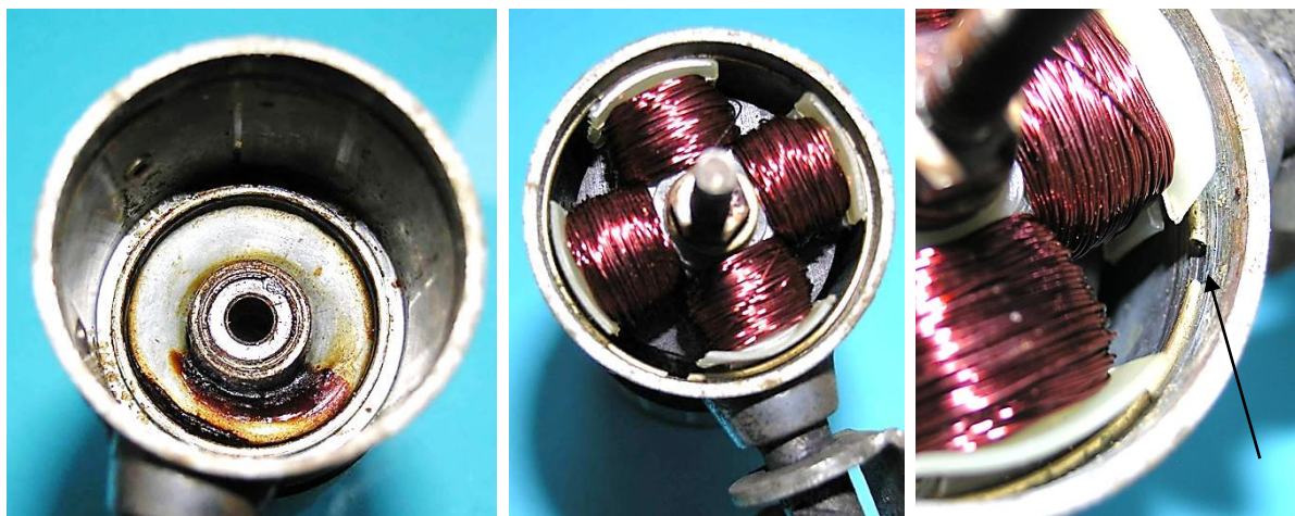
Bild 4.44: Lagerhalstopf: a) Im Lagerhalstopf eingesetzten Lagerteller, b) Vierpoliger Anker im Lagerhalstopf, c) Offener Drahring zur axialen Sicherung des Ankersitzes
