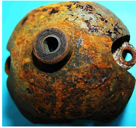
Bild 2.34: Doppelwandiges Rohr: a) Äußere Verschraubung des Rohres, b) Rohr im Magneten eingeschraubt
