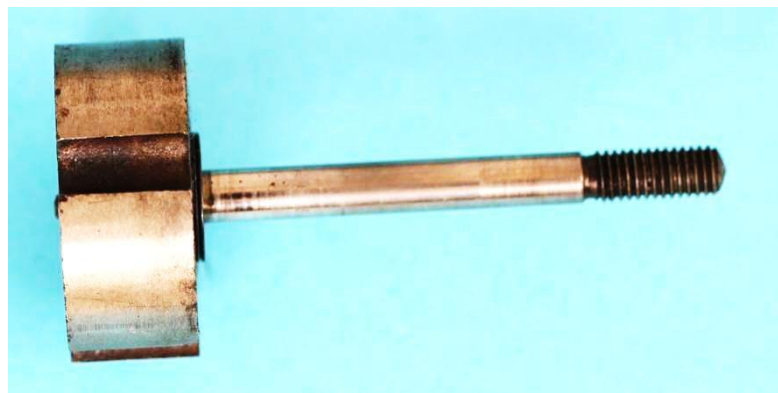
Bild 4.18: Vierpoliges Polrad mit eingegossener Welle
