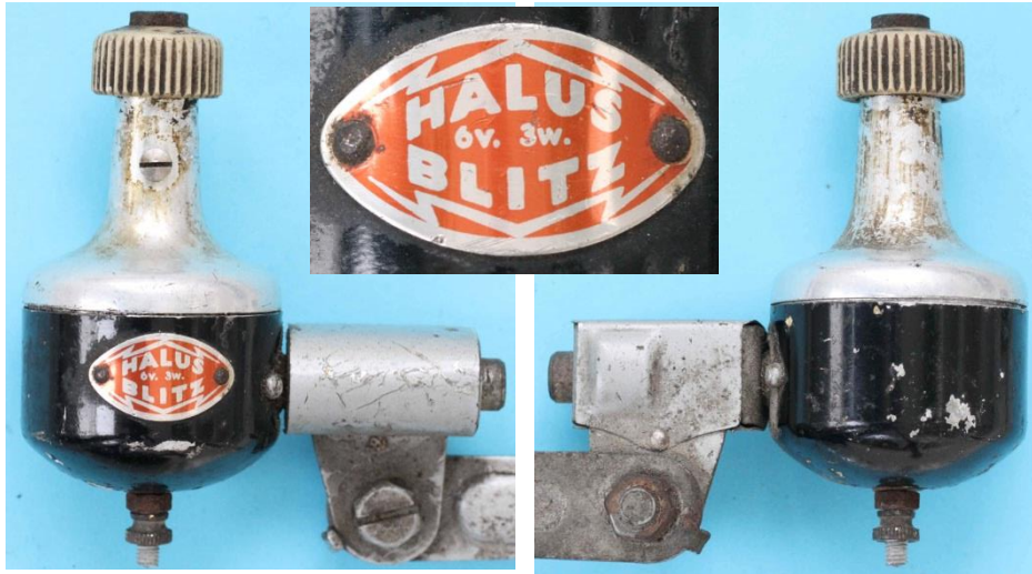
Bild 4.21: Zweites Gehäusekonzept von Halus Blitz
