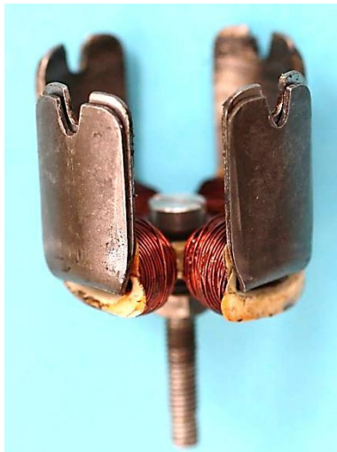
Bild 4.16: Ankerpolflächen ohne Stanzlöcher
