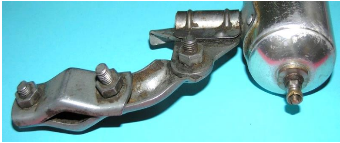
Bild 2.8: Abgewinkelte Kanten des Halters, Blechdicke 1,5 mm
