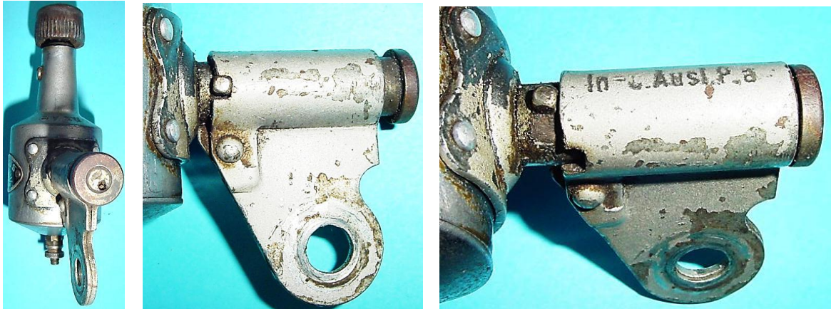
Bild 4.30: Stellungen der Kippvorrichtung: a) Eingerasteter Sperrstift in der Ruhestellung, b) Sperrstift gleitet an der Stirnseite des Basisblechs
