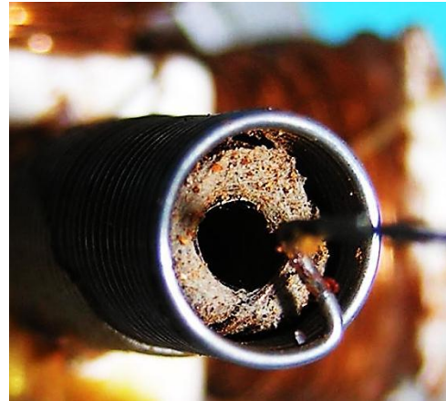
Bild 2.39: Schraubenfeder mit abgewinkeltm Ende: a) Position am Wellenende, b) Befestigung auf einen Isolierkörper
