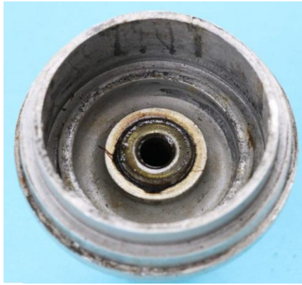
Bild 4.23: Lagerung: a) Oberes Gleitlager b) Unteres Gleitlager
