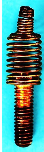
Bild 3.13: Kabelanschlussbolzen mit eingezogener Schraubenfeder als Schleifkontakt
