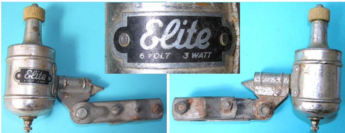
Bild 2.17: Vierpoliger Elite-Dynamo, 3 W, Gewicht 434 g
