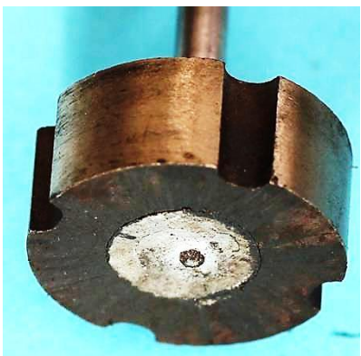
Bild 4.18: Vierpoliges Polrad mit eingegossener Welle
