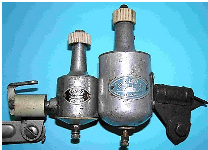
Bild 4.42: Demonstration des Entwicklungssprungs durch die Ablösung des Magnetstahls durch AlNi-Magnete oder durch keramische Magnete.
