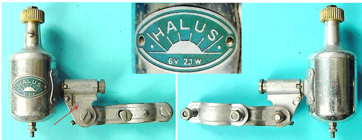
Bild 4.1: Blätterpoldynamo Halus 2,1 W mit der Beschriftung des Halterarms „Made in Germany-Wester Zone“
