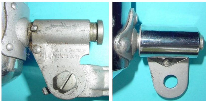
Bild 1.14: Verschiebebolzenkippvorrichtungen: a) Abgesetzte Bedienungsfläche, b) Bedienungsfläche stimmt mit dem Drehbolzenquerschnitt überein
