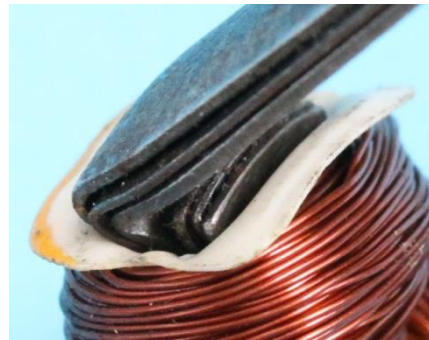
Bild 4.25: Anker: a) Anker mit Kabelbolzen, b) Kontur der Blätterpole, c) Mit drei Blechen verstärktes Joch
