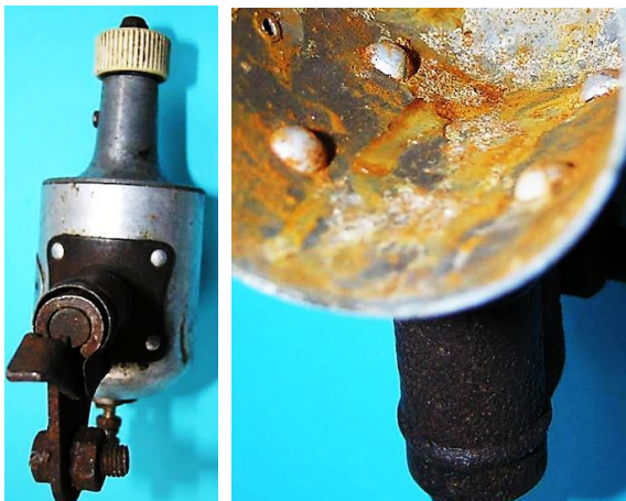
Bild 2.30: Befestigung der Kippeinrichtung a) Angenieteter Flansch, b) Erhabene Nieten innerhalb des Gehäusetopfes
