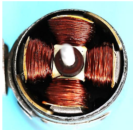
Bild 4.17: Axiale Sicherung des Ankers: a) Senkkopfschraube am Mantelrand, b) Messingbleche, c) Position der Messingbleche im Gehäuse
