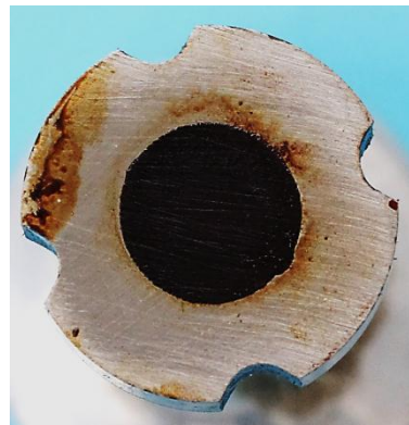
Bild 4.24: Vierpoliges Polrad, Durchmesser 30 mm, axiale Länge 13 mm a) Welleneinsatz b) Abschluss der Wellenbohrung
