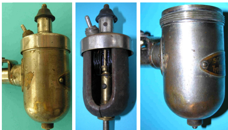
Bild 1.12: Gehäuse: a) Vollständige Ansicht des Gehäuses, b) Lagerhals mit Generator, c) Gehäusetopf
