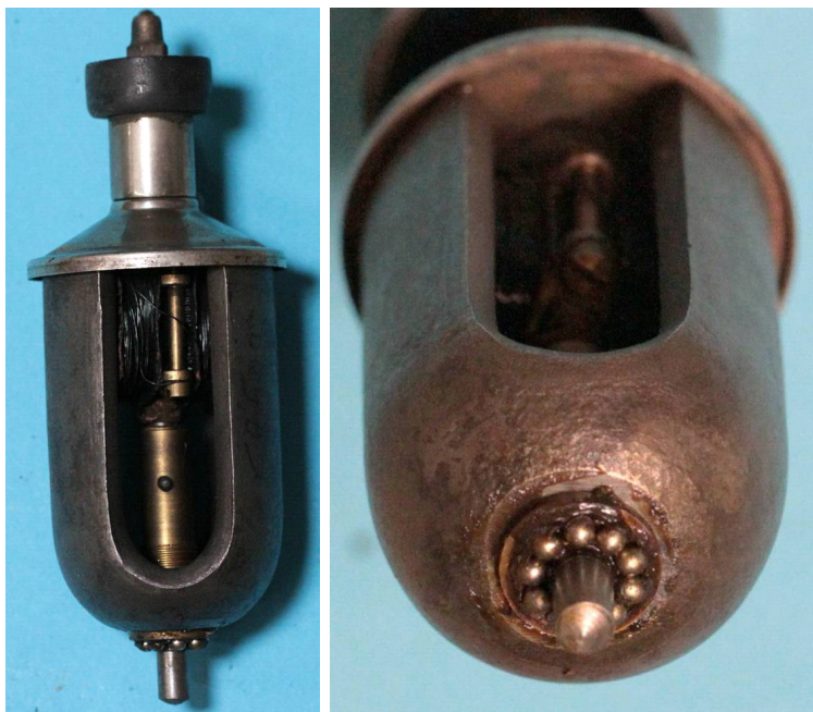
Bild 1.7: Rotierendes Polsystem: a) Blick auf den Anker und die Welle durch eine Pollücke, b) Stützlager unter dem Magneten
