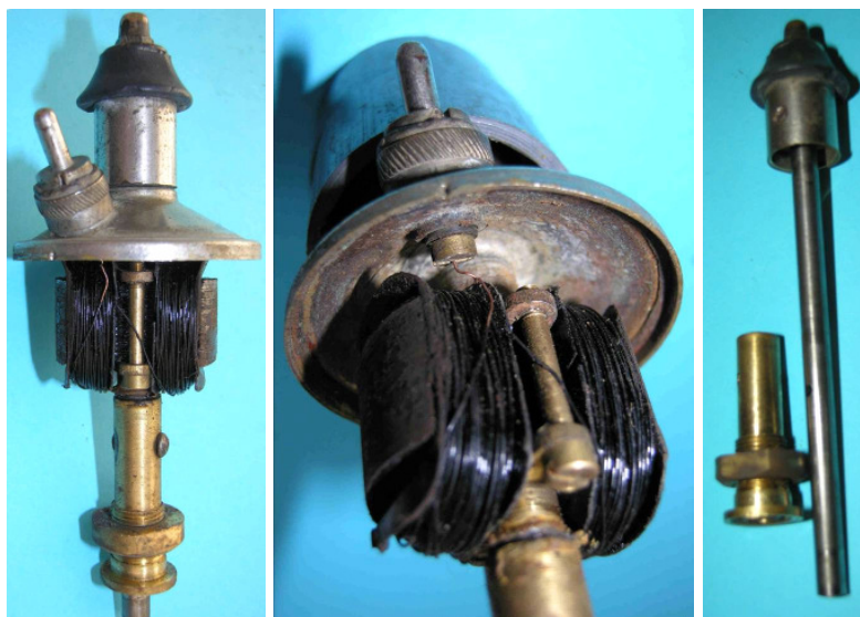
Bild 1.26: Anker und Welle: a) Lagerhals mit Spannung führendem Kontakt, b) Befestigung des Ankers am Lagerhals, c) Reibrad mit Welle und Lagerschalrohr
