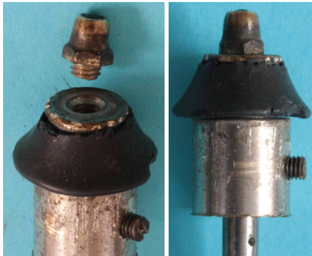
Bild 1.25: Ölnippel am Reibrad: a) Austrittsöffnung des Ölkanals in der Welle, b) Herausgeschraubter Ölnippel
