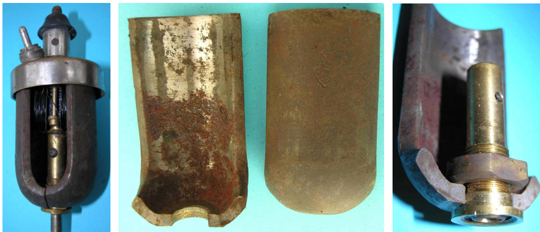
Bild 1.29: Zweipoliger Tulpenmagnet: a) Eingebaute Position, b) Zerbrochener Magnet, c) Befestigung des Magneten am Lagerschildrohr
