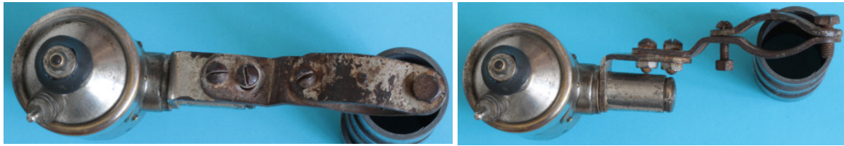
Bild 1.10: Freier Drehbereich des Dynamos: a) Arbeitsstellung, b) Ruhestellung
