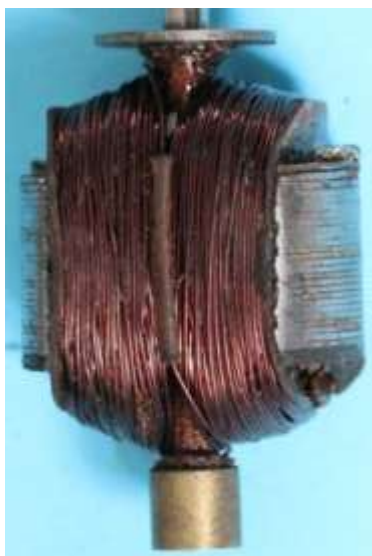
Bild 1.11: Anker: a) Ankerwicklung, b) Ankerblechpaket
