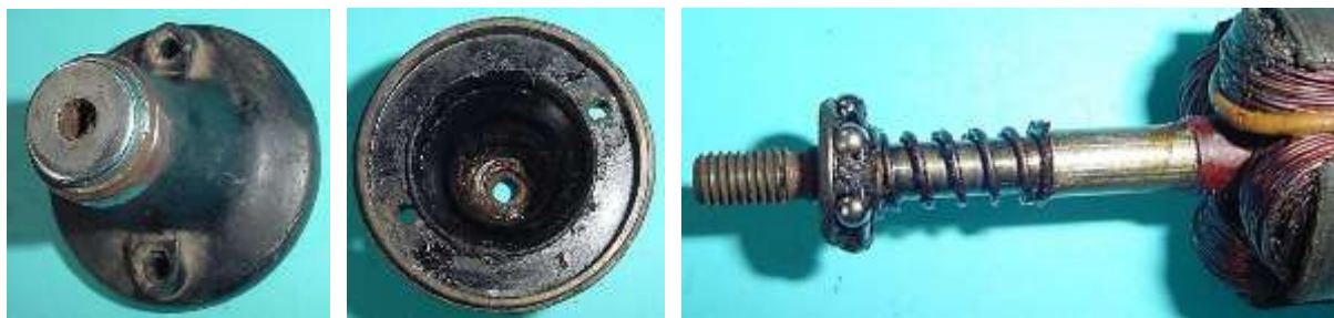
Bild 2.2: Lagerhals und Wellenende mit Kugellager und Feder für den Axialspelausgleich
