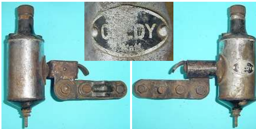
Bild 1.3: Stabmagnet-Dynamo mit der Typenbezeichnung „Coldy“ (3 W)
