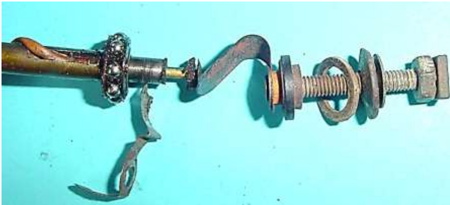
Bild 2.10: Stromleitung von der Spule zum Kabelanschluss
