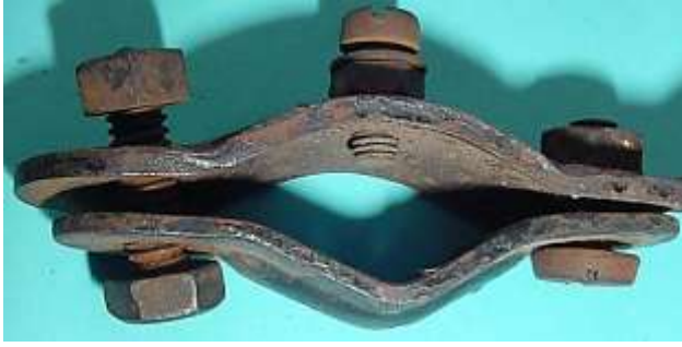
Bild 2.9: Halterung mit Masseschraube
