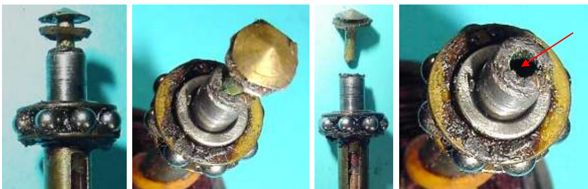
Bild 2.11: Spannung führender Kontakt: a) Kontaktpilz mit Isolierscheibe, b) Position des Kontaktpilzes in der axialen Wellenbohrung, c) Herausgezogener Kontaktpilz, d) Axiale Wellenbohrung
