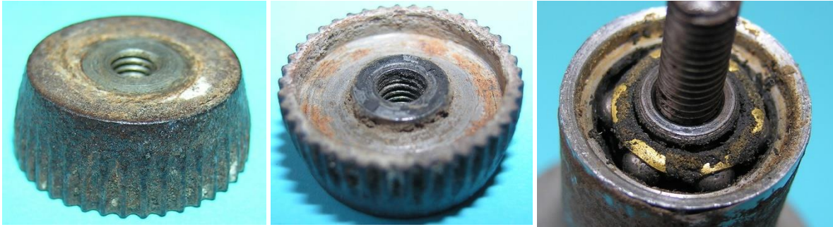
Bild 17: Einstellung des Axialspiels mit dem Reibrad: a) Lauffläche des Reibrades, b) Freiraum zum Schutz des Lagers, c) Oberes Kugellager
