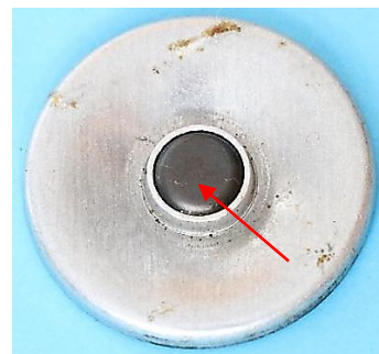
Bild 4.7: Lagerung: a) Lagerhals mit Polrad und Axiallager, b) Lagerschild mit Axialkugellager, c) Untere Seite des Lagerschildes
