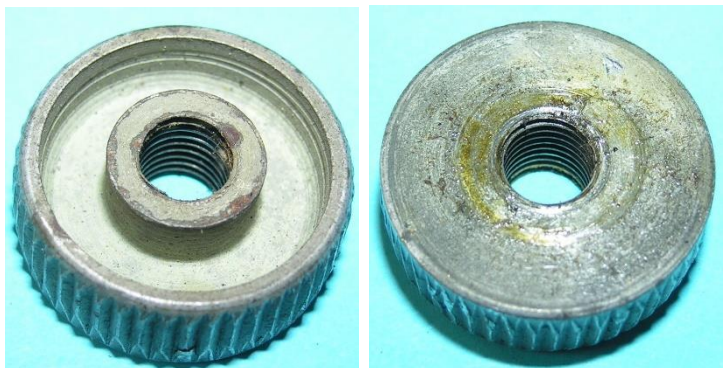
Bild 3.12: Beide Seiten des aufschraubbaren Reibrades: Durchmesser 26 mm, Höhe 9 mm
