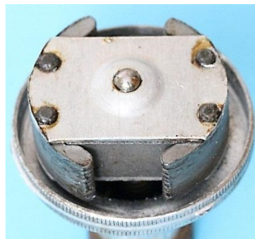
Bild 4.6: Polrad: a) Obere Blechplatte b) Untere Blechplatte 1,5 mm dick mit Axiallager, Durchmesser: 38,5 mm, Polblechpakete mit 8 Ble- chen 1,5 mm dick
