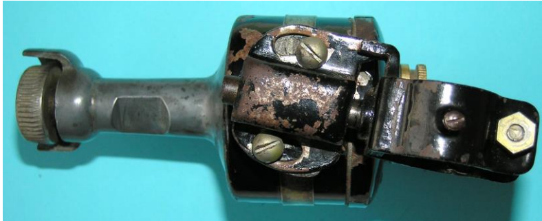
Bild 3.3: Befestigung der Kippvorrichtung mit zwei Schrauben am Flansch
