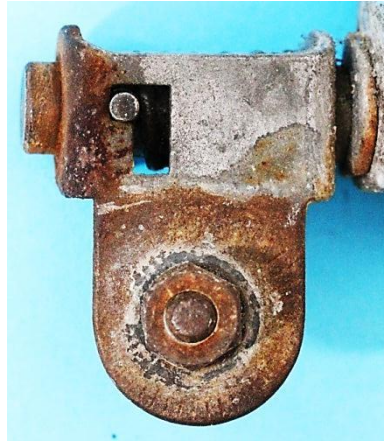
Bild 4.16: Kippvorrichtung: a) Druckfeder mit Sperrstift b) Sperrstift in der Ruhestellung
