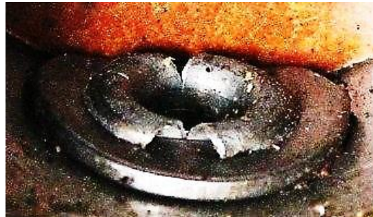
Bild 4.17: Befestigung des Drehbolzens am Gehäusetopf
