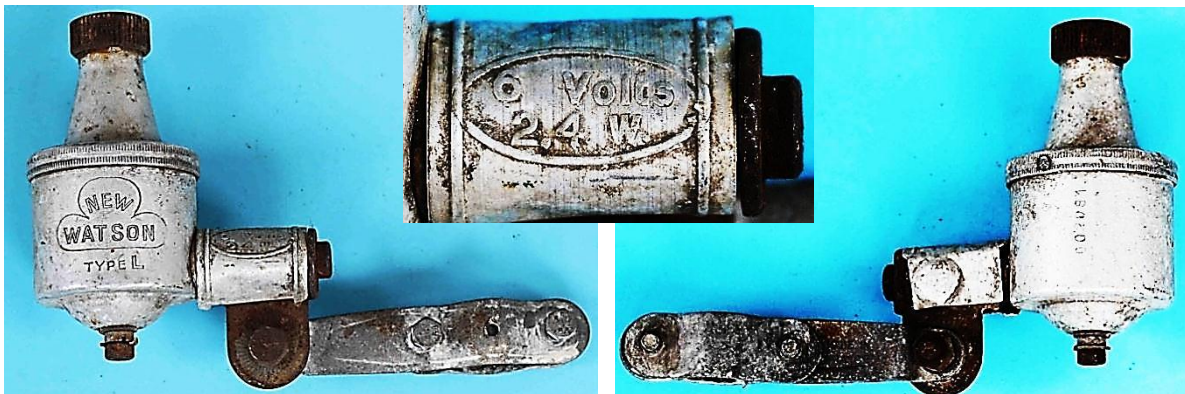
Bild 4.1: Dynamo (6 V; 2,4 W) mit der Beschriftung auf der Abdeckung der Kippvorrichtung, Gewicht ohne Halter 280 g
