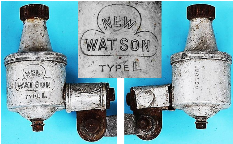
Bild 4.3: Dynamo mit der Beschriftung des Gehäusemantels
