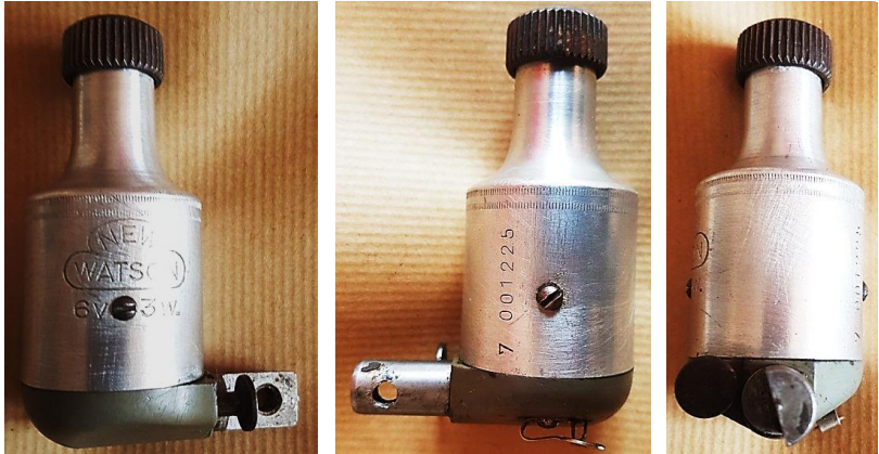
Bild 1.7: New Watson 6V, 3W, Fertigungsnummer: 7 001225
