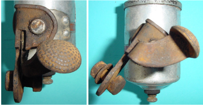
Bild 1.3: Ruhe- und Betriebsstellungen des Dynamos
