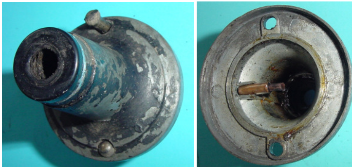
Bild 1.13: Lagerhals: a) mit Schrauben, b) mit Massebürste
