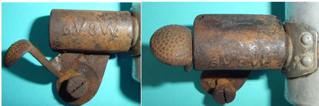
Bild 1.2: Ruhe- und Betriebsstellungen des Dynamos
