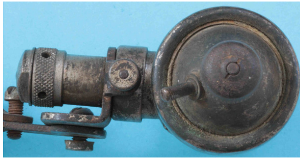
Bild 1.12: Ansicht von oben auf den Lagerhals und die Kippeinrichtung
