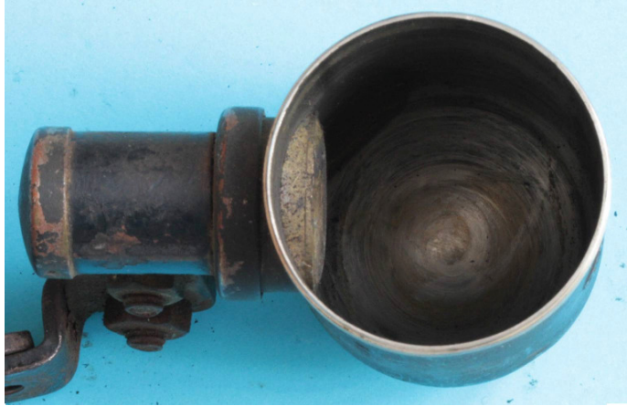
Bild 1.24: Druckplatte im Innenraum des Gehäusetopfes
