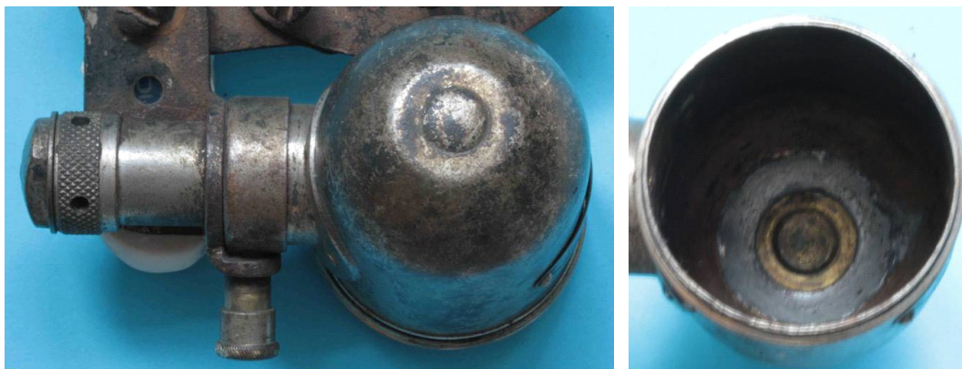
Bild 1.11: Bodengestaltung: a) Bohrungsverschluss von außen, b) Bohrungsverschluss von innen
