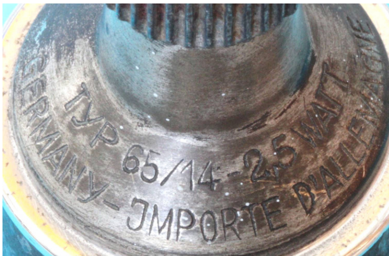
Bild 1.51: Einprägungen auf dem Lagerhalsfuß: Typ65/14, 2,5 W
