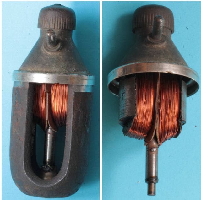
Bild 1.19: Magnetischer Kreis: a) Tulpenmagnet mit Anker b) Anker mit dem Spurlagerwellenende
