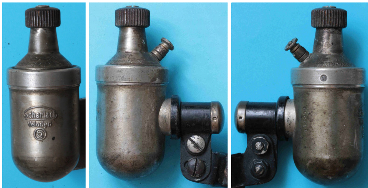
Bild 1.41: Drei Ansichten: a) Frontansicht mit der Typenbezeichnung, b) Seitenansicht, c) Seitenansicht mit Plombensicherung des Überwurfrings
