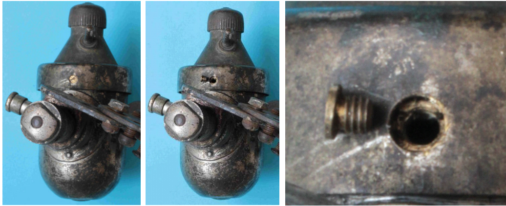
Bild 1.9: Arretierung des Gewinderings: a) Schlitzschraube im Gehäusemantel, Herausgedrehte Schraube, c) Schraube und übereinander stehende Bohrungen des Gewinderings und des Gehäusemantels
