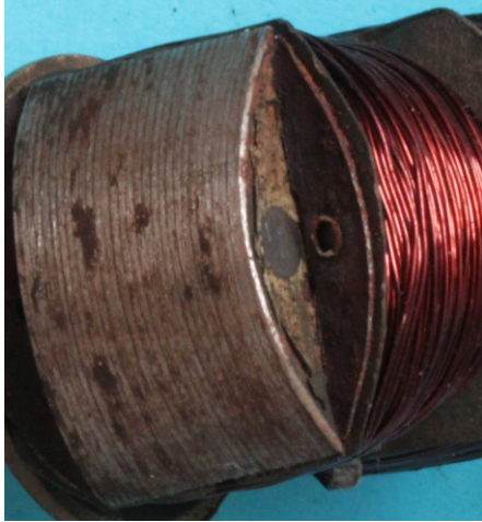
Bild 1.27: Abgewinkeltes Endblech zur Stabilisierung des Wickelkopfes
