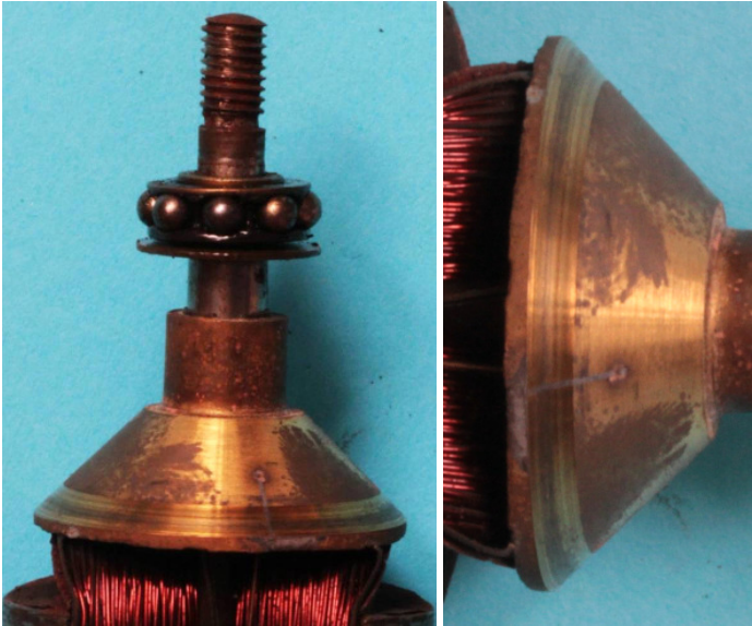
Bild 1.30: Wicklungsanschluss am Schleifkegel
