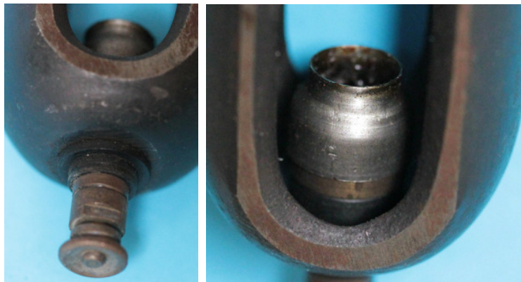
Bild 1.65: Spurlager: a) Mit dem Spurlager verbundener Kabelbolzen, b) Isoliertes Spurlager
