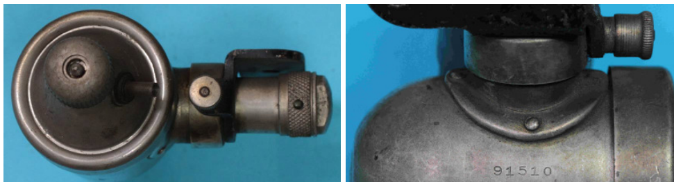
Bild 1.21: Gehäuseansicht: a) Ansicht von oben, b) Fertigungsnummer auf dem Gehäusemantel
