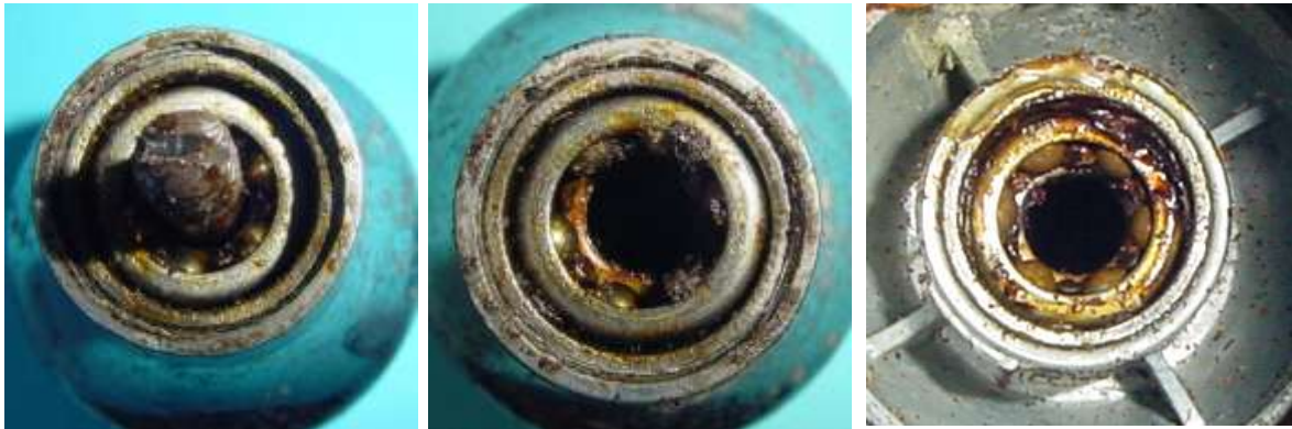
Bild 4.7: Lagerung: a) Welle mit Lager, b) Lager unter dem Reibrad, c) Unteres Lager
