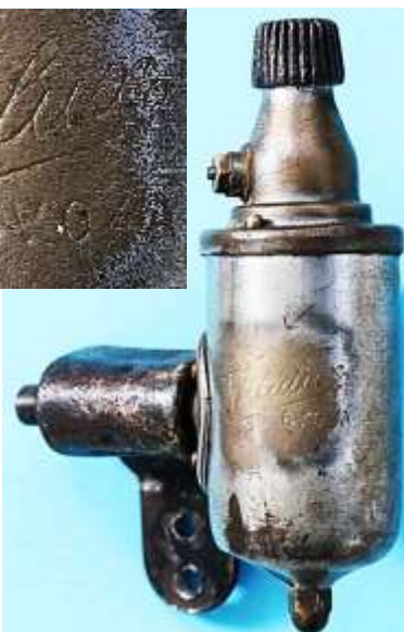
Bild 1.1: Zweipolige Tulpenmagnetdynamos der Marke Vitalux mit unterschiedlicher Gehäusebeschriftung, 6 V, 0,4A,
