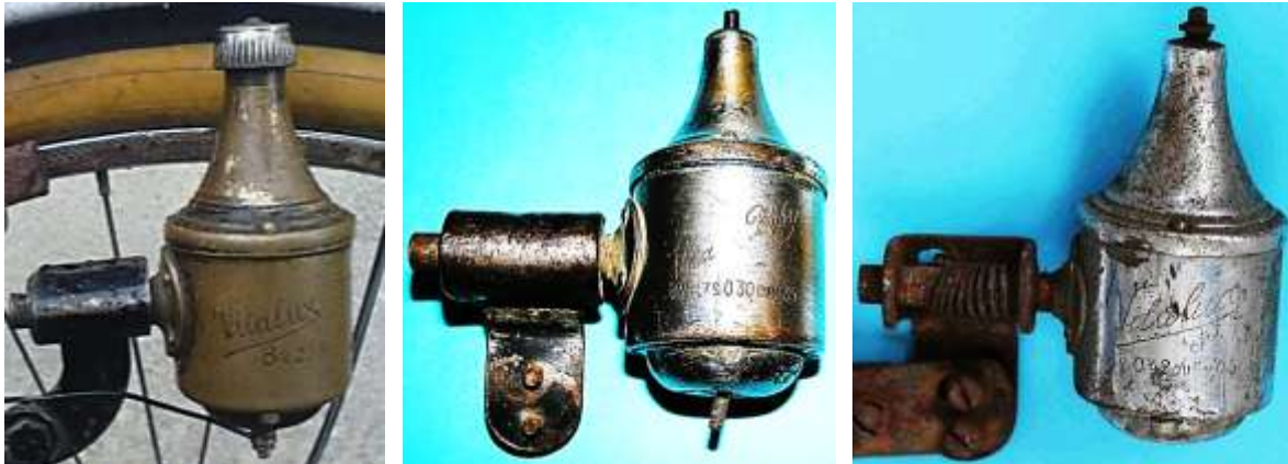
Bild 1.3: Wechsel vom ruhenden Tulpenmagneten zum rotierenden AlNi-Blockmagneten: a) Vitalux, Tulpenmagnetdynamo für 8 V und 0,25 A, b) Vita Baby, AlNi-Blockmagnetdynamo für 6 V und 0,3 A, c) Vitalux, AlNi-Blockmagnetdynamo für 6 V und 0,42 A
