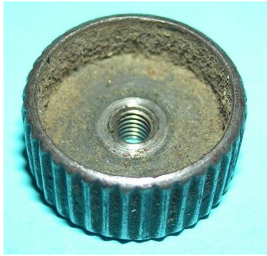
Bild 12: Reibrad mit Hohlraum zur Überdeckung des Gleitlagers
