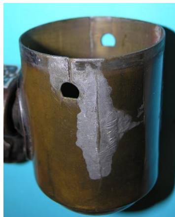
Bild 4: Gehäuseteile a) Lagerhals aus 1 mm starkem Messingblech b) Gehäusetopf aus 0,7 mm starkem Messingblech
