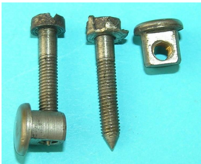
Bild 5: Schraubelemente für die Befestigung des Gehäusetopfes am Lagerhalsfuß
