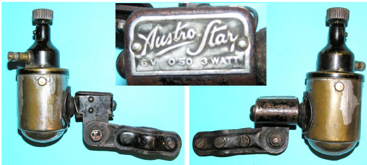
Bild 1; Seitenansichten des Typs Austro-Star, Gewicht: 690 g + 80 g
