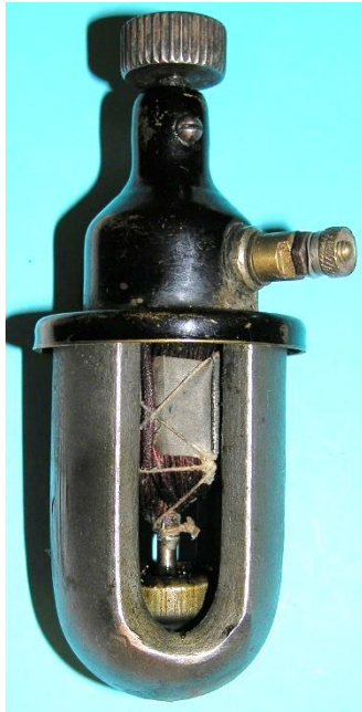
Bild 6: Kabelanschluss im Lagerhals: a) Dynamo ohne Gehäusetopf, b) Baugruppe aus Kabelanschluss und Bürstenhalter
