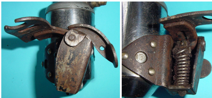
Bild 1.6: Betätigungshebel mit Feder
