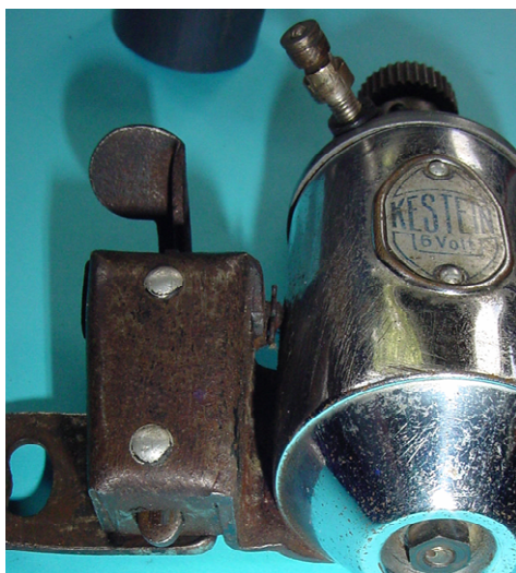
Bild 1.7: Sichtbares Stößelende unter der Kippvorrichtung
