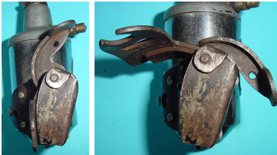
Bild 1.4: Zwei Stellungen der Kippvorrichtung
