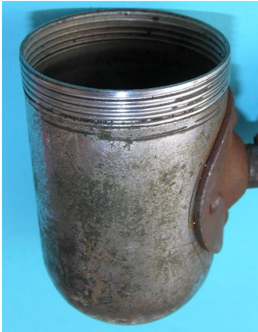
Bild 5.3: Miteinander verschraubbare Gehäuse- seteile
