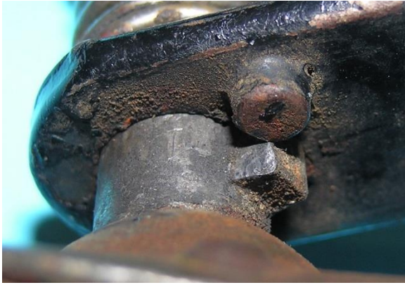
Bild 2.16: Drehwinkelbegrenzung: a) Zapfen auf der Gehäusesseite, b) Vernietung auf der Basisblechinnenseite
