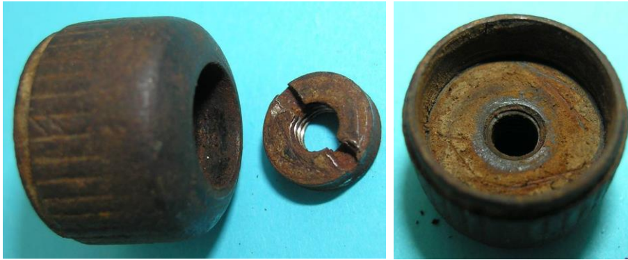
Bild 3.3: Reibrad a) Laufspuren an der Oberfläche, b) Schlitzmutter, c) Rand zum Schutz des Lagers
