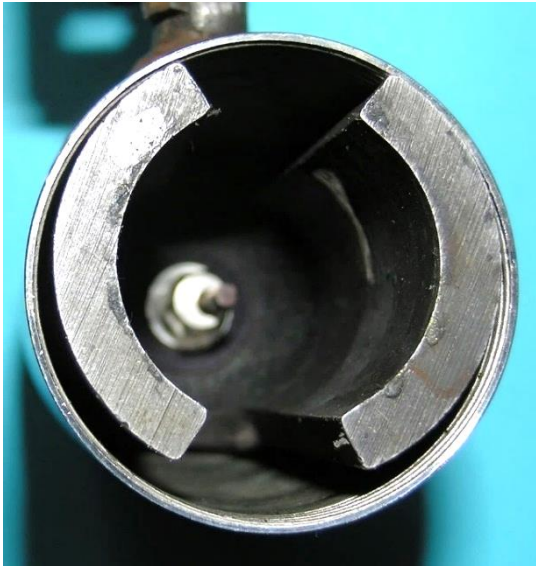
Bild 5.6: Spielpassung zwischen dem Gehäusetopf und dem Magneten
