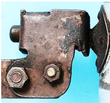
Bild 2.6: Funktionen des Anschlagstegs: a) Sicherung der Schlitzschraube gegen ein selbständiges Lösen in der Ruhelage und Abstützung der Feder am Basisblech, b) Anschlag des Sperrstifts am Anschlagsteg
