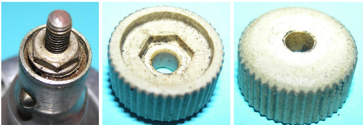
Bild 4.11: Reibrad aus Speckstein: a) Kontermutter, b) Formschluss, c) Reibradoberfläche
