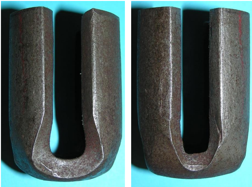
Bild 4.5: Vierpoliger Tulpenmagnet: a) Pollücke für den Spannsteg b) Freie Pollücke
