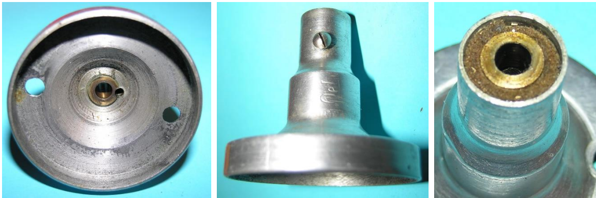
Bild 4.10: Lagerhals: a) Lagerhalsfuß, b) Ölbohrung, c) Öldepot
