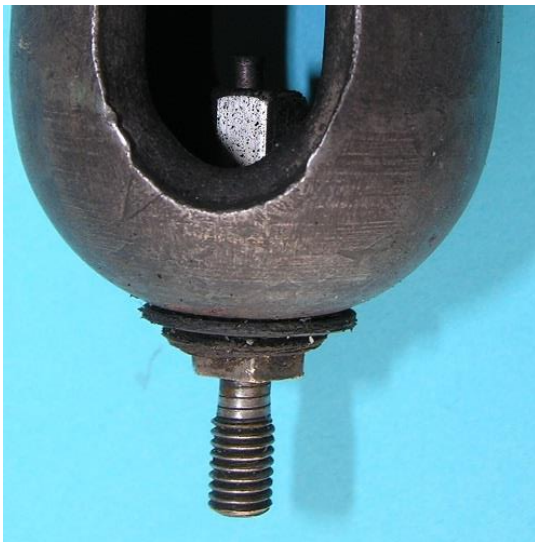
Bild 5.7: Spannung führender Anschluss: a) Isoliert eingesetzter Kabelanschlussbolzen, b) Bürste, Bürstenhalter und Kabelanschlussbolzen, c) Schleifkappe und Lötstützpunkte
