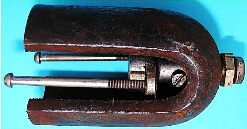
Bild 3.6: Tulpenmagnet mit Spurlager
