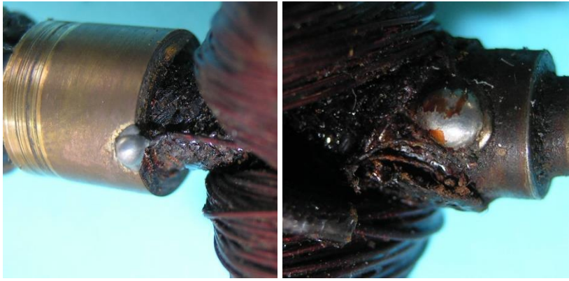
Bild 3.16: Spulenan- schlüsse: a) Spannung führender Kontakt, b) Masseanschluss
