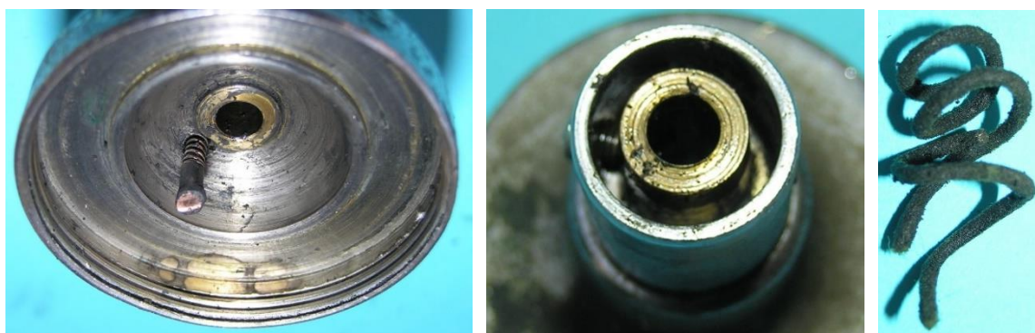
Bild 5.9: 30 mm langes Gleitlager: a) Untere Stirnseite mit Massebürste, b) Öldepot, c) Ölschnur
