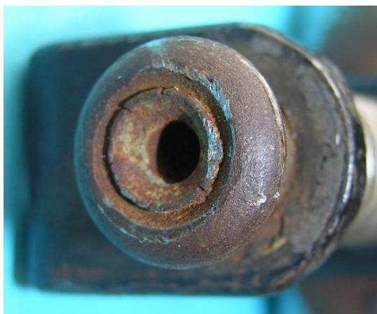
Bild 2.18: Befestigung des Bedienungsknopfes durch Aufweiten einer Grundbohrung im Drehbolzen
