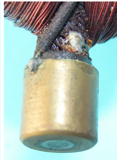
Bild 5.7: Spannung führender Anschluss: a) Isoliert eingesetzter Kabelanschlussbolzen, b) Bürste, Bürstenhalter und Kabelanschlussbolzen, c) Schleifkappe und Lötstützpunkte
