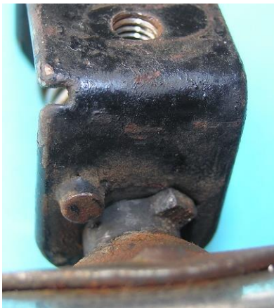
Bild 2.17: Eingenieteteter Zapfen zur Drehwinkelbegrenzung:
