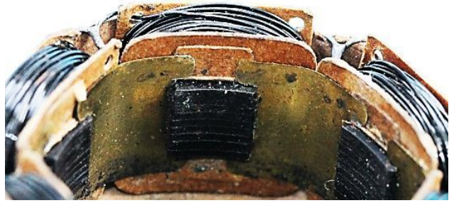
Bild 5.25: Lamellierte Bauteile: a) 12 mm Blechpaket im Polrad, b) 9mm langes Ankerblechpaket
