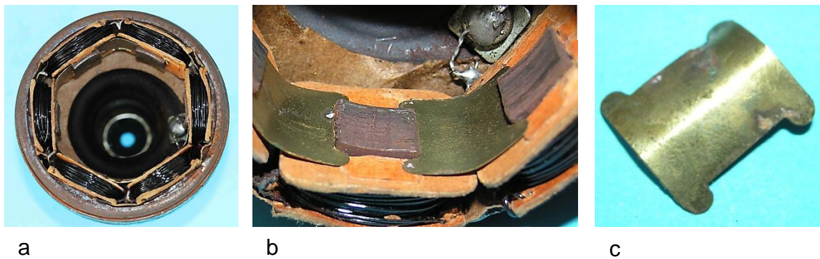
Bild 3.12: Pollückenbleche: a) Anker, b) Eingespannte Pollückenblech, c) Kontur eines Pollückenblechs
