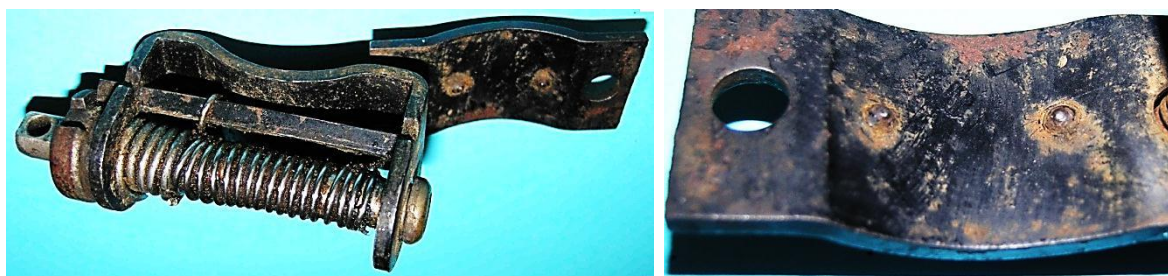
Bild 5.20: Kippvorrichtung: a) Abgenommene Abdeckung, b) Schelle mit Massekontakt spitzen
