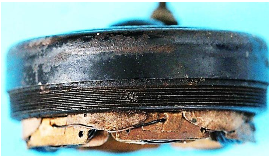
Bild 5.21: Bodenschale mit dem vollständigen Anker und dem Gewinde zum Aufschrauben des Lagerhalses
