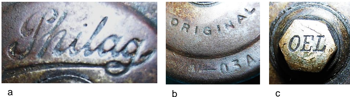
Bild 5.29: Beschriftung des Bodens mit der Typenbezeichnung und den Nenndaten
