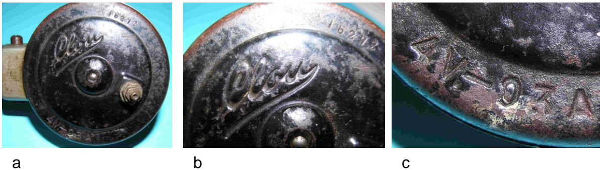
Bild 5.13: Beingeprägte Bodenbeschriftung: a) Gesamtansicht des Bodens, b) Typenbezeichnung „Clou“, c) Nenndaten 4 V; 0,3 A
