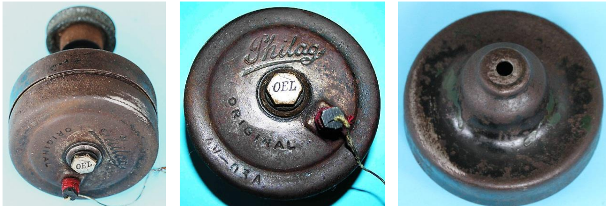
Bild 5.28: Ansichten nach der Behandlung mit einem Rostlösmittel
