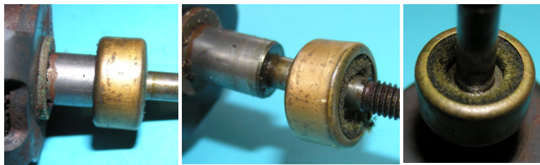
Bild 1.7: Fettdepot unterhalb des oberen Kalottenlagers
