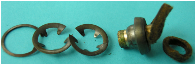
Bild 1.8: Oberes Kalottenlager bestehend aus: Lagerhülle, Stahlkalotte, Öldepot, zwei Kalottenbrillen, Sicherungsring
