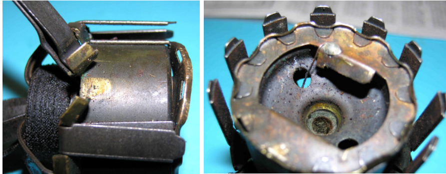
Bild 1.16: Zylindrischer Grundkörper mit Kalottenlager-schild
