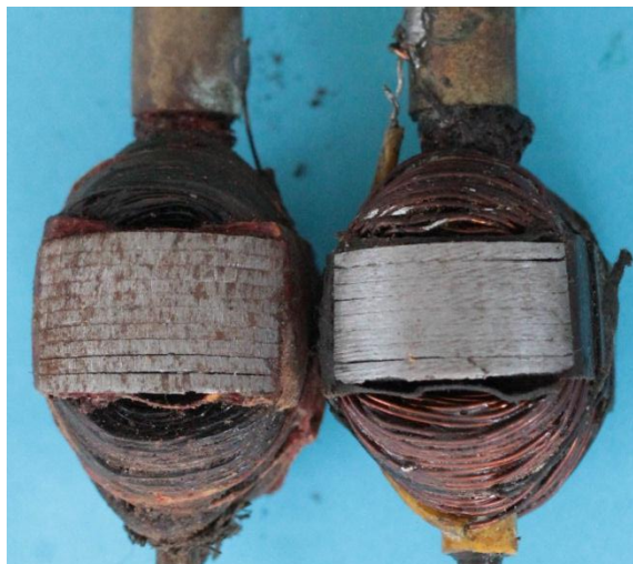
Bild 3.3: Vergleich der Blechpakete a) Dynamo mit Drahtfederverbindung b) Dynamo mit Schraubverbindung
