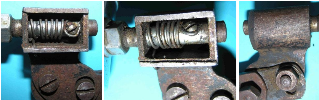
Bild 2.4: Kippvorrichtung: a) Ruhstellung, b) Betriebsstellung, c) Massiver Basiskörper
