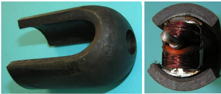
Bild 5.9: Tulpenmagnet: a) Bohrung im Joch, b) Stirnflächen des Magneten
