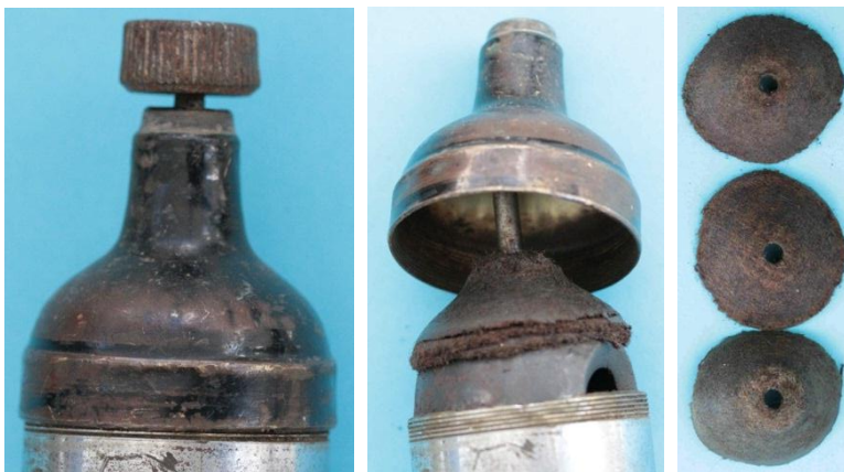
Bild 4.2: Gehäuseteile, a) Lagerhals und Gehäuse- topf mit Feingewinde ver- schraubt b) Jochbogen mit Filz abge- deckt, c) Drei Filzmatten
