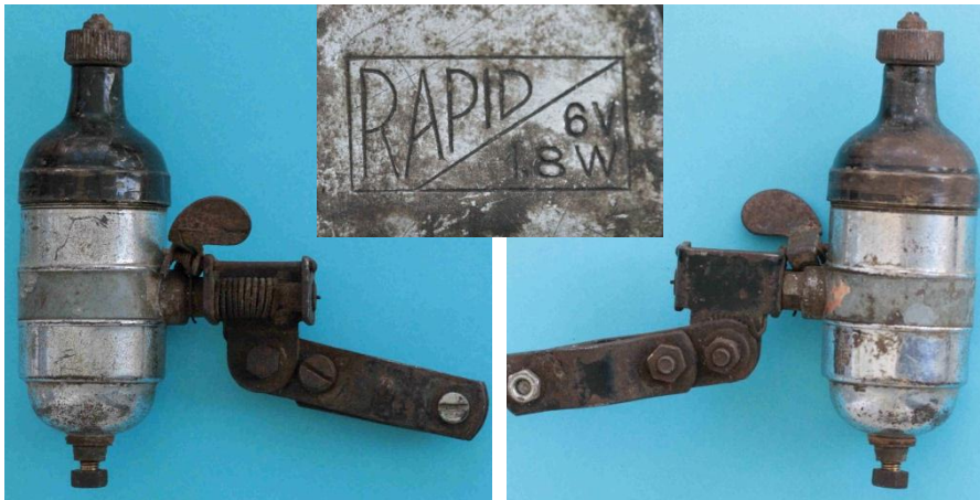
Bild 4.1: RAPID, Nenndaten: 6 V, 1,8W
