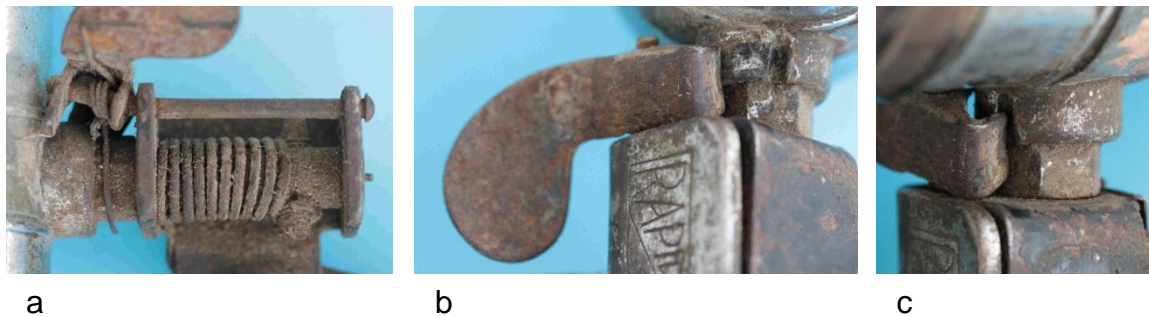
Bild 4.9: Kippvorrichtung: a) Ansicht der Druckfeder und der Sperrfeder, b) Betriebsstellung des Bedienhebels, c) Eingerasteter Bedienhebel in der Ruhestellung
