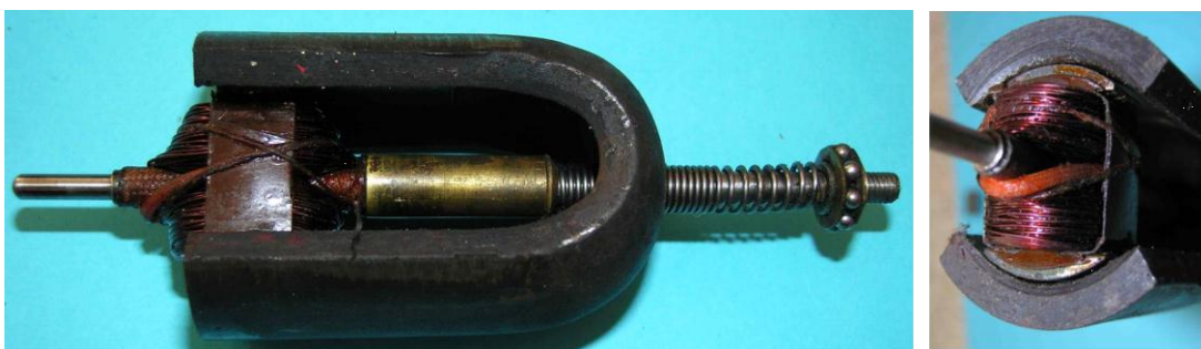
Bild 5.14: Position des Ankers zwischen den Polschuhen: a) Seitenansicht, b) Stirnansicht
