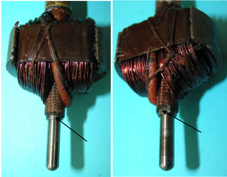
Bild 5.12: Einseitige Fläche auf der Welle: a) Runde Seite, b) Abgeflachte Seite
