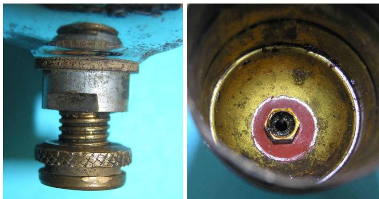
Bild 5.10: Spannung führender Kontakt: a) Kabelbolzen und Rändelmutter, b) Spurlager am Ende des Kabelbolzens
