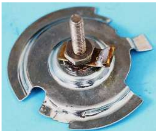
Bild 2.5: Spannung führender Anschluss: a) Kabelbolzen mit Lötstützpunkt, b) Oberseite der Kontaktplatte mit isoliert eingesetztem Kabelbolzen
