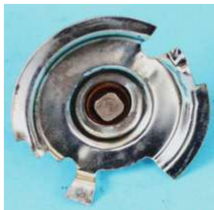
Bild 2.5: Spannung führender Anschluss: a) Kabelbolzen mit Lötstützpunkt, b) Oberseite der Kontaktplatte mit isoliert eingesetztem Kabelbolzen
