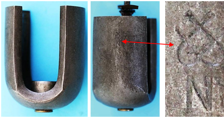
Bild 9.2: Zweipoliger Tulpenmagnet: a) Pollücke, b) Äußere Fläche des Polschenkels c) Firmenlogo des Magnetproduzenten
