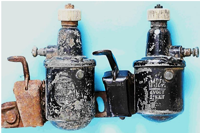
Bild 10.3: Verkleinerung der Gehäuselänge bei kleinerer Leistung: a) 3 W, b) 2,1 W
