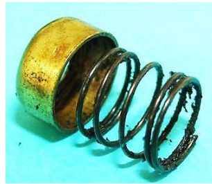
Bild 11.8: Komponenten des Strompfads: Schraubenfeder und Kontaktkappe
