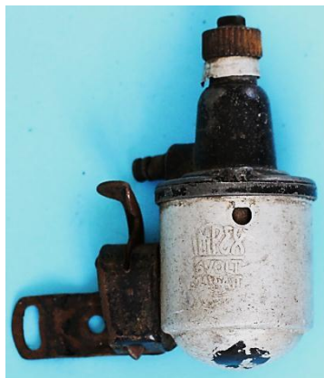
Bild 10.7: 2,1 W-Variante mit reduzierten Abmessungen der Kippvorrichtung
