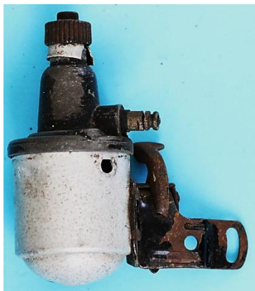
Bild 10.7: 2,1 W-Variante mit reduzierten Abmessungen der Kippvorrichtung
