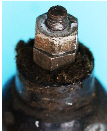
Bild 6.4: Reibrad mit Innensechskant zwischen zwei Muttern befestigt
