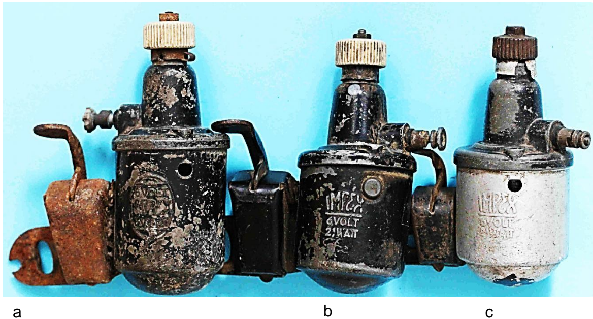
Bild 10.1: Vierpolige Impex-Varianten: a) 3 W, b) 2,1 W, c) 2,1 W mit kleinerer Kippvorrichtung
