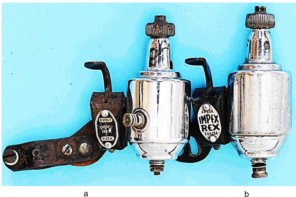
Bild 9.1: Zwei Ausführungen des Typs Impex-Rex: a) Kabelanschluss am Gehäusemantel, b) Kabelanschluss am Boden
