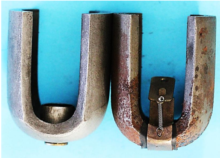
Bild 9.4: Zweipolige Tulpenmagnete: a) Mit Spurlager, b) Mit Schleifkontakt
