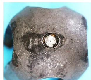
Bild 10.11: Spurlager: a) Ansicht durch eine Pollücke, b) Magnetjoch mit angeietetem Spurlager
