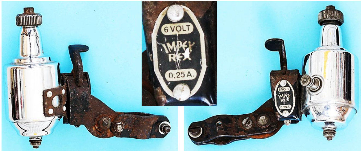
Bild 9.11: Impex Rex für 1,5 W: Dynamokörper mit Kippvorrichtung und Halter
