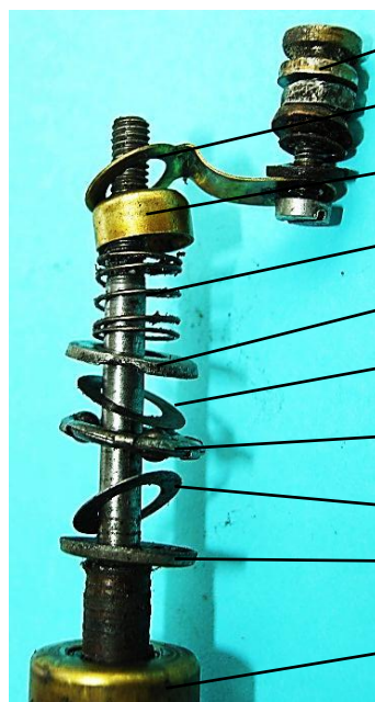
Bild 11.9: Spannung führender Kontakt: a) Anker mit den Spannung führenden Bauteilen auf der Welle, b) Einzelteile des Stromkreises vom Anker bis zum Kabelanschlussbolzen
