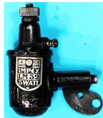
c) Impex LM 32 6 V, 4,8 W
