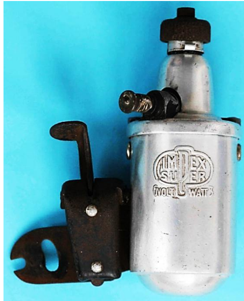
Bild 6.6: Impex-Super: 6 V; 3 W
