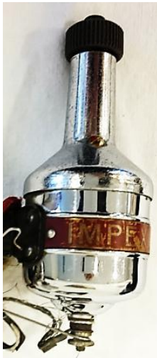
Bild 3.13: Impex: Übergangslösungen vom Tulpenmagnet-Dynamo zum Kugeldynamos Kippvorrichtung mit symmetrischem Flansch
