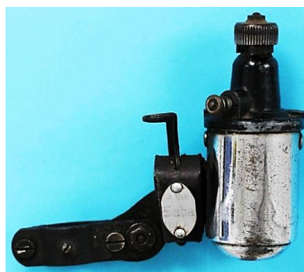
Bild 6.5: Impex-Saba: 4 V; 0,6 A
