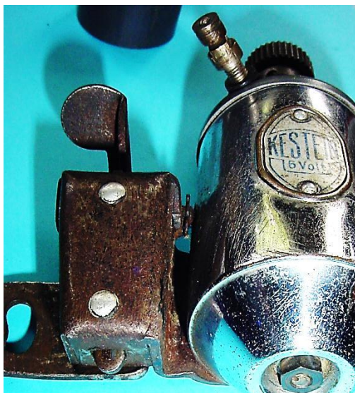
Bild 7.24: Sichtbares Stößelende unter der Kippvorrichtung
