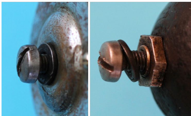
Bild 1.3: Schlitzschraube zur Befestigung des Gehäusetopfes am Magneten a) Schraube und Gehäusetopf, b) Schraube und Magnet
