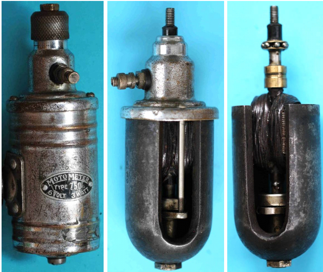
Bild 1.4: Aufbau der Type 750: a) Dynamo mit vernickeltem Messinggehäuse, b) Lagerhals mit Generator, c) Anker und Tulpenmagnet
