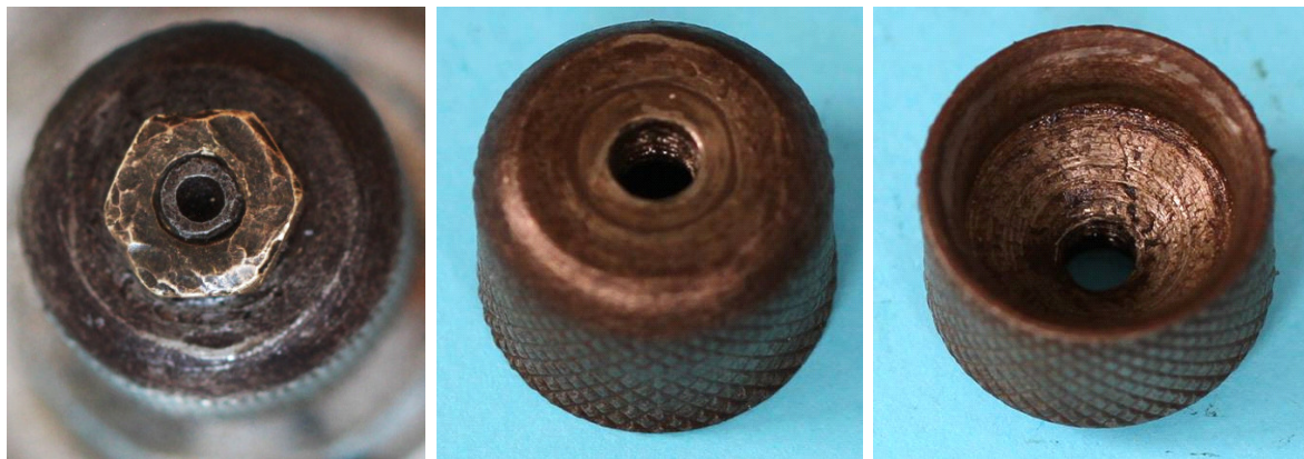
Bild 1.11: Reibrad: a) Reibrad mit Kontermutter auf der Welle, b) Reibrad mit Gewin- debohrung, c) Hohlraum im Reibrad zum Schutz des Kugellagers im Lagerhals
