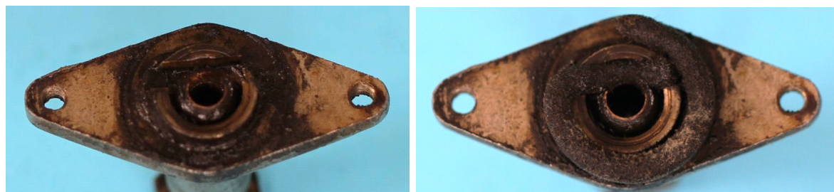
Bild 1.13: Spurlager: a) Ohne Öldepot, b) Mit Öldepot
