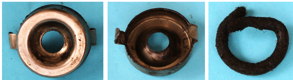
Bild 1.12: Öldepot: a) Schutzkappe außen, b) Innere Ansicht der Schutzkappe, c) Ölgetränktes Gewebe
