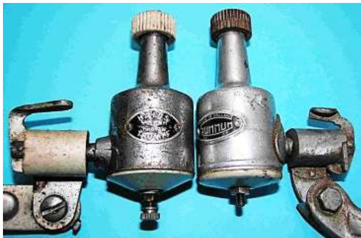
Bild 1.2: Gegenüberstellung zweier Blätterpol-Dynamos a) Halus, b) Summum
