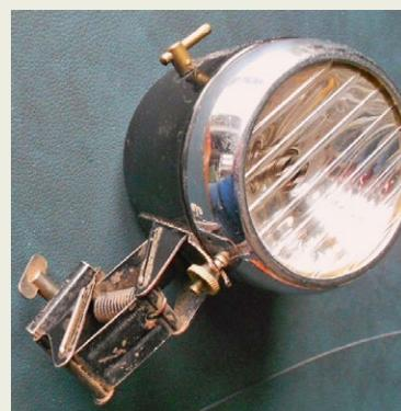
Biala 600, Batterie-Scheinwerfer, Durchmesser 9 cm, um 1935, unbenutzt mit Alterungsspuren, eine Kontaktlasche innen abgebrochen, aber vorhanden (anlötbare)
