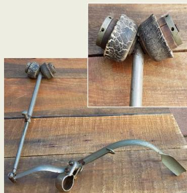
Vorderradbremasanlage, zur Schonung der teuren Reifen mit Rollen ausgestattet, typisch für die Zeit vor 1900, universell verwendbar
