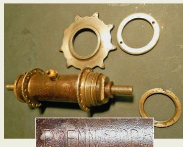
Brennabor Hinterradnabe, zwischen 1898 bis 1905, 36 Loch, Breite 120 mm, äußerer Zustand mäßig, läuft aber butterweich, mit Ritzel 1", 9 Zähne
