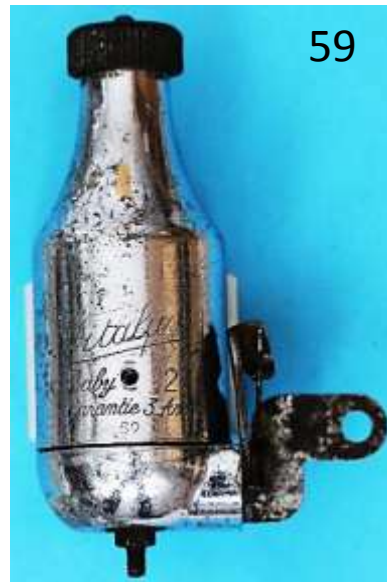
Bild 1.6: Dynamogeneration „Vitalux Baby“ a) Vitalux Baby 58 b) Vitalux Baby 59
