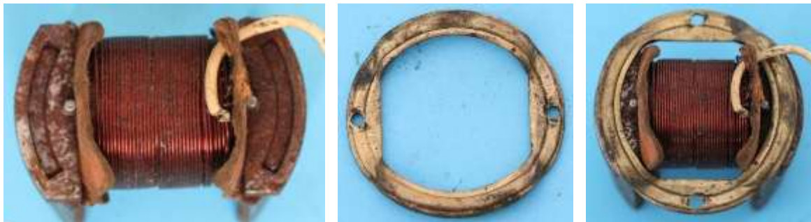
Bild 2.4: Ring zur Befestigung des Ankers: a) Unterseite des Ankers, b) Spannring, c) Position des Spannringes auf dem Anker
