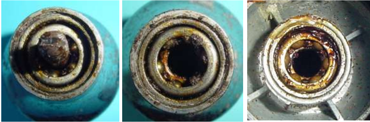
Bild 3.7: Lagerung: a) Welle mit Lager, b) Lager unter dem Reibrad, c) Unteres Lager
