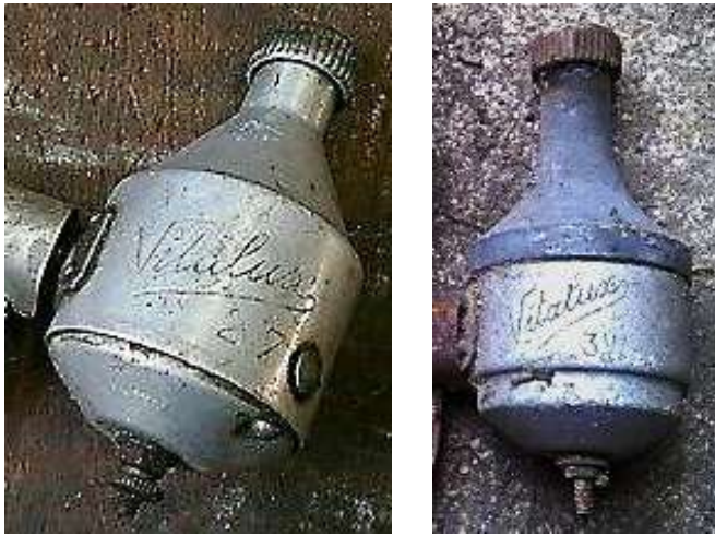
Bild 1.5: Gehäusevarianten der Marke Vitalux a) Vitalux 27 b) Vitalux 3 W
