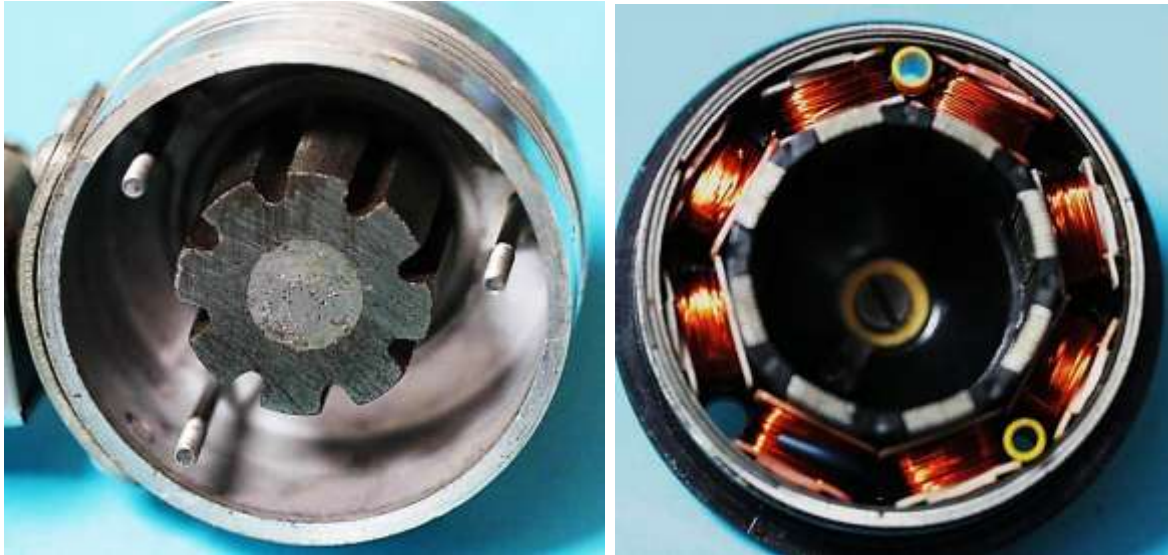
Bild 2.3: Generatorbaugruppen:a) Polrad aus AlNi-Magnetmaterial, b) 8 Polspulen auf ausgeprägten Polen
