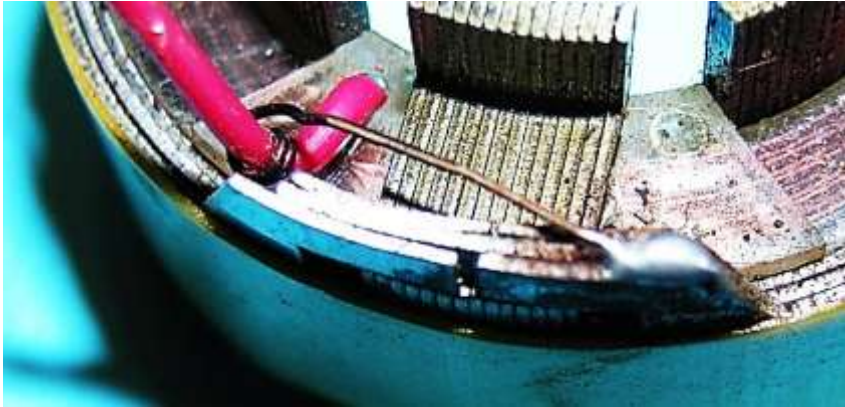
Bild 3.10: Masseanschluss der Ankerspule
