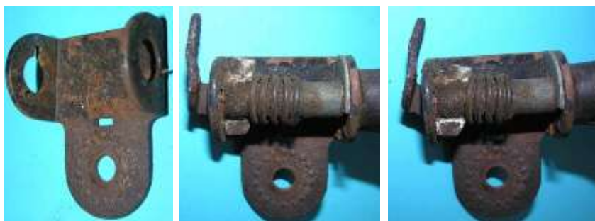
Bild 5.17: Kippvorrichtung: a) Basisblech, b) Raststellung, c) Betriebsstellung
