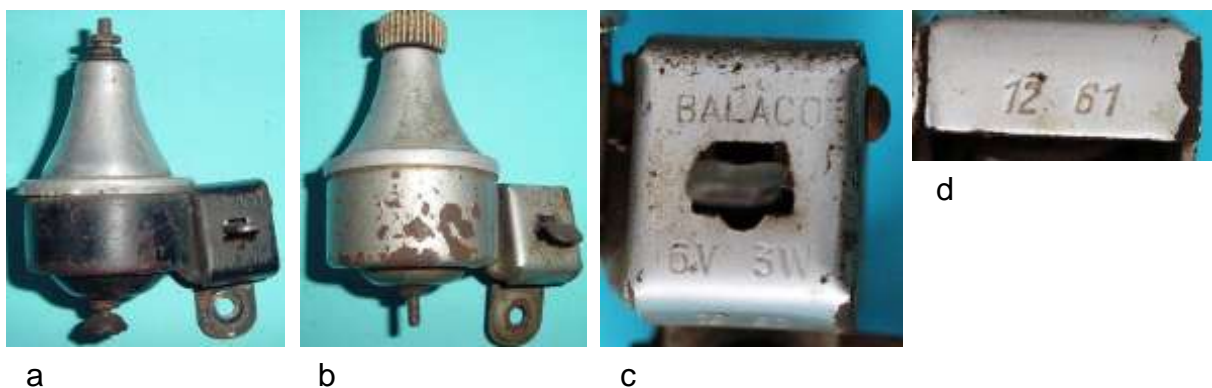
Bild 4.2: Balaco: a) Balaco 2,1 W, b) Balaco 3 W, c) Firmennamen und Nenndaten auf der Abdeckung der Kippvorrichtung, d) Fertigungsdatum von b)
