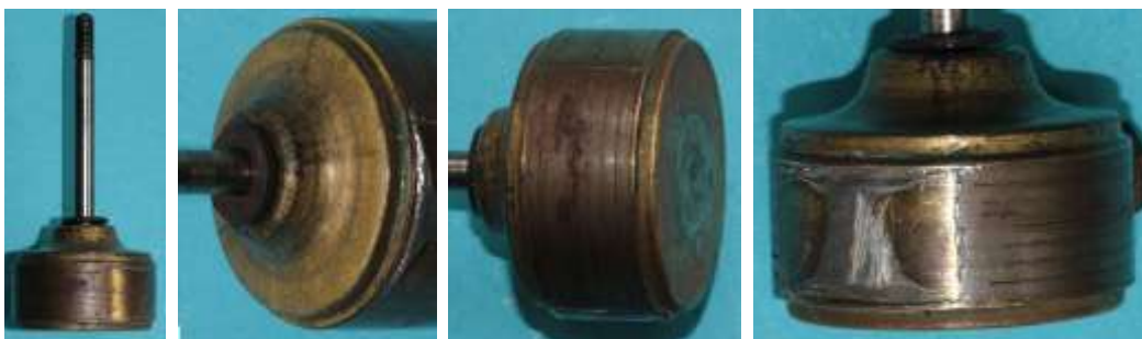
Bild 3.25: 7 Polschuhbleche 1,6 mm dick, Polraddurchmesser 31,3 mm
