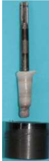
Bild 5.44: Lagervarianten: a) Sinterlager, b) Kunststofflager c) Verformung des Kunststoffes durch Erwärmung
