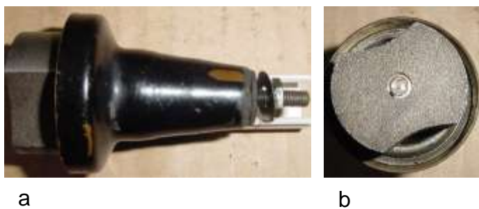
Bild 3.13: Lagerhals mit Polrad a) Seitenansicht b) Zweipoliger Walzenmagnet mit zurückgesetzten Pollücken
