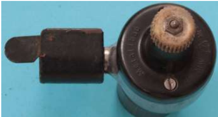
Bild 3.40: Blick auf das Reibrad und den Lagerhalsfuß
