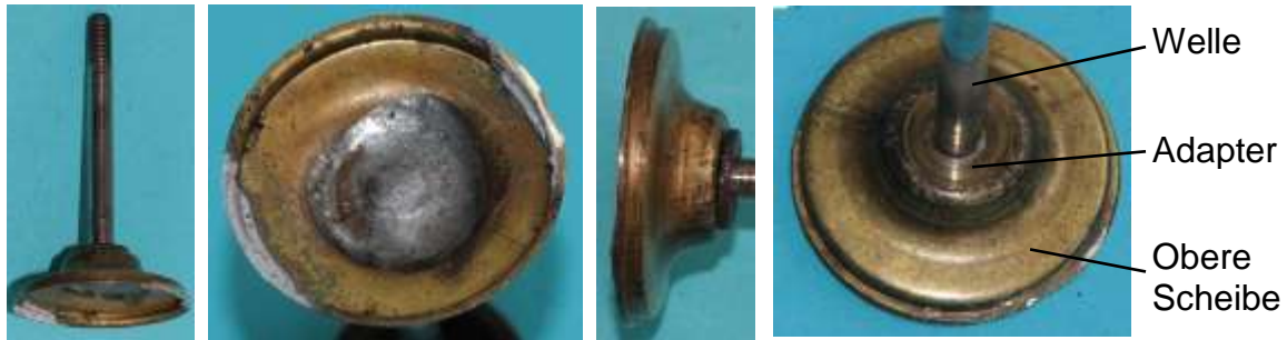
Bild 3.26: Welle mit oberer Scheibe verlötet
