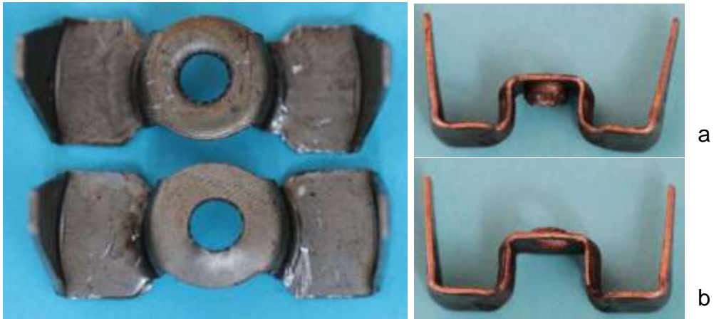
Bild 4.30: Zwei Bügel eines Klauenpolrings: a) Bügel mit dem Wellensitz, b) Innerer Bügel
