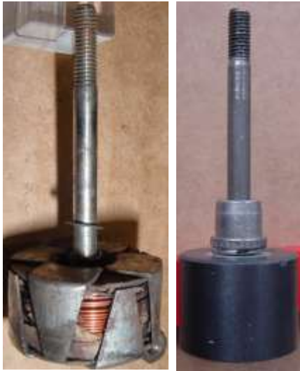
Bild 4.63: Ablösung des Läufers mit einem Klauenpolanker durch einen Läufer mit einer keramischen Magnetwalze
