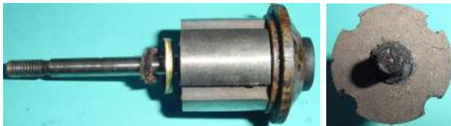
Bild 3.63: Vierpoliger AlNi-Magnet mit Welle
