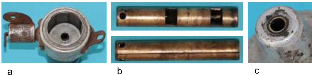
Bild 4.50: Lager: a) Sitz des Lagerrohrs im Lagerschild, b) Gerolltes Lagerrohr, c) Sitz des Lagerrohrs unter dem Reibrad
