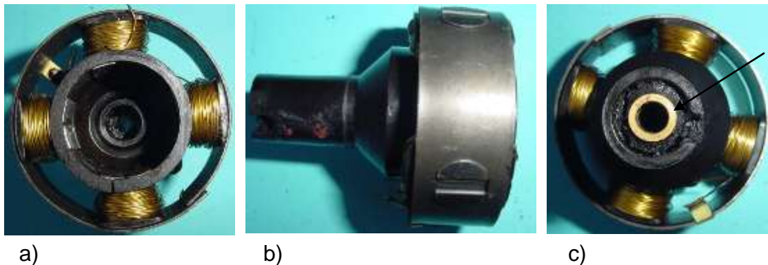
Bild 3.58: Anker: a) Ansicht des Ankers von der Bodenseite, b) Ankerjoch und innerer Lagerhals, c) Ansicht des Ankers von der Reibradseite mit oberem Gleitlager
