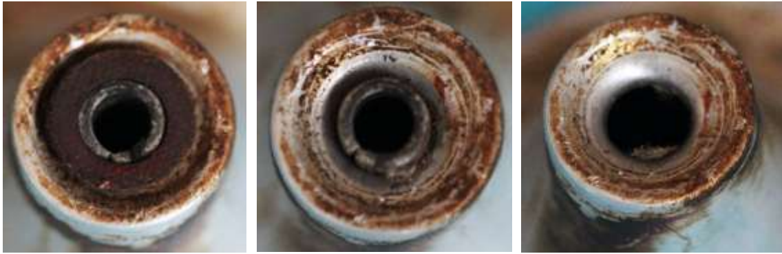
Bild 4.22: Lagerhalsmündung: a) Abdeckung des Schlitzes zwischen dem Lagerrohr und dem Lagerhals, b) Einpassung des Lagerrohres, c) Lagerhalsmündung
