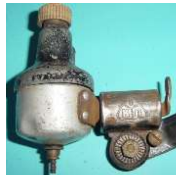
Bild 4.5: Ersatz kunststoffgebundener durch keramische Blockmagnete: a) Segmentring mit neun Magnetelementen, b) Dynamo mit vermutlich 8 Keramikmagneten, c) Ausführungsform IKA mit vier kunststoffgebundenen Blockmagneten
