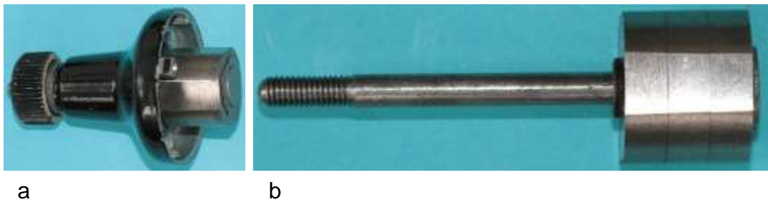
Bild 3.36: Erregersystem: a) Polrad mit Lagerhals und Reibrad, b) Vierpolig abgeflachte Magnetwalze
