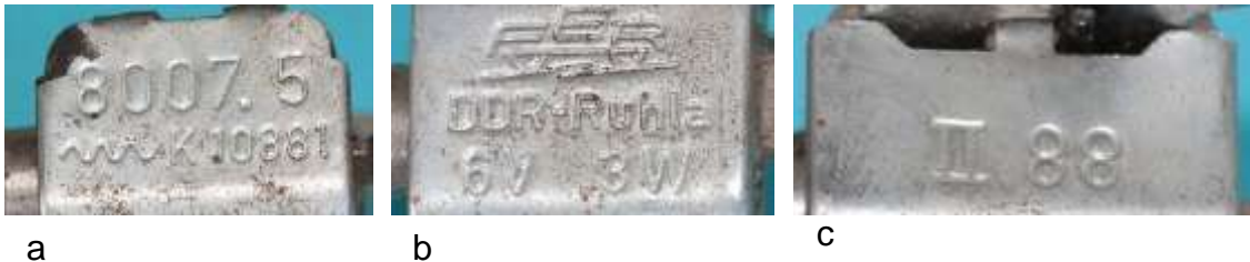
Bild 5.76: Dynamo-Lampen-Kombination 8007.5: a) Typenbezeichnung und Prüfnummer, b) Firmenlogo, Firmenstandort und Nenndaten, c) Fertigungsdatum
