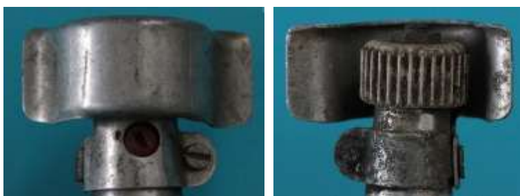
Bild 5.64: Spritzschutz a) Kunststoffschraube im Ölloch, b) Schellenbefestigung
