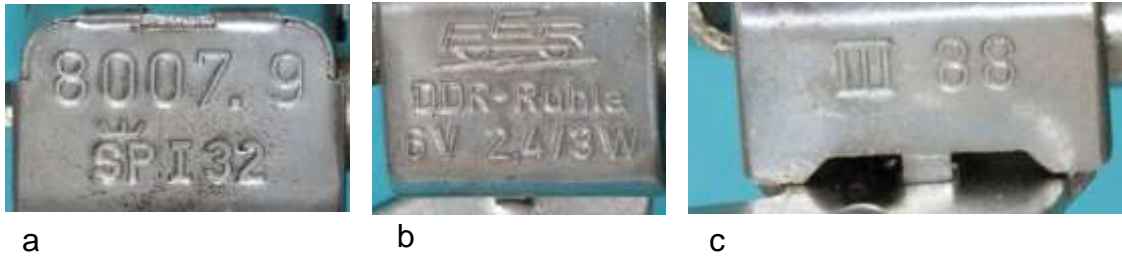
Bild 5.85: Beschriftungen auf der Abdeckung der Kippvorrichtung: a) Typennummer 8007.9, b) FER, DDR-Ruhla, 6 V 2,4/3 W3 W, c) Fertigungsdatum III 88
