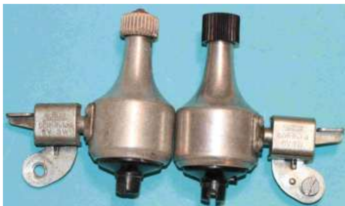
Bild 5.74: Der Unterschied aufeinanderfolgender Serien besteht in der Reibradausführung a) 8007.4 / 1985 b) 8007.5 / 1989
