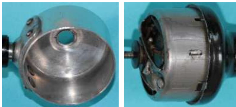
Bild 3.32: Dynamokonstruktion: a) Gehäusetopf, b) Ankerjoch
