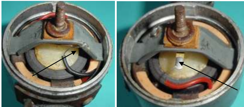
Bild 5.36: Spulenschlüsse: a) Masseanschluss, b) Spannung führender Anschluss
