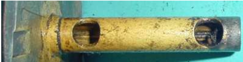
Bild 4.14: Gerollte Lagerhülse mit Ölöffnungen
