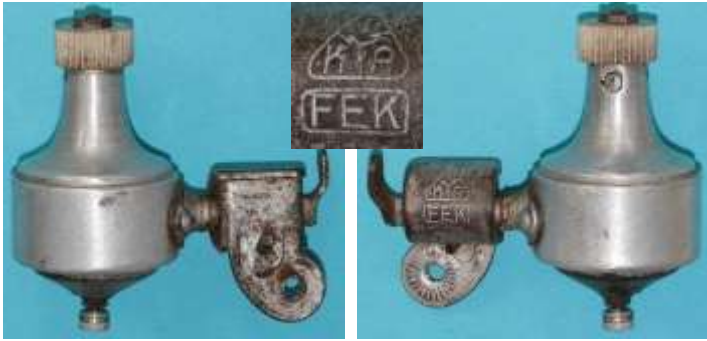
Bild 4.40: IKA-FEK mit nicht demontierbarem Boden
