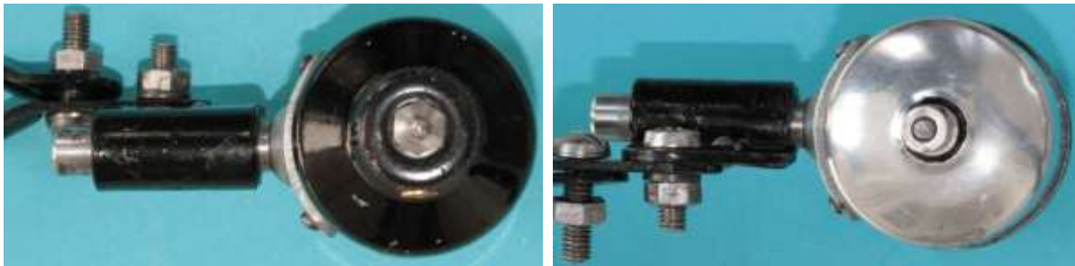
Bild 3.30: Gehäuseansichten: a) Lagerhals mit Reibrad, b) Boden mit Kabelanschlussbolzen
