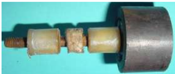
Bild 5.40: Polrad mit Kunststofflager: a) Trocken gelaufenes Lager mit trockenem Fettdepot in der Mitte, b) Polrad mit Reibrad
