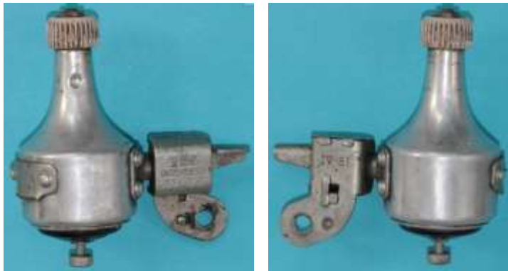
Bild 5.66: Dynamo-Lampen-Kombination mit der Typennummer 8007.8 und dem Fertigungsdatum IV 81
