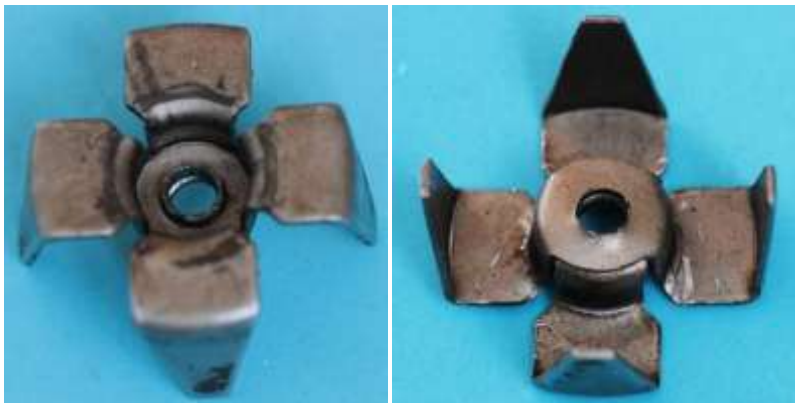
Bild 4.29: Klauenpolkranz: a) Stirnseite, b) Wickelraum
