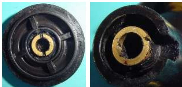
Bild 3.64: Gleitlager: a) Unteres Gleitlager im Lagerschild, b) oberes Gleitlager im inneren Lagerhals
