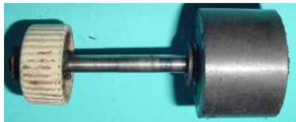
Bild 5.40: Polrad mit Kunststofflager: a) Trocken gelaufenes Lager mit trockenem Fettdepot in der Mitte, b) Polrad mit Reibrad
