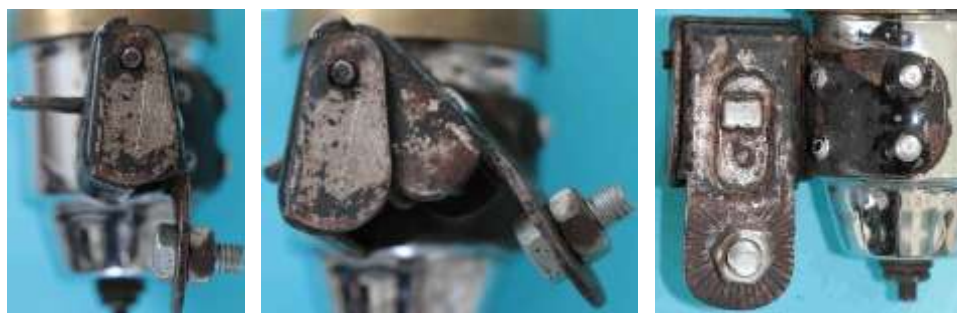
Bild 3.6: Kippvorrichtung: a) Ruhestellung, b) Betriebsstellung, c) Halterarm und Flanschbefestigung
