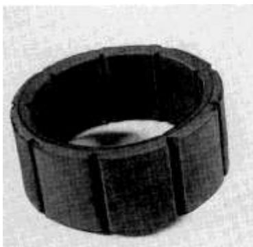
Bild 4.5: Ersatz kunststoffgebundener durch keramische Blockmagnete: a) Segmentring mit neun Magnetelementen, b) Dynamo mit vermutlich 8 Keramikmagneten, c) Ausführungsform IKA mit vier kunststoffgebundenen Blockmagneten
