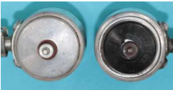
Bild 5.54: Veränderung des Bodenmaterials bei anderer Montagetechnologie bei gleicher Typenkennzeichnung
