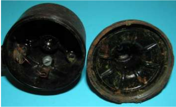
Bild 5.2: Gehäusekopf und Lagerhals aus gefülltem Duroplast
