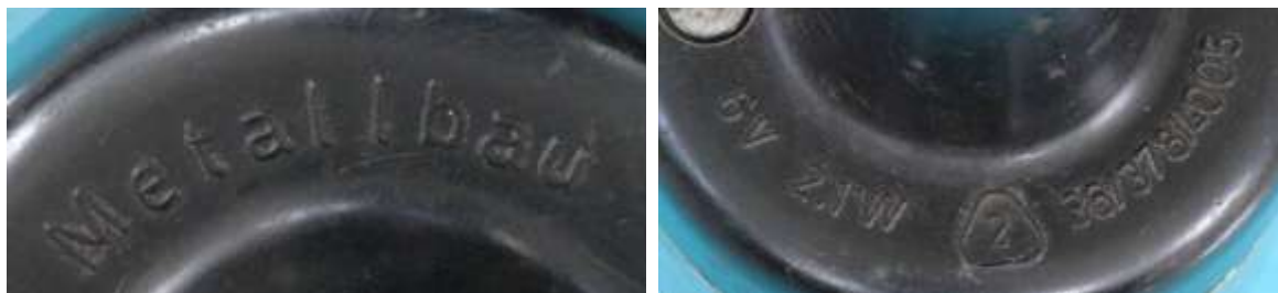
Bild 3.41: Beschriftung des Lagerhalses: a) Firmenname: Metallbau, b) Nenndaten: 6 V; 2,1 W, Gütezeichen 2, Betriebsnummer: 36/378/4005
