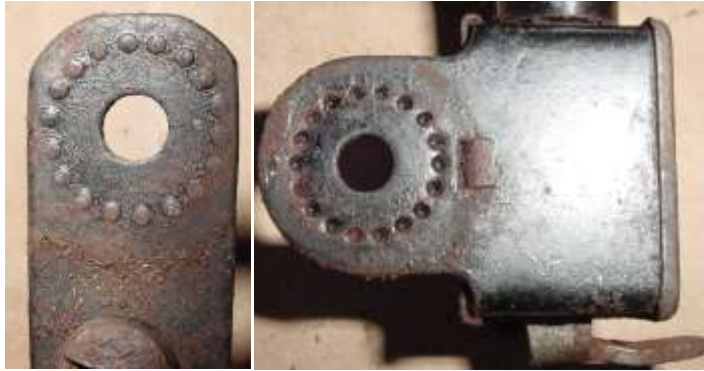
Bild 5.11: Nuten und Nocken zur Verzahnung im Haltergelenk
