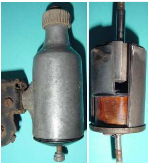
Bild 3.48: Metallbau 6 V, 2,1 W 36 / 1204 / 4005 a) Gehäuse b) Lagerhalstopf und Boden entfernt
