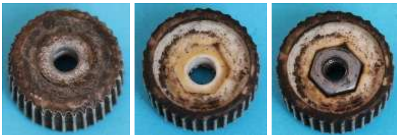
Bild 4.23: Keramikreibrad: a) Oberseite, b) Kontur für die untere Kontermutter, c) Eingelegte Kontermutter
