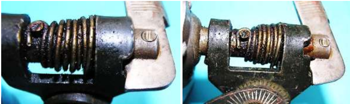
Bild 2.15: Zwei Stellungen des Fußhebels mit Einrastnut (L104.2)
