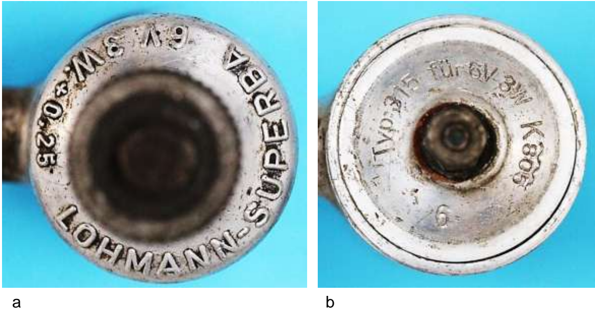
Bild 7.9: Beschriftungen: a) Typ Superba: Auf dem Lagerhalsfuß, b) Typ 315: Am Boden,
