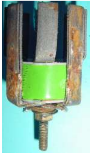
Bild 7.19: Anker: a) Ankereisen und Spule b) Einschieben des Ankers in den Lagerhalstopf
