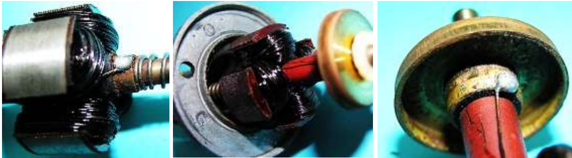
Bild 2.21: Kontaktierung: a) Masseverbindung zur Welle, b) Kontakteller mit Lötstelle, c) Schleifbahn der Kohlebürste
