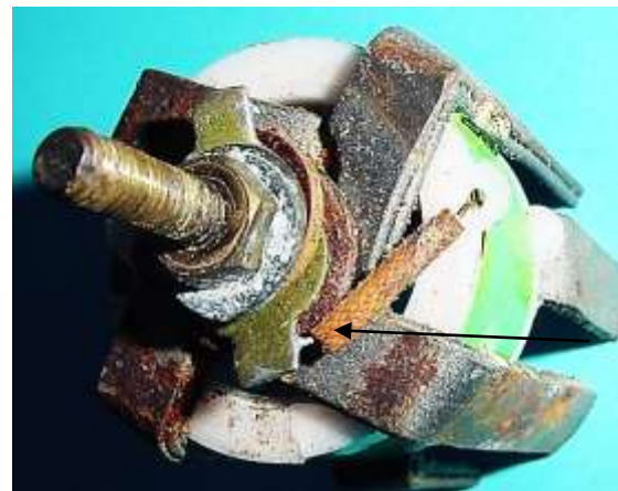
Bild 7.21: Spulenanschlüsse: a) Spannung führender Anschluss, b) Massekontakt
