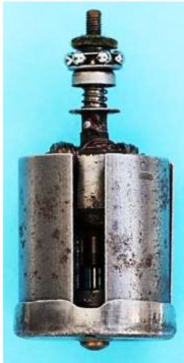
Bild 3.13: Magnetsystem: a) Am Lagerhals angeschraubtes Erregersystem b) Magnetstäbe mit Läufer
