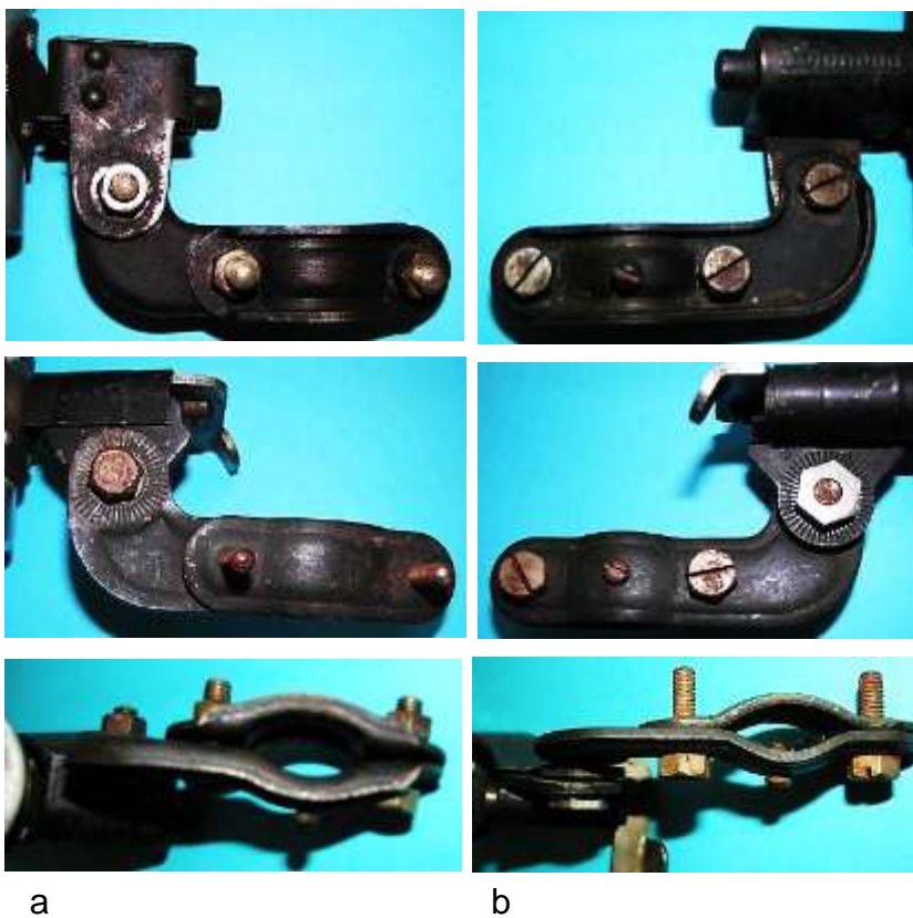
Bild 2.11: Vergleich der Halter: a) Verstärkter Halter bei der älteren Ausführung ohne Ausrasthebel, b) Ausführung mit Ausrasthebel und schwächerem Halter
