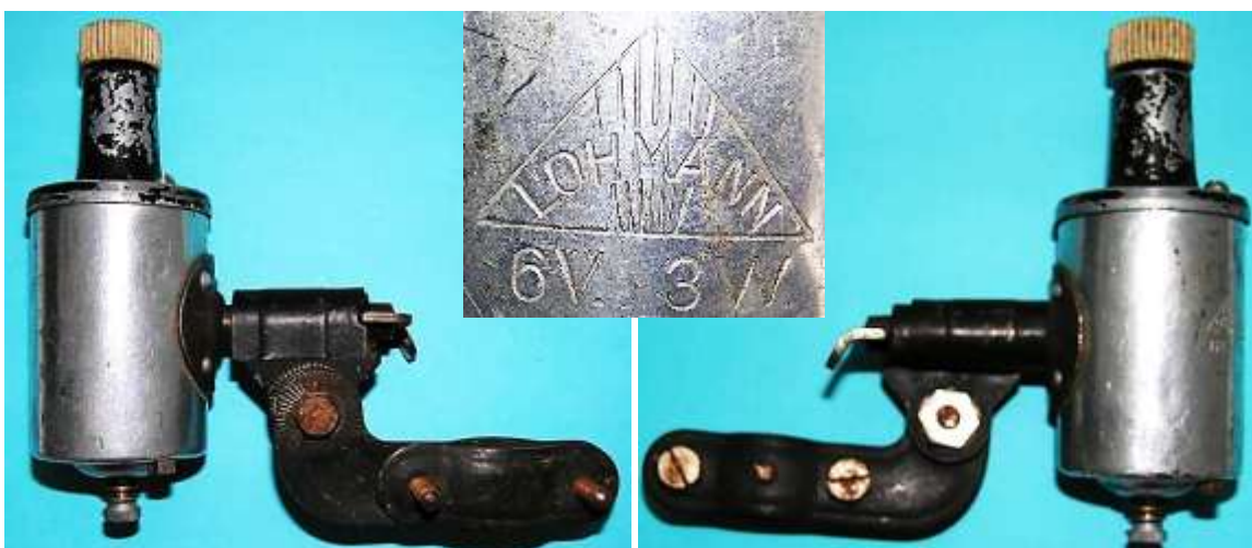
Bild 2.4: Lohmann L104.2 mit einem Lagerhals aus Spritzguss und dem Firmenlogo auf dem Gehäusemantel
