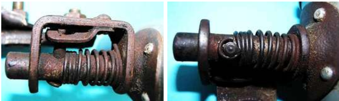
Bild 2.14: Angenietetes Einrastblech mit Sperrstift (L104.1)
