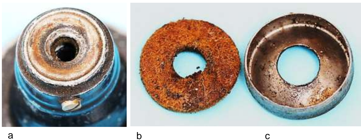
Bild 4.7: Öldepot: a) abgedecktes Lager, b) Filzring, c) Schutzkappe
