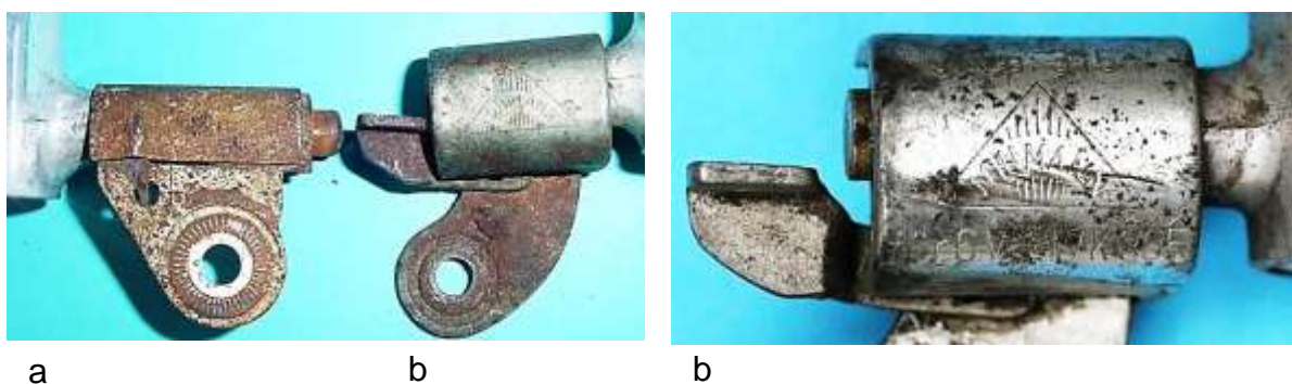
Bild 7.11: Veränderung der Kippvorrichtung innerhalb der Serie: a) Verschiebebolzen Kippvorrichtung, b) Pedalanordnung ohne Verschiebung des Drehbolzens
