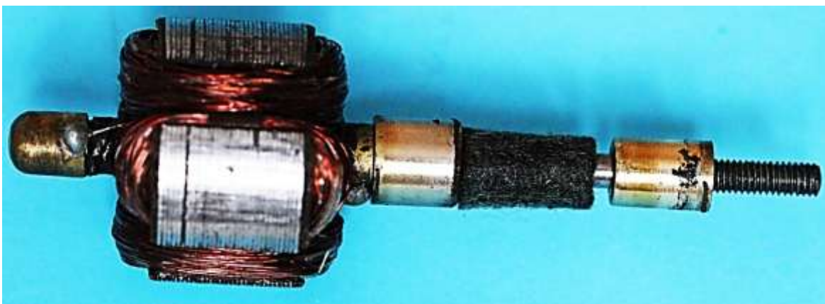
Bild 5.2: Zwei Gleitlagern mit unterschiedlichen Außendurchmessern auf der Welle
