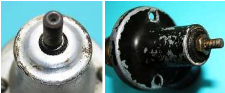
Bild 2.9: Wellenenden: a) für Gusseisernes Reibrad, b) für Keramikreibrad
