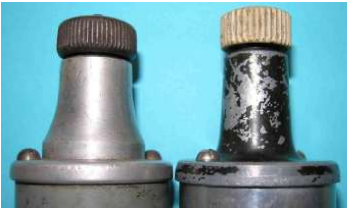
Bild 2.6: Lagerhalsausführungen: a) L104.1 aus Aluminiumblech, b) L104.2 aus Spritzguss
