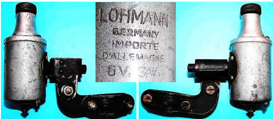
Bild 2.3: Lohmann L104.1 mit eingepprägten Daten im Gehäusemantel
