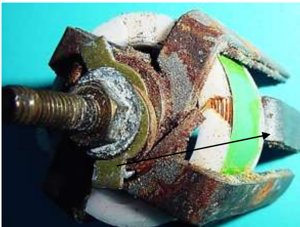
Bild 7.21: Spulenanschlüsse: a) Spannung führender Anschluss, b) Massekontakt
