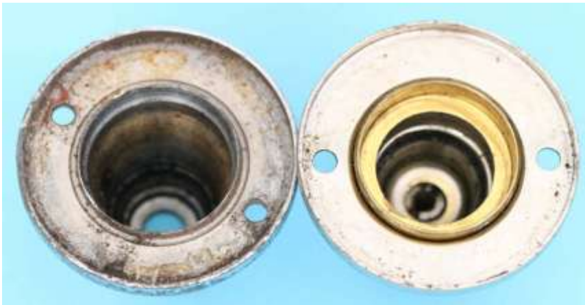
Bild 3.11: Gestaltung der Justierringe: a) E13a, b) E13 und Miele,
