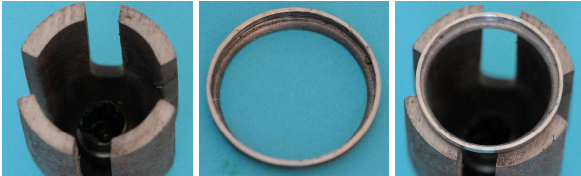
Bild 1.45: Zentrierung des Magneten: a) Stirnflächen des Magneten, b) Magnet mit Zentrierring, Lagerhals mit Zentrierring
