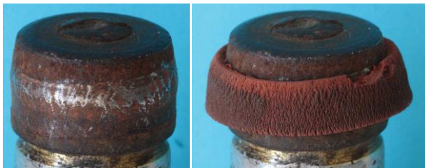
Bild 1.19: Reibrad: a) Leicht gewölbte Oberfläche ohne erkennbare Struktur, b) Gummiring zur Vergrößerung der Rollreibung
