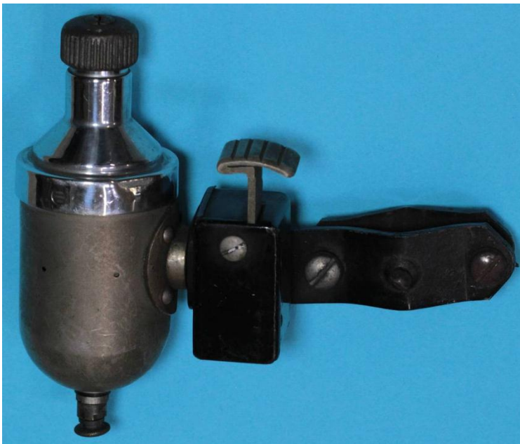
Bild 1.12: Kippvorrichtung, die durch identische Bedienung des Fußpedals sowohl die Ruhestellung als auch die Betriebsstellung auslöst
