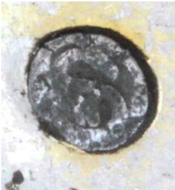
Bild 1.18: Bleisiegel in der Bohrung des Gewinderings vom Lagerhals
