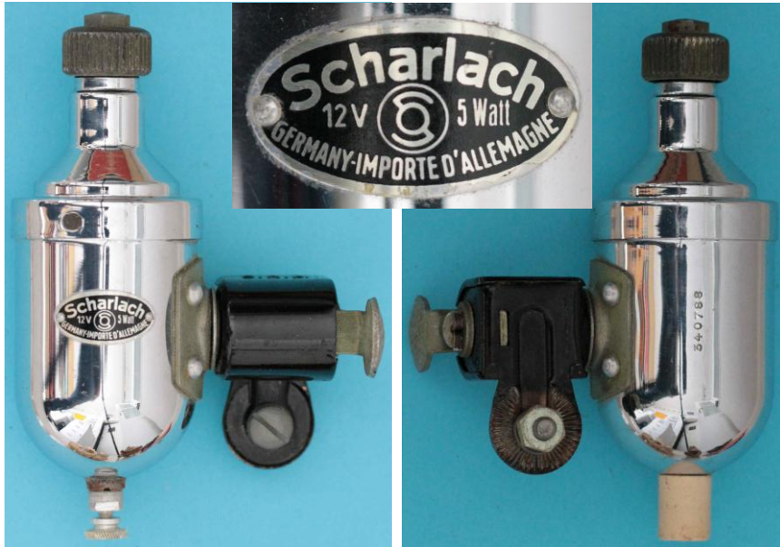
Bild 1.30: Fertigungsnummer 340788 mit den Nenndaten 12 V und 5 W
