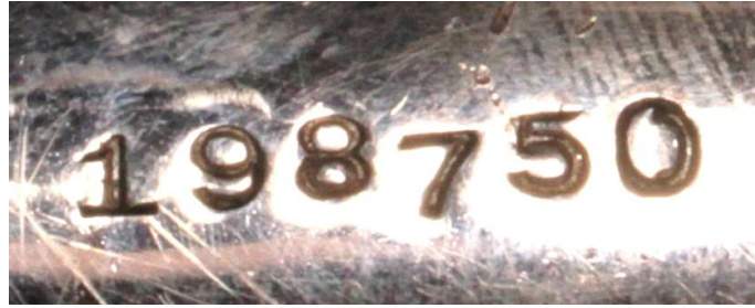
Bild 1.4: Beschriftungen: a) Eingepprägter Firmenname im Gehäusemantel, b) Fertigungsnummer 198750
