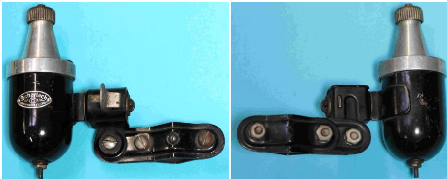
Bild 1.78: Dynamo mit einem Gehäusetopf aus Eisenblech
