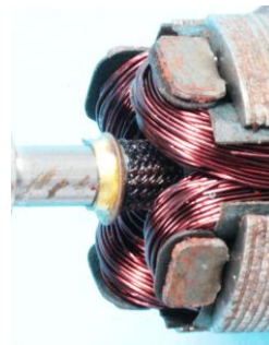
Bild 1.57: Abgewinkelte Stirnbleche zur Fixierung der Wicklungsköpfe
