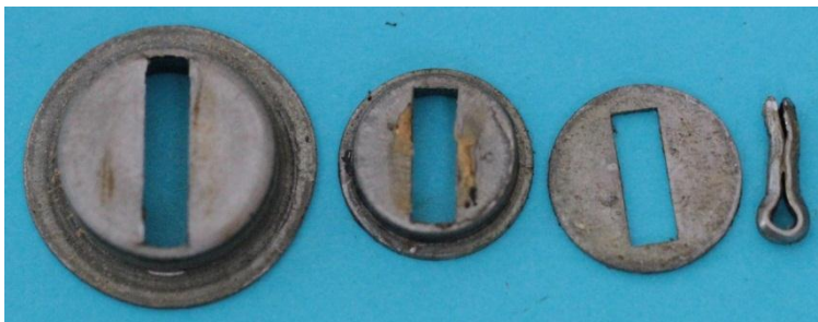
Bild 1.35: Einzelteile: a) Gleitlagerscheibe am Flansch, b) Gleitlagerscheibe am Ende des Drehbolzens, c) Unterlegscheibe, d) Splint
