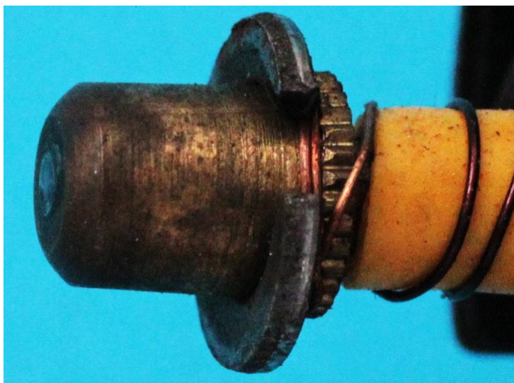
Bild 1.73: Klemmverbindung statt Lötstelle in den Dynamos ab Nummer 706771 oder früher
