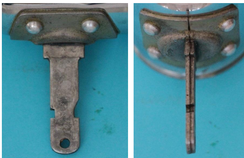
Bild 1.33: Flansch und Drehbolzen: a) Seitenansicht, b) Zweiteilung des Bauteils
