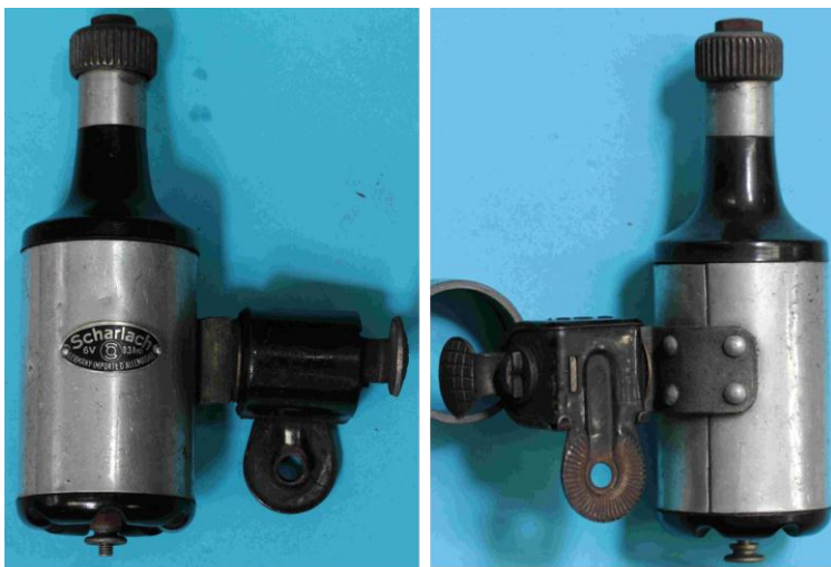
Bild 1.92: Gehäuse aus einem gefalzten Blech, einem Boden aus Kunststoff und einem Lagerhals aus Kunststoff
