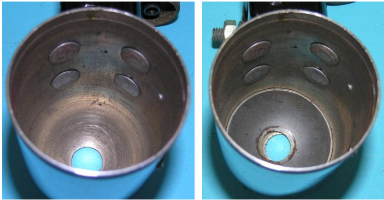
Bild 1.34: Gehäusetopf: a) Innere Nietköpfe, b) Eingelegtes Blech??????
