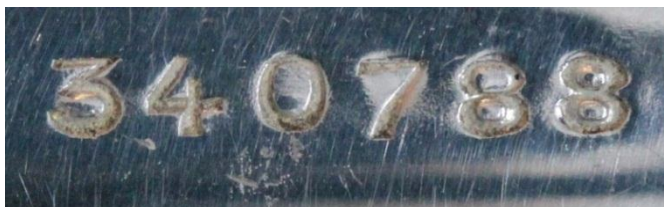
Bild 1.29: Auf dem Gehäusemantel eingeprägte Fertigungsnummer
