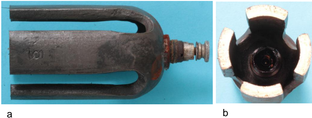
Bild 1.20: Vierpoliges Erregersystem: a) Seitenansicht mit eingeprägtem Firmenlogo des Dynamoherstellers Otto Scharlach, b) Stirnseiten der Pole
