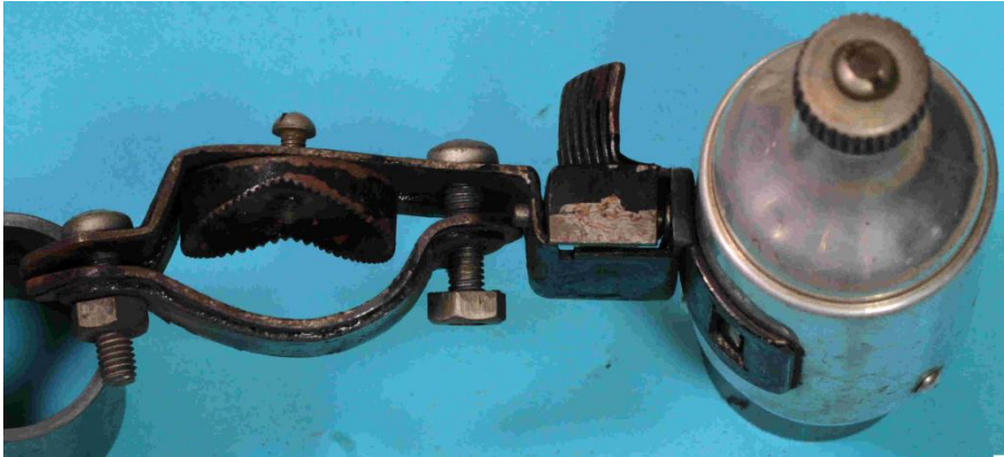
Bild 1.85: Halteblech und geknickte Krallenscheibe
