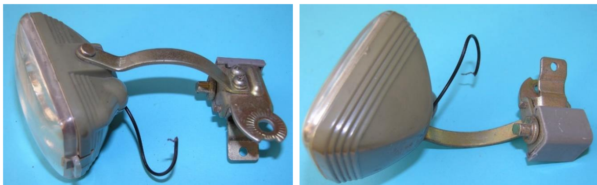
Bild 1.23: Lampenbügel zur konstruktiven Verbindung der Lampe mit der Kippvorrichtung
