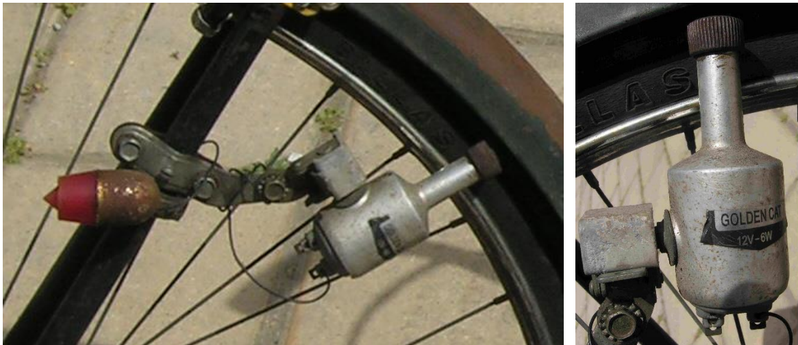
Bild 1.20: GOLDENCAT-Seitendynamo am Hinterrad, 12 V, 6 W
