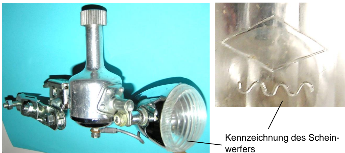
Bild 1.3: Typ 5501: Registriernummer K 815, Anmeldung: 01.07.1955, Abmeldung am 04.06.1964, Fertigungsnummer: 1765725, Gewicht 326 g
