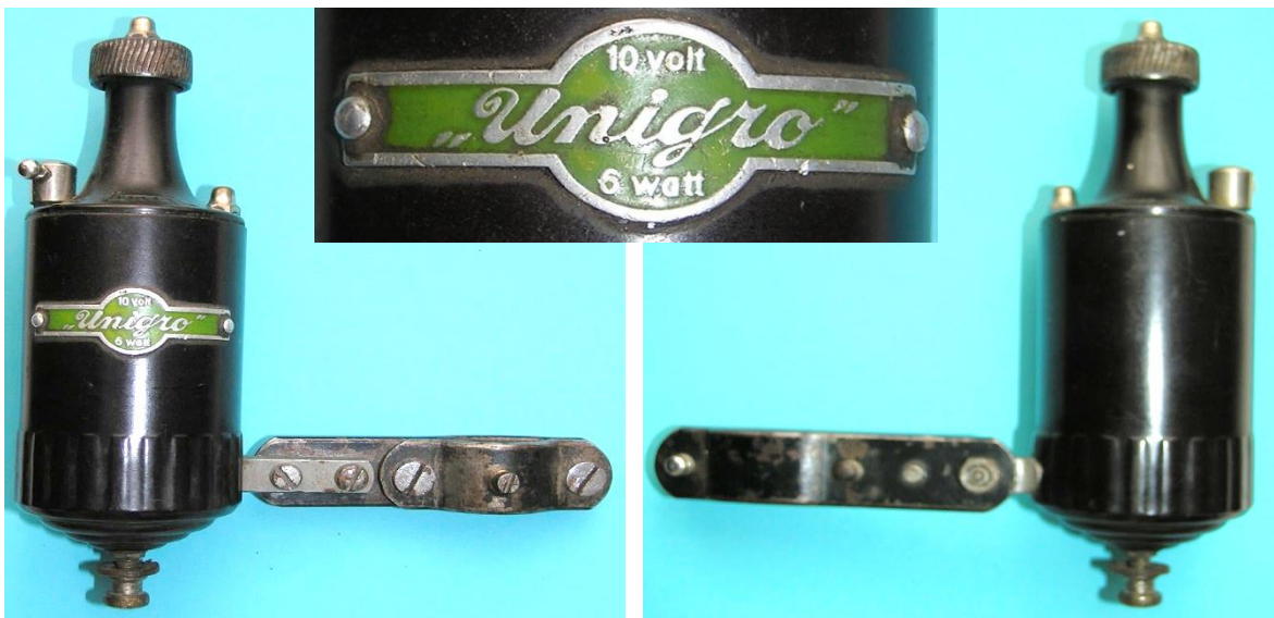
Bild 2.1: Unigro: 10 V, 6 W, Gewicht: 540 g; 640 g mit Halter
