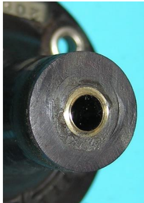
Bild 2.26: Lagerung des Läufers im Gleitlagerrohr: a) Lagerhals mit Läufer, b) Stirnseite unter dem Reibrad, c) Ölschlitz im Rohr
