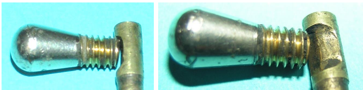
Bild 2.10: Eingriff des Knaufs in die Mulde des Entriegelungsstabs
