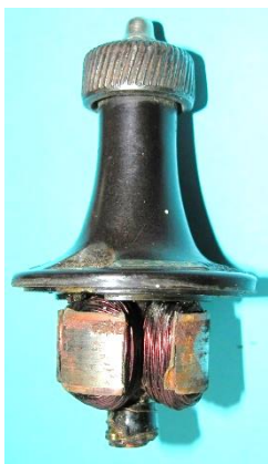
Bild 2.26: Lagerung des Läufers im Gleitlagerrohr: a) Lagerhals mit Läufer, b) Stirnseite unter dem Reibrad, c) Ölschlitz im Rohr
