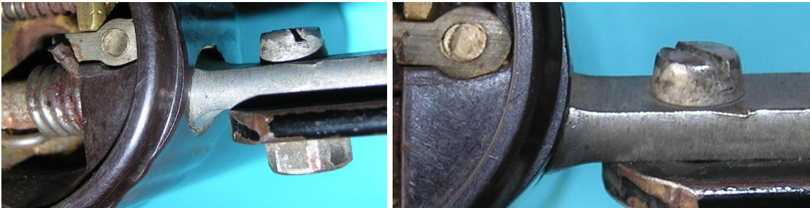
Bild 2.17: Positionierung der Stützzunge und Verdrehung des Drehbolzens: a) Ruhestellung, b) Betriebsstellung
