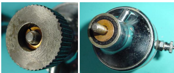
Bild 1.51: Reibrad und Ankerwelle mit Gewinde
