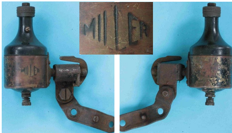
Bild 1.34: Lagerhals aus Duroplast
