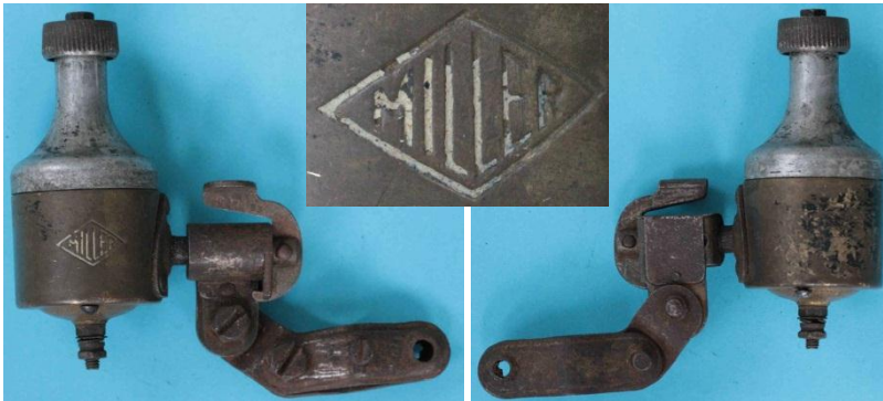
Bild 1.28: Dynamo mit dreieckförmigem Flansch
