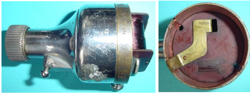
Bild 1.54: Verteilung der Baugruppen: a) Anker im Lagerhals-topf, b) Kontaktbahn im Bodentopf
