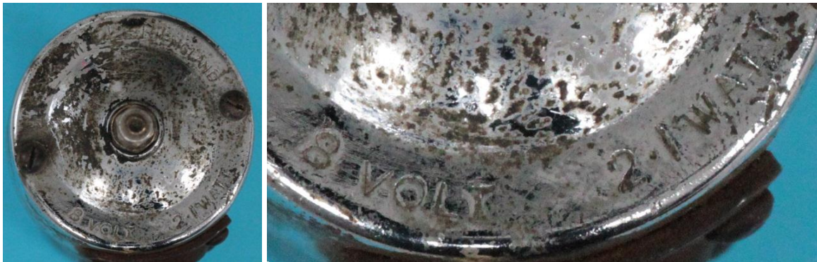
Bild 1.39: Beschriftung des Bodens mit den Nenndaten 8 V und 2,1 W
