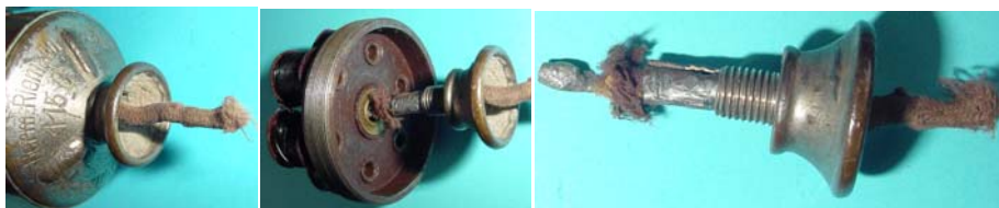
Bild 1.11: Durchführung des Spannung führenden Kontaktes durch das Ankerjoch und den Gehäuseboden
