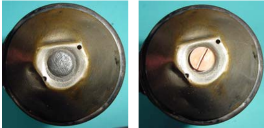
Bild 1.16: Befestigung des Bodens mit einer versiegelten Schlitzschraube
