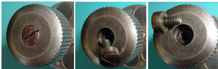
Bild 1.15: Befestigung des Reibrades
