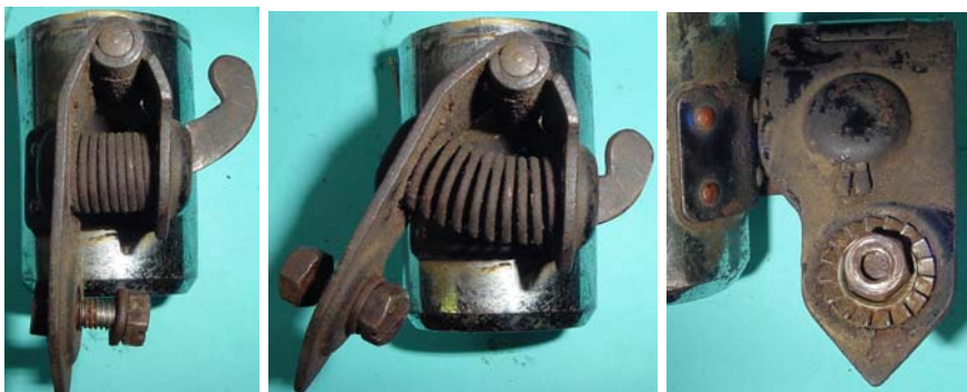
Bild 1.20: Ausgeführte Kippvorrichtung entsprechend Patent Nr. 590794
