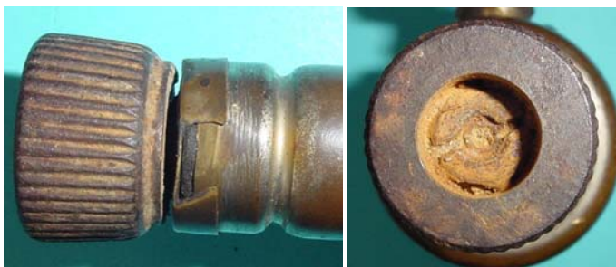
Bild 1.6: Ausführung und Befestigung des Reibrades
