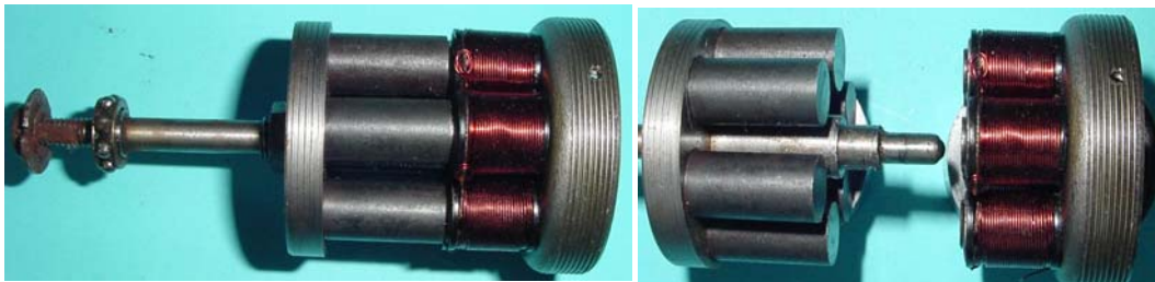
Bild 1.53: Magnetischer Kreis mit Welle
