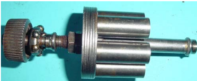
Bild 1.22: Läufer mit oberem Kugellager und Lagersitz für das untere Lager
