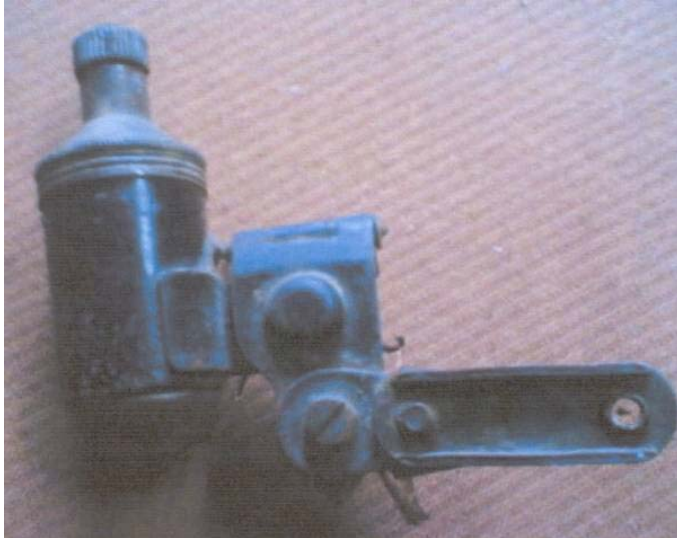
Bild 1.21: Säulenmagnetdynamo mit patentierter Kippvorrichtung (Internetfoto))
