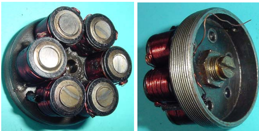
Bild 1.57: Befestigung der Spulenkerne im Joch mit durch Nietung
