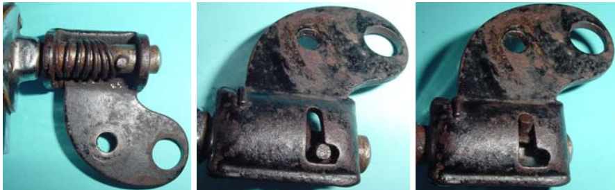
Bild 1.42: Kippvorrichtung mit einer Schraubenfeder
