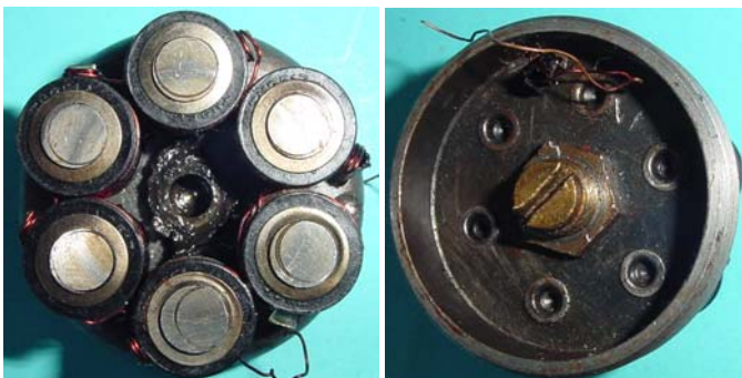
Bild 1.55: Spurlager mit Justierschlitz und Kontermutter
