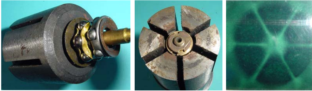
Bild 1.7: Einteiliges Magnetsystem mit sechs Polen
