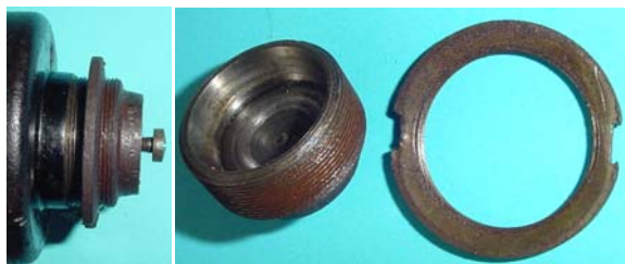
Bild 1.24: Unteres Lagerschild mit Befestigungsschraube des Bodens und der Kontermutter
