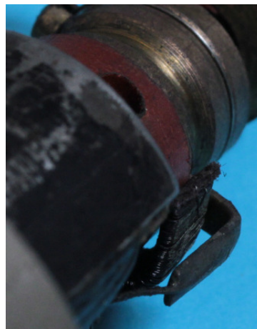
Bild 1.6: Kontakte des Fliehkraftreglers: a) Montage des Widerstands auf einem Isolierkörper, b) Spannung führender Kontakt
