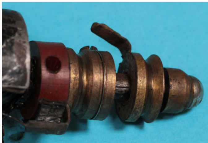
Bild 1.6: Kontakte des Fliehkraftreglers: a) Montage des Widerstands auf einem Isolierkörper, b) Spannung führender Kontakt
