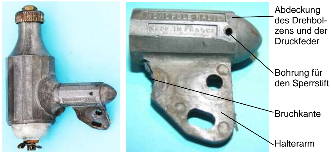
Bild 3: Bruchkante am Halterarm der Kippvorrichtung: a) Dynamoansicht, b) Vereintes Gussteil der Abdeckung der Kippvorrichtung und des Halterarms
