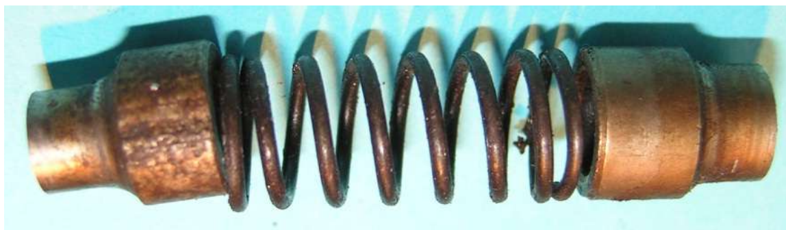
Bild 17: Schraubenfeder zwischen den Konen
