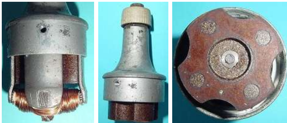
Bild 4.4: Anker mit Polrad
