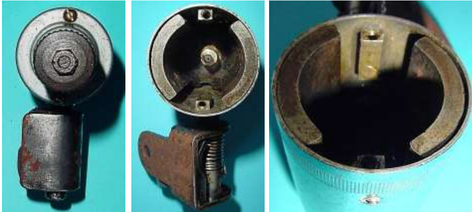
Bild 3.3: Verschraubung des Lagerhalses am Gehäusemantel: a) Schlitzkopfschrauben am Lagerhalsfuß, b) Gewindestücke am Gehäusemantel, c) Nietköpfe der Gewindestücke im und außerhalb des Gehäuses
