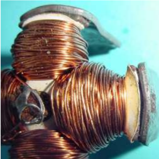
Bild 4.6: Isolation des Blechpakets
