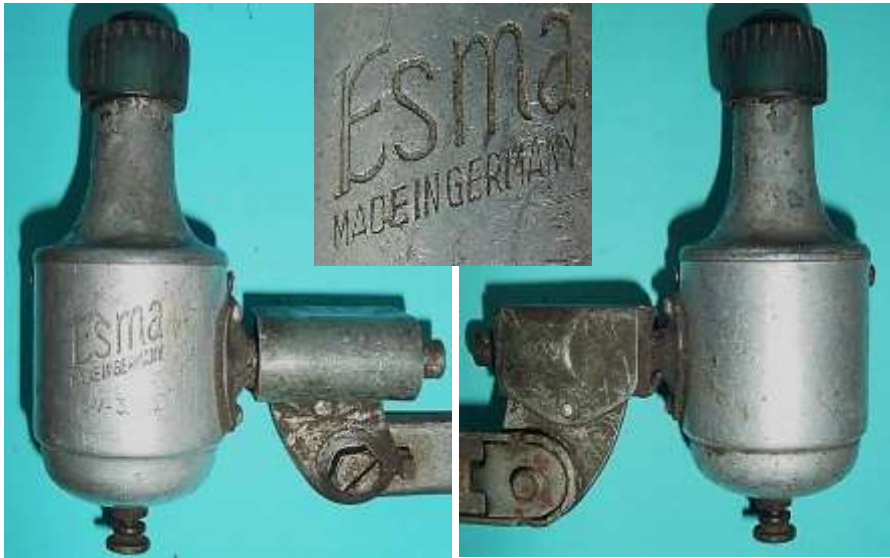
Bild 4.1: Blätterpol-Dynamo „ESMA 3“, 6 V, 3,5 W
