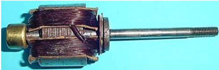
Bild 3.9: Welle mit vollständigem Anker
