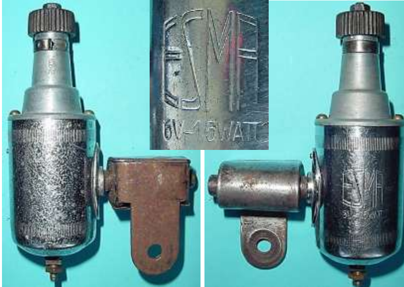
Bild 3.1: Beide Ansichten des Dynamos mit der Typenbezeichnung „ESMA“ für 6 V und 1,5W
