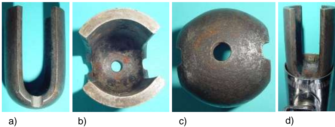
Bild 3.6: Tulpenmagnet mit technologisch bedingten Nuten im Joch: a) Zweipoliger Tulpenmagnet, b) Bohrungsansicht, c) Jochansicht, d) Einpassung des Magneten in das Gehäuse
