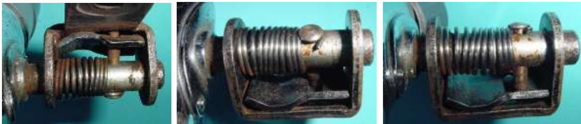
Bild 3.5: Kippvorrichtung ohne Abdeckung aus unterschiedlichen Blickrichtungen
