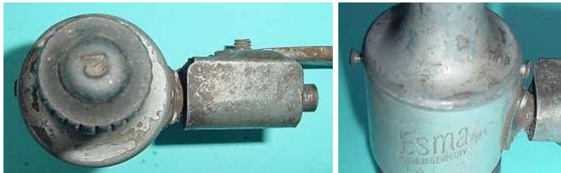
Bild 4.2: Befestigung des Lagerhalses am Gehäusetopf mit zwei Schrauben
