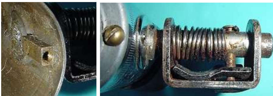
Bild 3.2: Befestigung des Flansches am Gehäuse: a) Hohlriet unterhalb des Gewindestücks, b) Schlitzkopfschraube am Lagerhalsfuß
