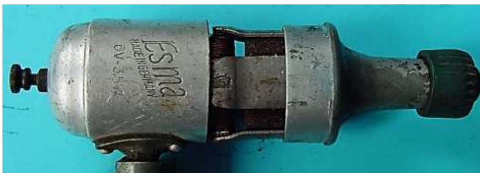
Bild 4.5: Anker aus dem Gehäusetopf geschoben
