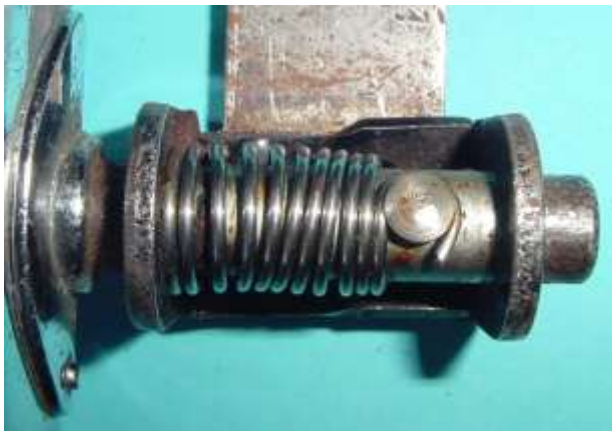
Bild 3.4: Befestigung der Feder am Arretierungsstift
