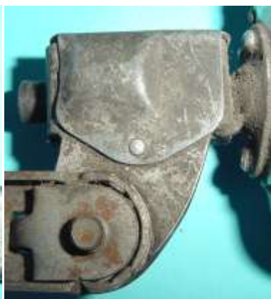
Bild 4.11: Vernietete Abdeckung der Kippvorrichtung
