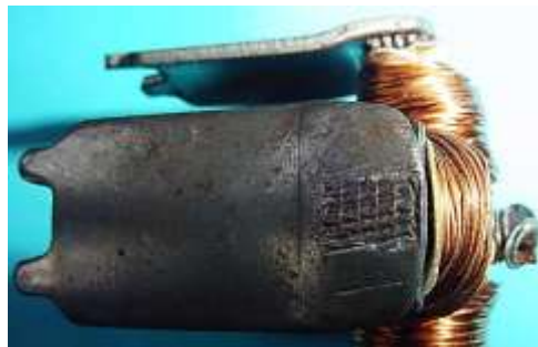
Bild 4.8: Verknüpfung der Polbleche mit dem geblechten Spulenkern
