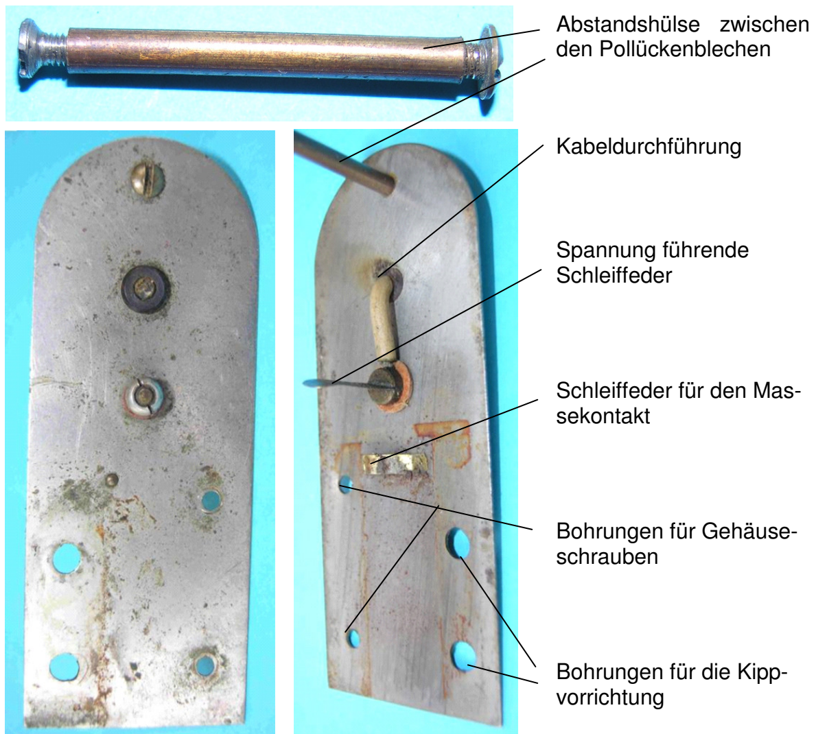
Bild 1.4: Abdeckung der hinteren Pollücke mit Funktionselementen
