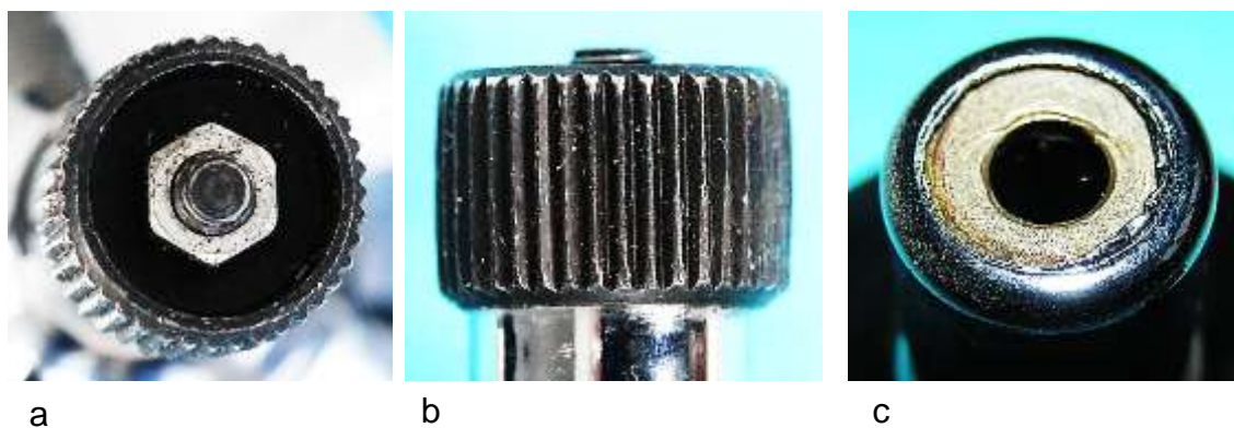
Bild 14: Stahlgussreibrad: a) Versenkte Kontermutter, b) Lauffläche, c) Vom Reibrad abgedeckte Stirnfläche des Gleitlagers
