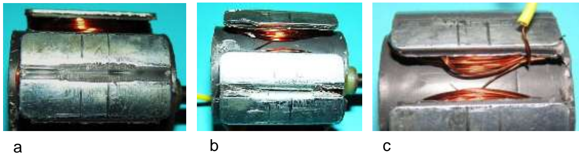
Bild 10: Polschuhflächen: a) Mit Kunststoff ausgefüllte Kerbe in der Polmitte, b) Vom Kunststoff gereinigte Kerbe, c) Ohne Drahtunterbrechung gewickelte Spulen
