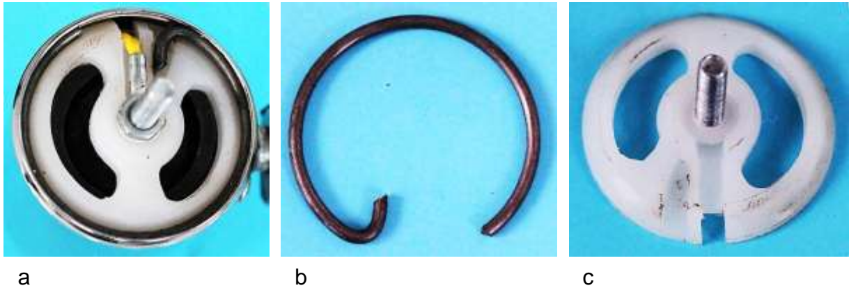
Bild 5: Kabelanschlussbolzen: a) Geschlossener Kabelschuh am Spannung führenden Wicklungsende, b) Federring, c) Im Kunststoffsteg eingesetzter Kabelanschlussbolzen
