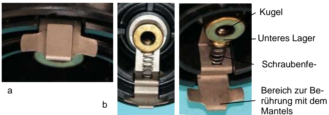
Bild 1.12: Massekontakt: a) Kontaktfläche am Gehäusemantel, b) Schraubenfeder und Kugel zur gleitenden Kontaktierung mit der Welle
