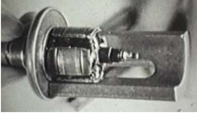
Bild 2.13: Letzte Arbeitsgänge: a) Einsetzen der Polpaarsegmente, b) Endprüfung
