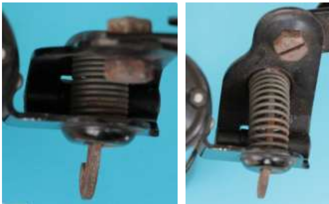
Bild 1.4: BERKO-Kippvorrichtung: a) Ruhestellung b) Betriebsstellung
