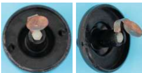
Bild 1.6: Spannung führende Blattfeder auf der Innenseite des Bodens
