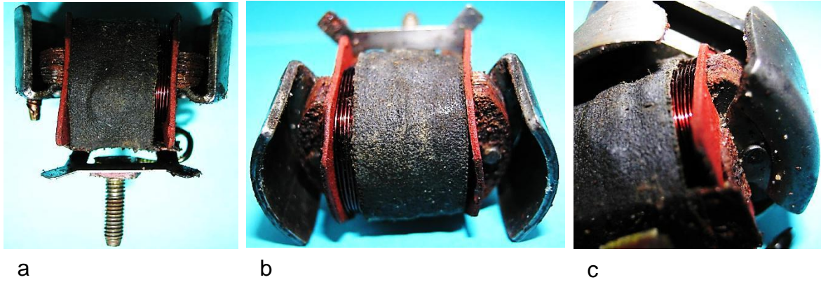
Bild 5.60: Positionierung der Polradpolschuhe zwischen den Ankerpolflächen
