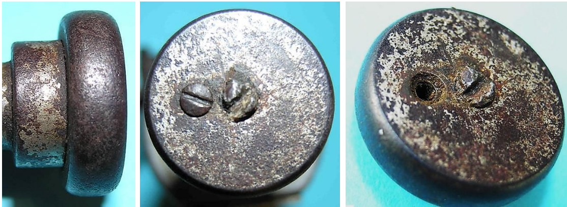
Bild 3.54: Reibrad: a) Lauffläche des Reibrads und Lagerschale, b) Reibrad mit Konterschraube und Ölkanalverschluss, c) Offener Ölkanal
