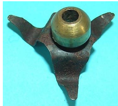
Bild 4.33: Lagerung des Polrades
