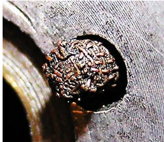
Bild 3.106: Massekontakt: a) Lagerhalsfuß mit Justierrand, b) Kupfergewebebürste
