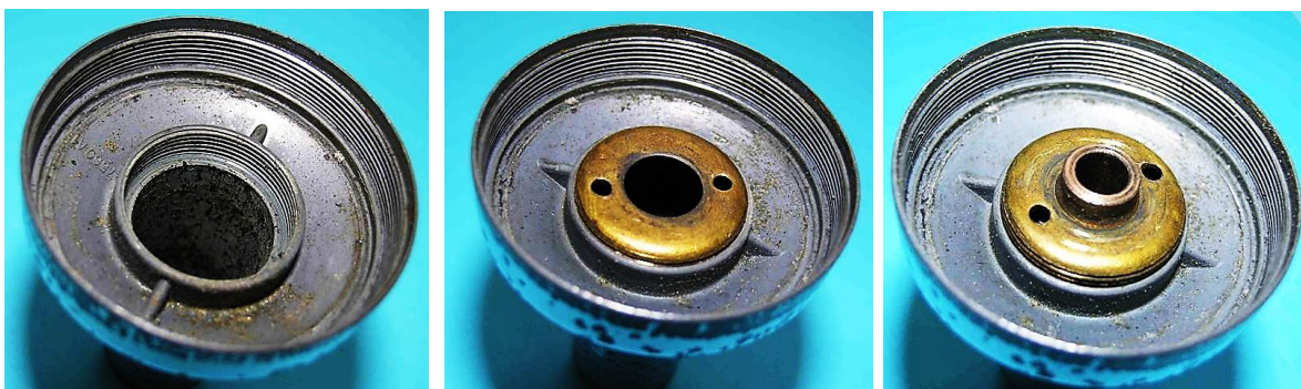
Bild 6.20: Lagerhalsfuß: a) Ohne Lager, b) Mit eingeschraubtem Lagerschild, c) Mit Kalottenlager
