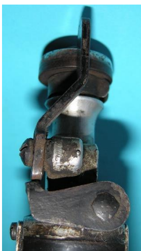
Bild 3.110: Hebelstellungen: a) Ruhestellung, b) Betriebsstellung und Beschriftung des hinteren Pollückenblechs
