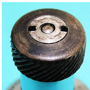
Bild 5.43: Reibrad: Kontern des Reibrades mit einer eingelassenen Schlitzmutter, b) Raum im Reibrad für die Schlitzmutter, c) Schlitzmutter d) Gewindezapfen zum Kontern
