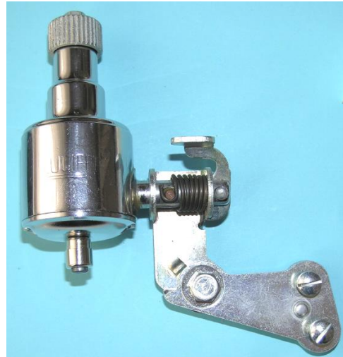
Bild 7.20: Halterung: a) Mit dem Halterarm verlängertes Basisblech, b) Angeschraubter Halter
