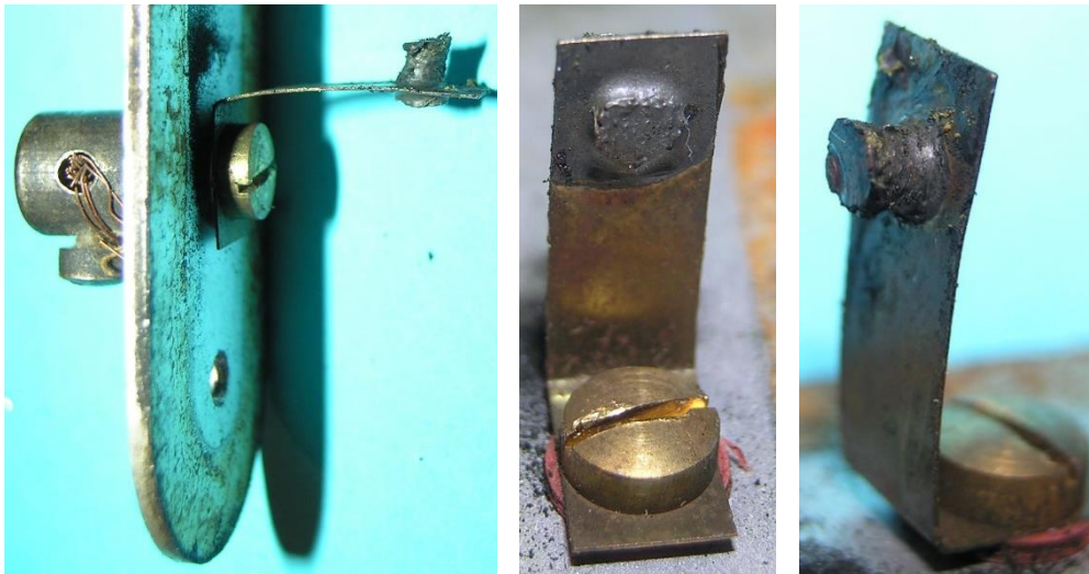
Bild 3.121: Kabelanschluss: a) Pollückenblech mit der Kombination aus Spannung führender Bürste und Kabelanschlussklemme, b) Einspannung der Blattfeder, c) Mit Zinn stabilisierte Kupfergewebebürste
