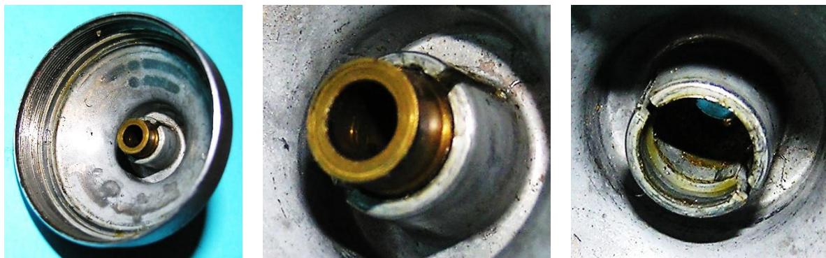
Bild 5.26: Unteres Lager: a) Lagerhalsfuß mit Innengewinde, b) Lagerposition, c) Lagersitz
