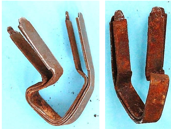
Bild 4.14: Doppelpolpaar in zwei ausgewählten Ansichten
