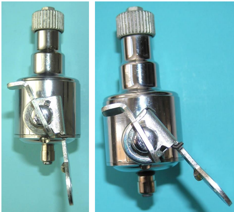
Bild 7.18: Stellungen des Dynamokörpers: a) Ruhestellung, b) Betriebsstellung
