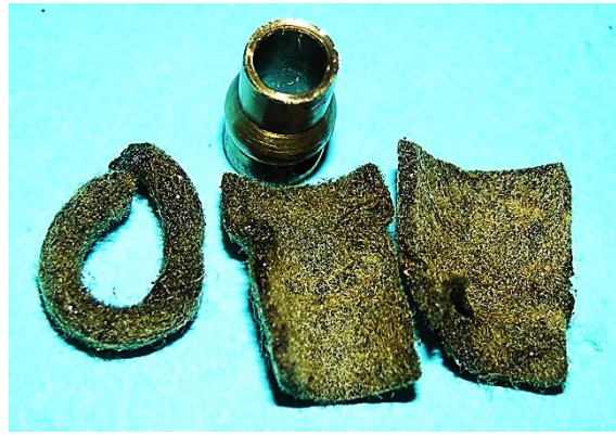
Bild 5.42: Oberes Kalottenlager mit Filzelementen
