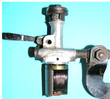
Bild 3.114: Lagerhals mit Anker: a) Ansicht des Ankerpolschuhs, b) Blick auf die Pollücke
