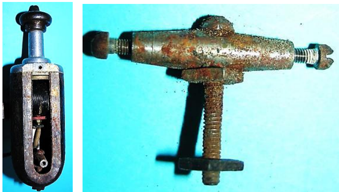
Bild 3.26: Spannstege: a) Position des Spannstege im Jochbogen des Magneten, b) Spannstege mit den schrauben zur Befestigung der Pollückenbleche und dem Bolzen zur Befestigung am Magneten
