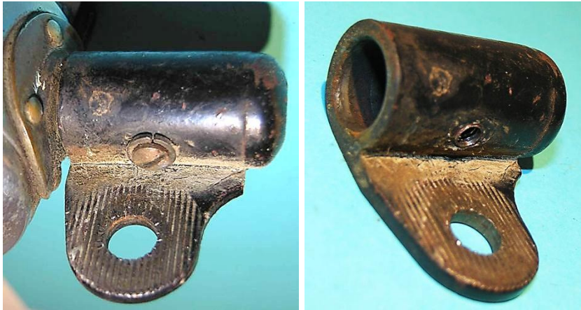
Bild 4.26: Kippeinrichtung: a) Befestigung mit ovalem Flansch, b) Abdeckung und Befestigungsflasche als gemeinsames Bauteil
