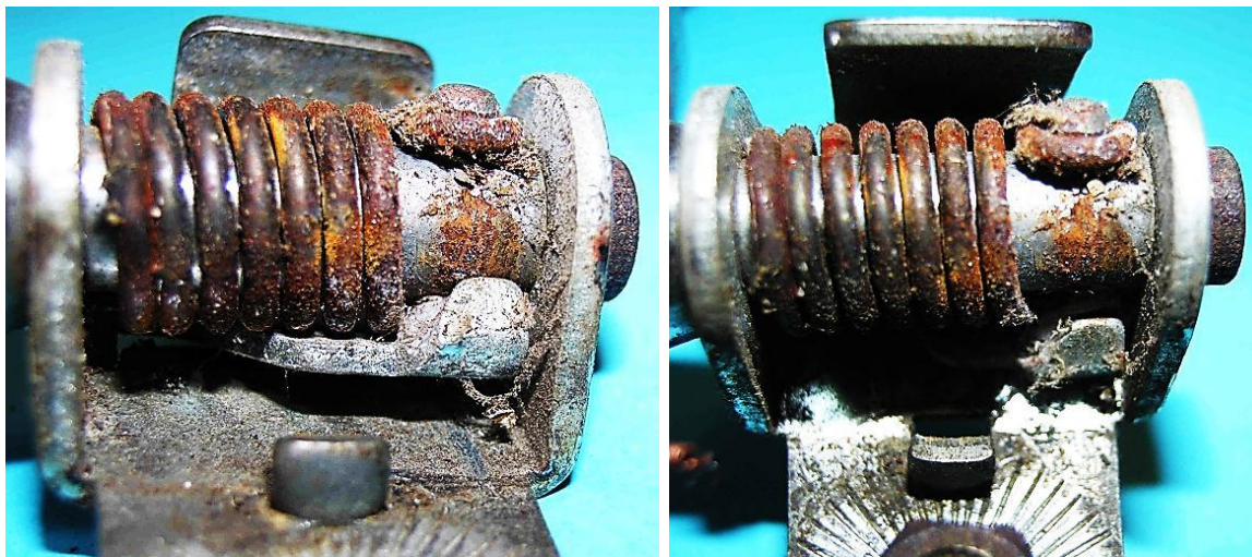
Bild 6.10: Veränderung der relativen Lage von Sperrstift und Fußhebel: a) Ruhestellung, b) Betriebsstellung
