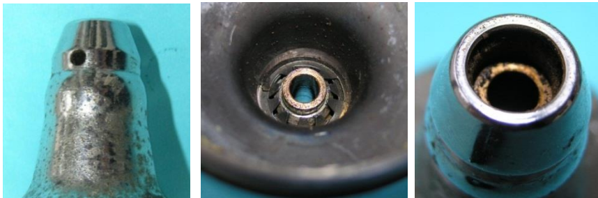
Bild 4.58: Einbau des oberen Kalottenlagers: a) Ölbohrung b) Kalottenbrille c) Kalotte unterhalb des Reibrades
