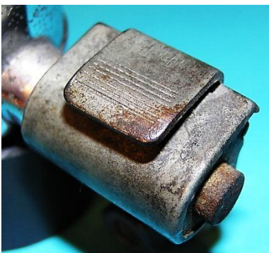
Bild 2.9: Basisblechfußhebel - Auslösung der Kippbewegung des Dynamokörpers durch einen am Basisblech gelagerten Fußhebel
