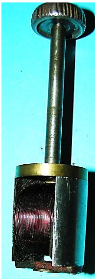
Bild 3.107: a) Einseitig gelagerter Läufer, b) An den Polschuhen angeschraubter Flansch, c) Überstehender Flansch in der Pollücke
