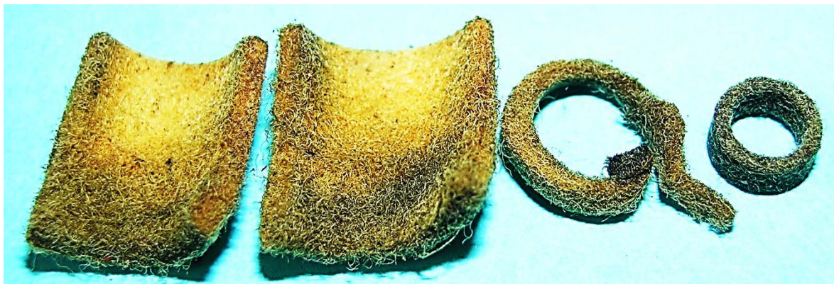
Bild 5.28: Öldepot: a) und b) Filzmatten, c) Filzring am oberen Lager, d) Filzring zwischen den Lagerkalotten
