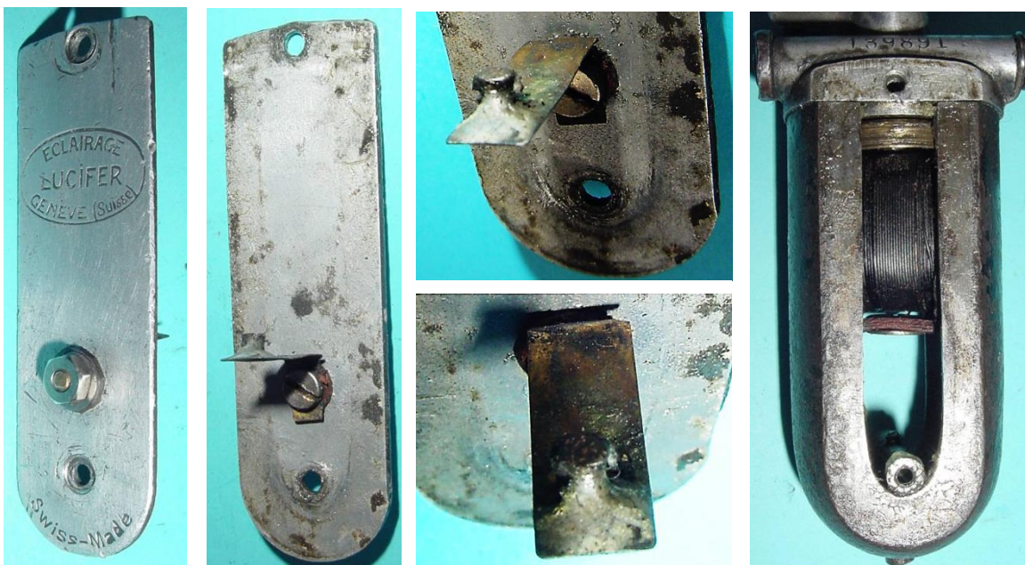
Bild 3.59: Abdeckung der Pollücke mit dem spannungsführenden Kontakt
