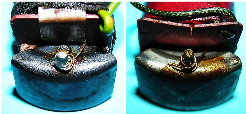
Bild 5.75: Masseanschluss: a) Lucifer 800 D b) Lucifer 800a S
