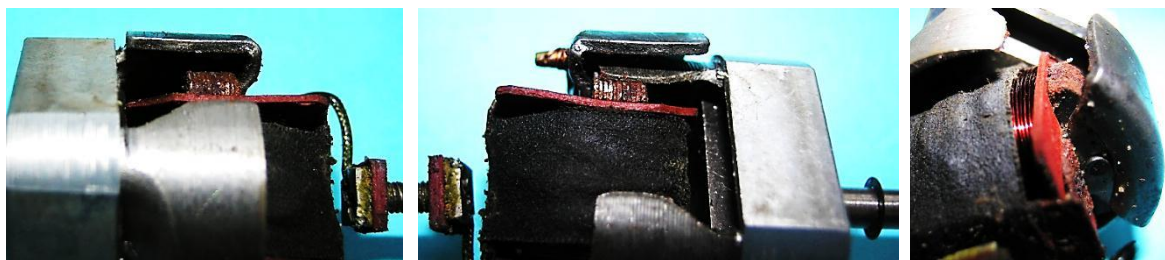
Bild 5.61: Positionierung der Polschuhe des Polrades zwischen den Ankerpolflächen
