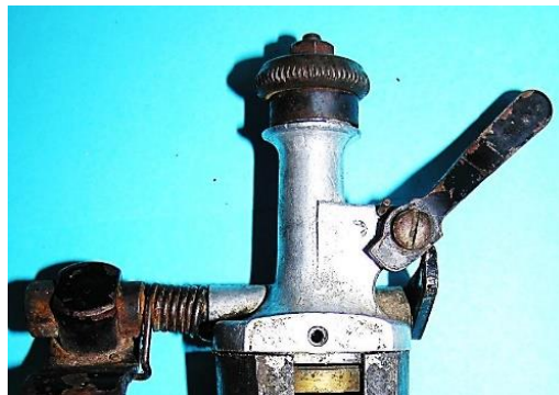
Bild 2.7: Starre Verbindung von Halter und Drehbolzen a) Drehachse in der Dynamokörpermitte, b) Drehachse am Lagerhalsfuß
