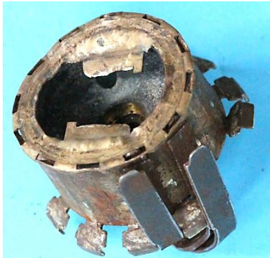
Bild 4.21: Montagekorb mit Ankerpolpaaren: a) Montagekorb mit Abstandsring, b) Abstandsring, c) Montagekorb mit den 6 Doppelpolpaaren
