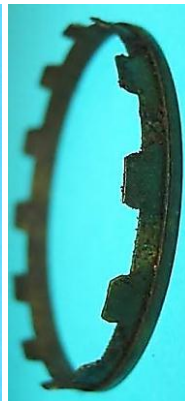
Bild 4.22: Zahnring zur Fixierung der Polspitzen
