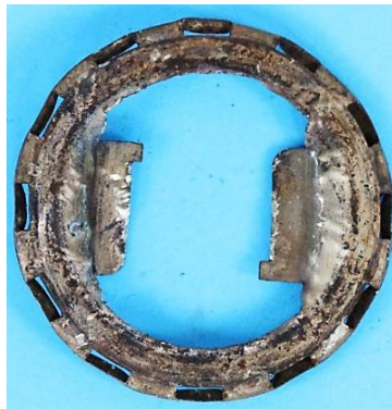
Bild 4.21: Montagekorb mit Ankerpolpaaren: a) Montagekorb mit Abstandsring, b) Abstandsring, c) Montagekorb mit den 6 Doppelpolpaaren
