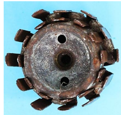
Bild 4.21: Montagekorb mit Ankerpolpaaren: a) Montagekorb mit Abstandsring, b) Abstandsring, c) Montagekorb mit den 6 Doppelpolpaaren
