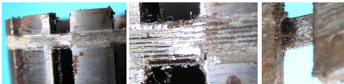
Bild 4.51: Verzinnte Kupferdrahtbandage: a) In Nuten eingelegte Drahtbandage, b) Verzinnte Windungen, c) Ansicht der Bandage von innen
