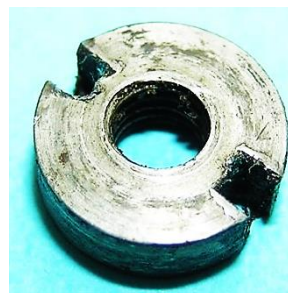
Bild 5.43: Reibrad: Kontern des Reibrades mit einer eingelassenen Schlitzmutter, b) Raum im Reibrad für die Schlitzmutter, c) Schlitzmutter d) Gewindezapfen zum Kontern
