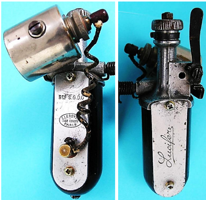
Bild 3.92: Position der Lampe am Dynamo
