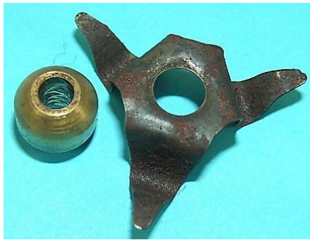
Bild 4.33: Lagerung des Polrades
