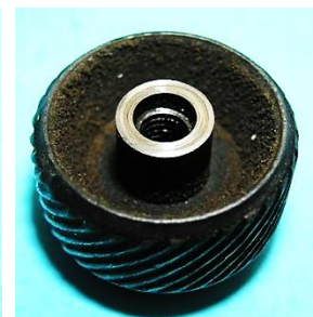
Bild 5.43: Reibrad: Kontern des Reibrades mit einer eingelassenen Schlitzmutter, b) Raum im Reibrad für die Schlitzmutter, c) Schlitzmutter d) Gewindezapfen zum Kontern
