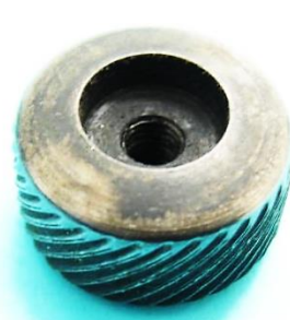
Bild 5.43: Reibrad: Kontern des Reibrades mit einer eingelassenen Schlitzmutter, b) Raum im Reibrad für die Schlitzmutter, c) Schlitzmutter d) Gewindezapfen zum Kontern
