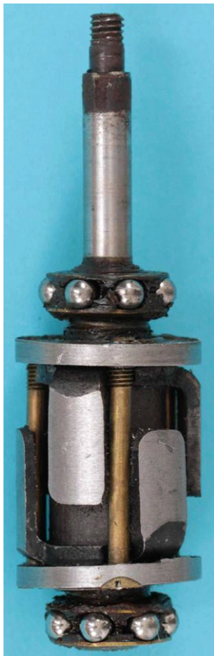
Bild 1.11: Bauteile des Läufers: a) Welle mit Kugellagern und der Klauenpolanordnung, b) Obere Lagerschale mit Öldepot, c) Drei Bauteile des oberen Lagers: c1) Öldepot, c2) Tellerfeder, c3) Lagerschale
