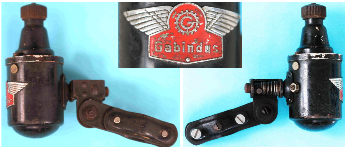
Bild 1.1: Vierpoliger Tulpenmagnetdynamo „Gabindus“
