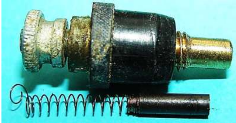
Bild 2.13: Kabelanschluss mit Bürstenhalter
