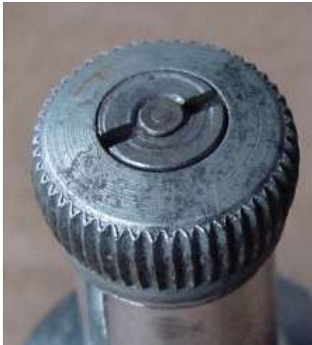
Bild 3.3: Reibrad mit versenkter Schlitzmutter
