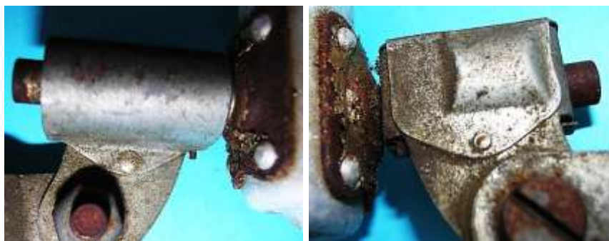
Bild 2.3: Fest vernietete Abdeckung der Kippvorrichtung
