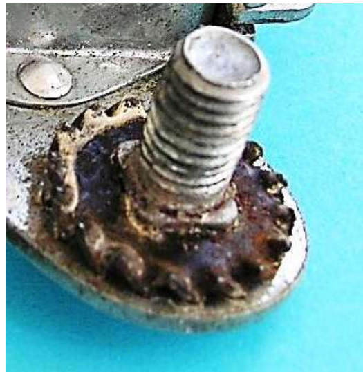
Bild 3.4: Verdreh- sichere Schraub- verbindung des Halterarms mit dem Halter
