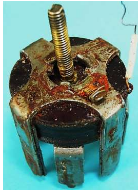
Bild 3.11: Umbörtelung des Spulenkerns: a) Seite des kurzen Klauenpolrings, b) Seite des Langes Klauenpolrings
