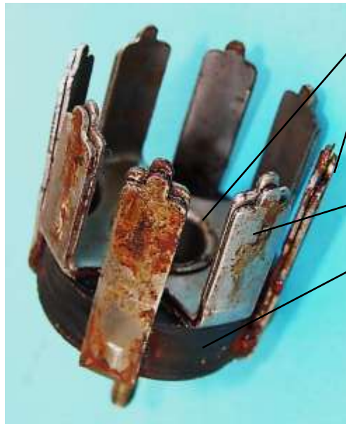
Bild 3.10: Klauenpolanker mit doppelten Polblechen
