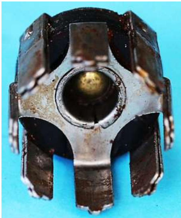
Bild 3.11: Umbörtelung des Spulenkerns: a) Seite des kurzen Klauenpolrings, b) Seite des Langes Klauenpolrings
