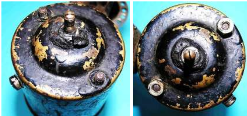
Bild 4: Befestigung des Gehäusetopfes durch Muttern auf den Gewindebolzen
