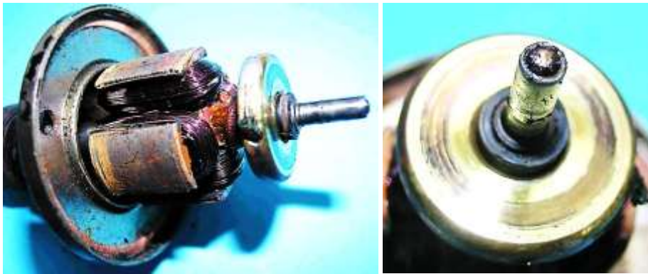
Bild 7: Läufer, a) Anker mit Kontaktteller, b) an der Stirnseite der Welle eingesetzte Kugel als Axiallager
