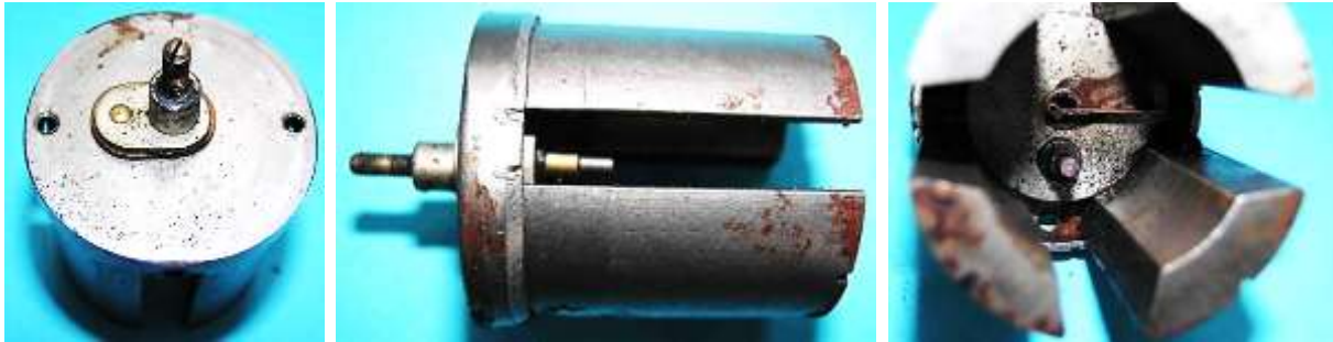
Bild 6: Erregersystem mit Schleifkontakten: a) Joch mit Spannung führendem Kontakt, b) Vier Stabmagnete mit Joch, c) Spannung führende Kohlebürste und Flachfeder zur Masseverbindung
