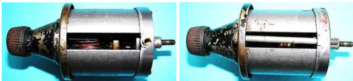
Bild 5: Am Lagerhals angeschraubtes Erregersystem
