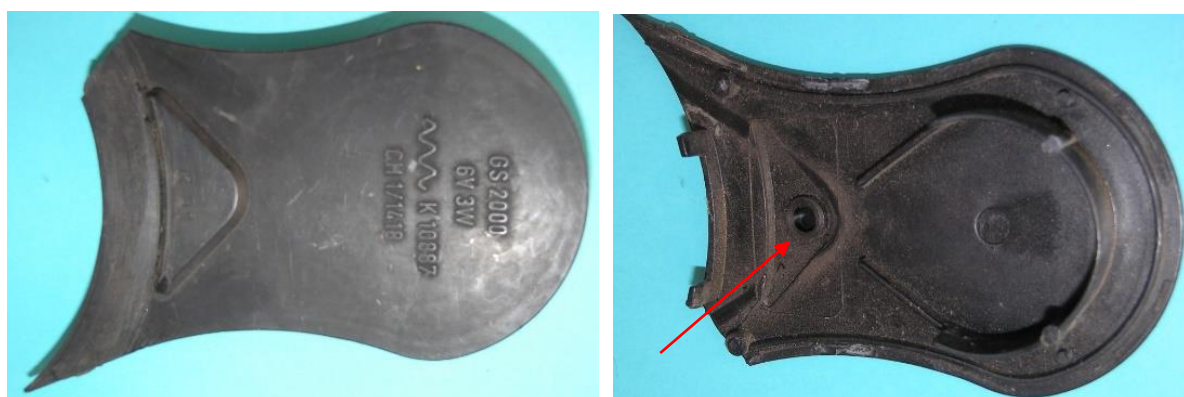
Bild 1.8: Einklinkbare Getriebeabdeckung mit einem Grundloch für eine Getriebeachse
