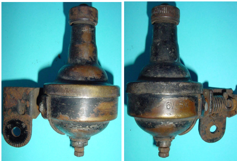
Bild 3.6: Batecla 2: Zweiteiliges Messing- gehäuse
