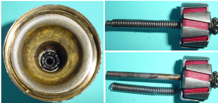
Bild 3.9: a) Lagerhals mit Kugellager b) Anker mit Welle, Feder und Kugellager
