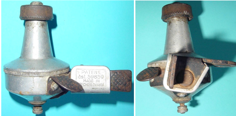
Bild 3.18: Batecla 4: Arbeitsstellung der Kippvorrichtung
