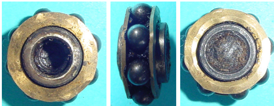
Bild 3.27: Kugellager mit Wellenisolierung
