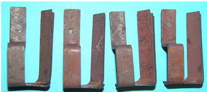
Bild 2.13: Vier Polpaare bestehend aus drei Blechen
