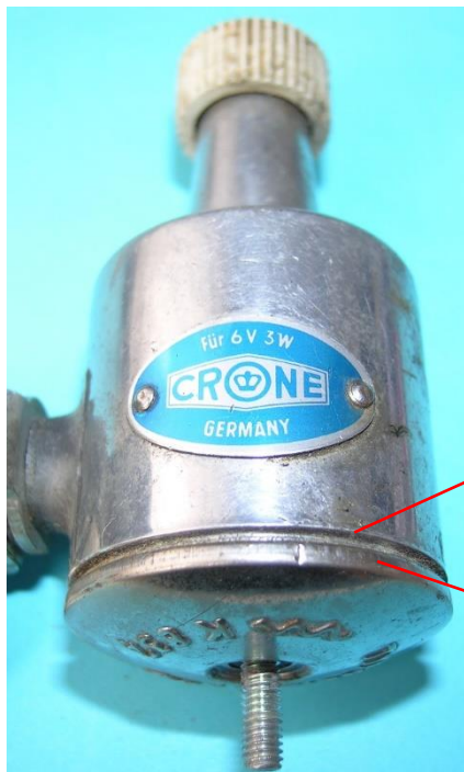
Bild 2.9: Ein 20 mm Reibrad aus Speckstein und ein Stahlboden schließen den Lagerhalstopf oben und unten ab
