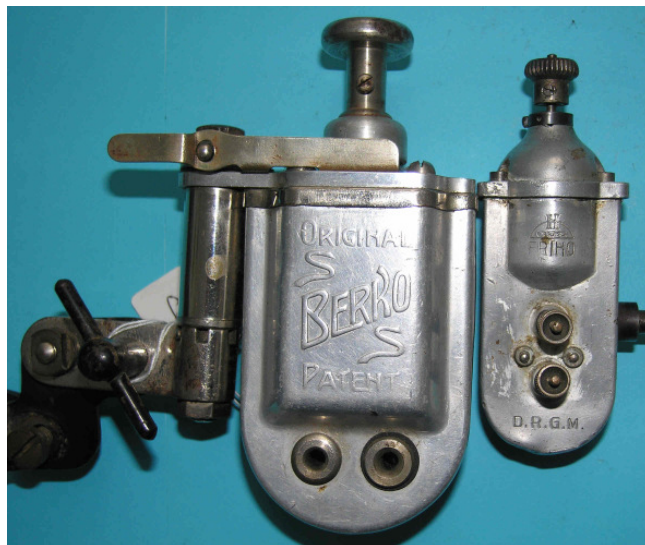
Bild 1.2: Gegenüberstellung der Hufeisendynamos von Berko und Friho
