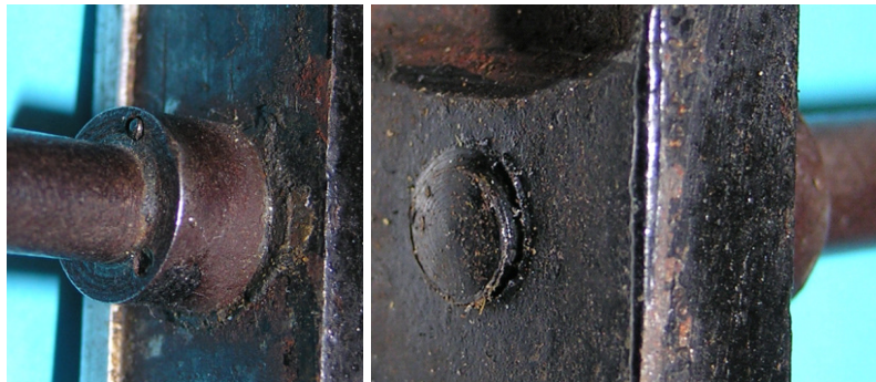
Bild 1.10: Im Magnetschenkel eingeschraubter Drehbolzen, der mit drei Stiften gegen Verdrehung gesichert ist
