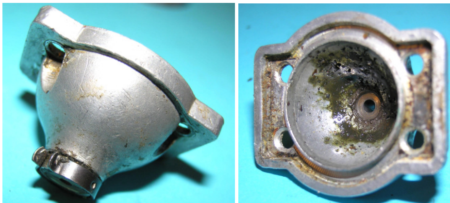
Bild 1.8: Lagerhals mit dem Öllochverschluss und einem Gleitlager
