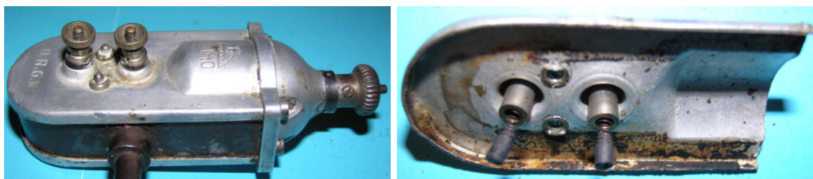
Bild 1.6: Befestigung der Bürstenhalter bzw. Positionierung der Kabelanschlüsse an einem Pollückenblech
