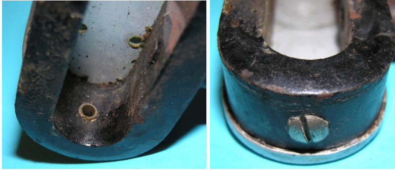
Bild 1.9: Von außen zugängliche Gleitlager im Joch des Magneten
