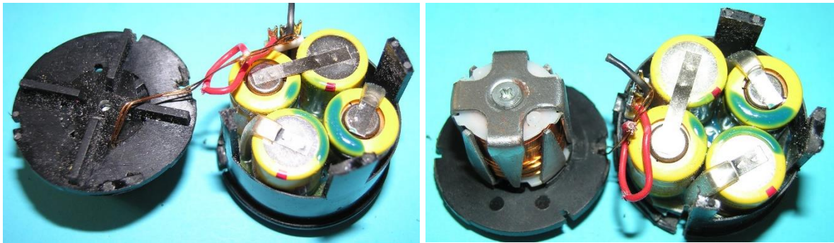
Bild 1.17: Abgenommene Trennplatte: a) Unterseite der Trennplatte, b) und d) Akku- baugruppe im Bodentopf, c) Trennplatte mit angeschraubtem Anker
