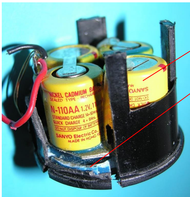
Bild 1.14: Akkumulatorenbatterie und Elektronikbaugruppe im Bodentopf Gewicht 46 g
