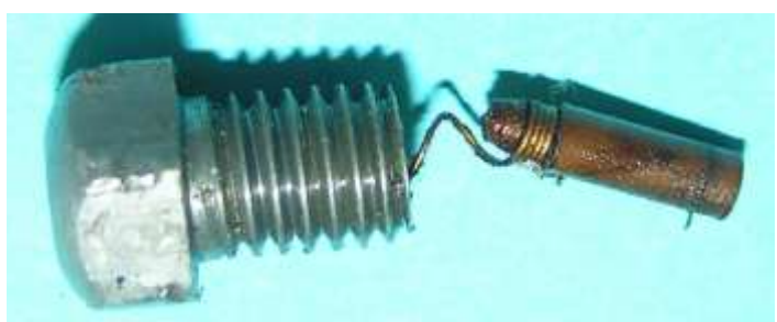
Bild 2.5: Ölbohrung mit Massebürste: a) Bürstenhalter und Kupferbürste, c) Lagerhals mit Bürstenhalter bzw. mit Verschluss der Ölbohrung
