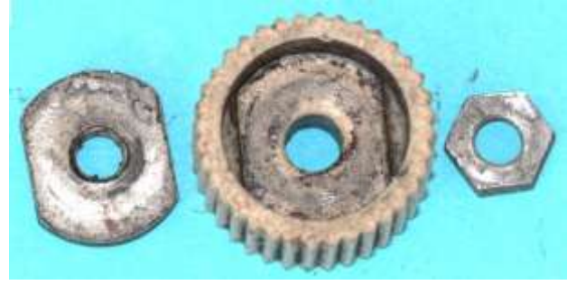
Bild 2.4: Reibradbefestigung: a) Wellenende mit unterer Kontermutter, b) Mutter mit zwei Schlüsselflächen, c) Unterseite des Reibrades mit Passflächen, d) Obere Kontermutter
