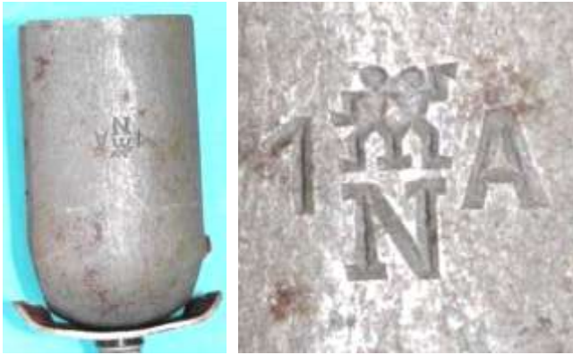
Bild 2.8: Zweipoliger Tulpenmagnet (5,5 mm dick) mit dem Logo der Magnetherstellers Henkels (Zwilling)
