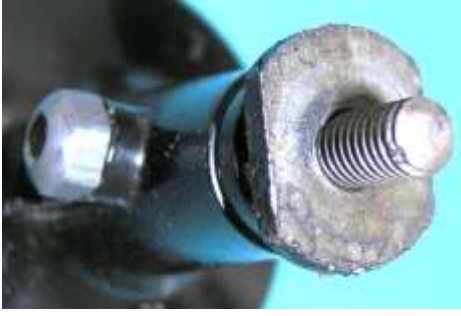
Bild 2.4: Reibradbefestigung: a) Wellenende mit unterer Kontermutter, b) Mutter mit zwei Schlüsselflächen, c) Unterseite des Reibrades mit Passflächen, d) Obere Kontermutter
