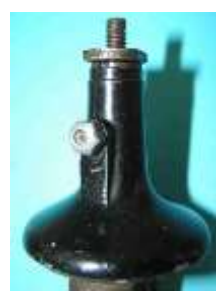
Bild 2.5: Ölbohrung mit Massebürste: a) Bürstenhalter und Kupferbürste, c) Lagerhals mit Bürstenhalter bzw. mit Verschluss der Ölbohrung
