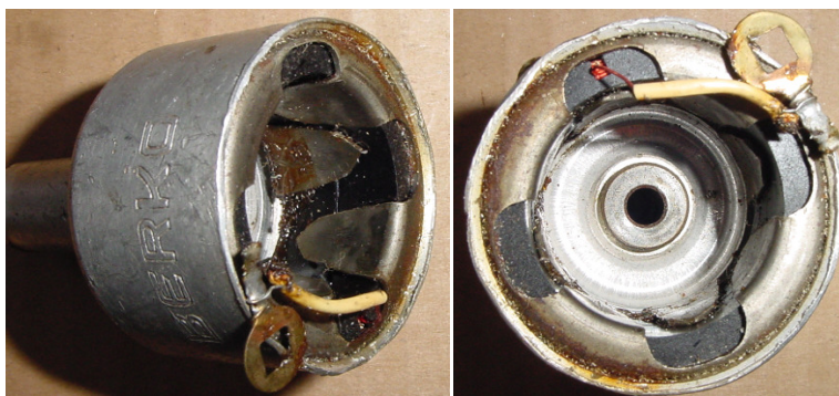
Bild 1.51: Im Gehäusemantel eingepresster Anker
