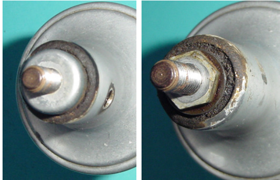
Bild 1.31: Abdeckung der unteren Kontermutter mit einer Staubkappe
