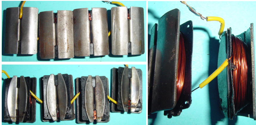
Bild 1.20: Bewicklung der Pole ohne Drahtunterbrechung
