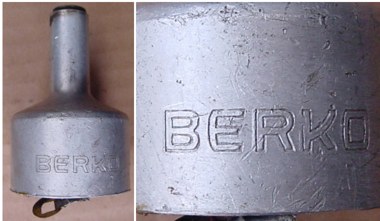
Bild 1.50: Vereinigung von Lagerhals und Gehäusemantel
