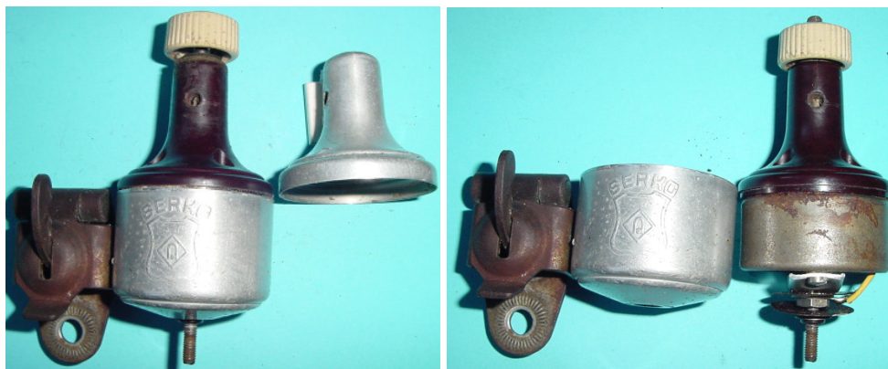
Bild 1.34: Abdeckungen des Generators
