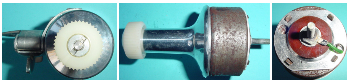
Bild 1.49: Reibradbefestigung mit Rundmutter
