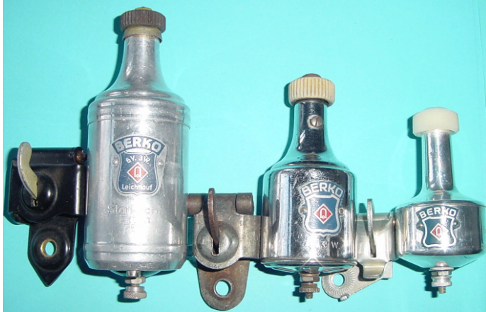
Bild 1.3: Entwicklung der Dynamos vom Stabmagnet-Dynamo zum vier-und achtpoligen Walzenmagnet-Dynamo
