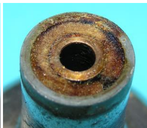
Bild 14: Öldepot: a) Anlaufscheibe und Abdeckung des Öldepots, b) Öldepot mit Filzring, c) Bei der Entfernung des Filzrings entstandene Bruchstelle, d) Filzring
