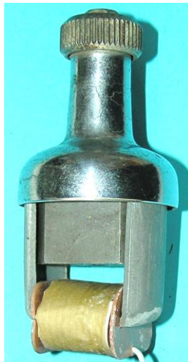
Bild 6: Querschnittszeichnung im Patent im Vergleich mit einem ausgeführten Generator: a) Dynamoquerschnitt im Patent / 1/, b) Generatoransicht der vorliegenden Ausführung
