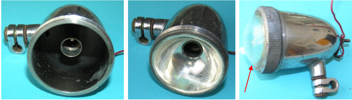
Bild 17: Scheinwerfer: a) Lampengehäuse, b) Reflektor im Lampengehäuse, c) Linsenglas
