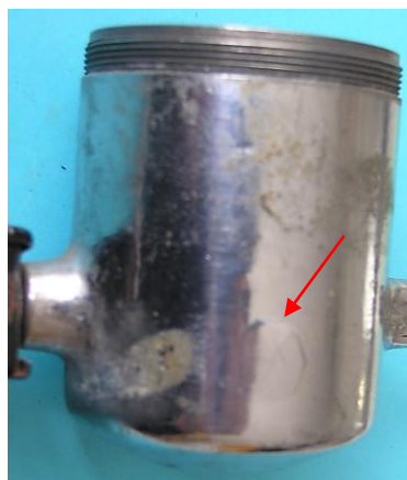
Bild 16: Alterungserscheinungen an der Gehäuseoberfläche
