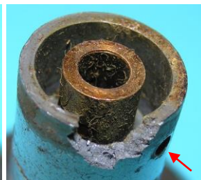
Bild 14: Öldepot: a) Anlaufscheibe und Abdeckung des Öldepots, b) Öldepot mit Filzring, c) Bei der Entfernung des Filzrings entstandene Bruchstelle, d) Filzring
