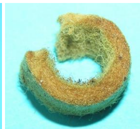
Bild 14: Öldepot: a) Anlaufscheibe und Abdeckung des Öldepots, b) Öldepot mit Filzring, c) Bei der Entfernung des Filzrings entstandene Bruchstelle, d) Filzring
