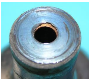
Bild 14: Öldepot: a) Anlaufscheibe und Abdeckung des Öldepots, b) Öldepot mit Filzring, c) Bei der Entfernung des Filzrings entstandene Bruchstelle, d) Filzring
