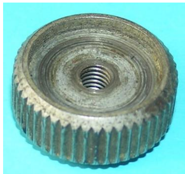
Bild 15: Reibrad: Höhe 10 mm, Durchmesser 22 mm
