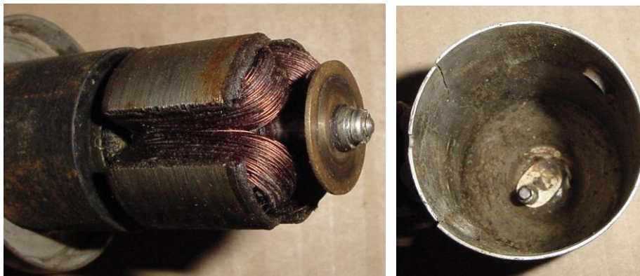
Bild 2.15: Spannung führender Schleifteller und Kohlebürste
