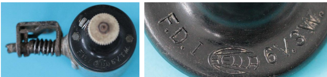
Bild 4.2: Lagerhals: a) Ansicht von oben, b) Beschriftung auf dem Lagerhalsfuß
