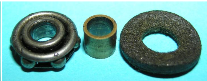
Bild 2.17: Oberes Kugellager: a) Eingesetztes Kugellager, b) Kugellager entfernt, c) Kugellager, d) Distanzhülse, e) Filzring
