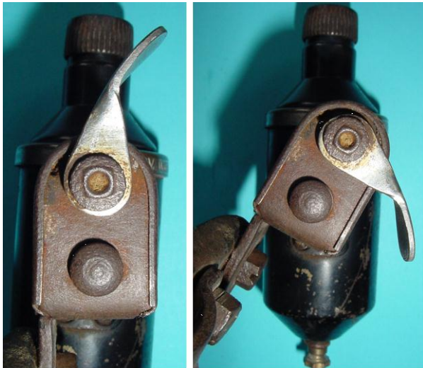
Bild 2.5: Ruhe- und Betriebsstellung der Kippvorrichtung
