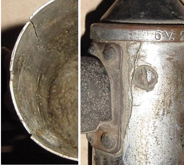
Bild 2.6: Risse im Gehäusemantel am Rand des Flansches der Kippeinrichtung
