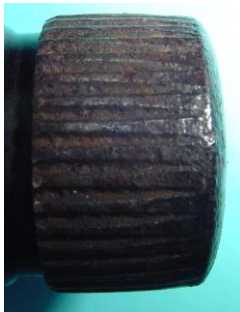
Bild 2.18: Reibrad mit Innengewinde und versenkter Kontermutter
