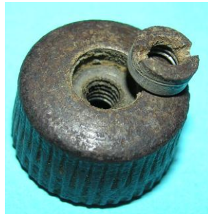
Bild 2.18: Reibrad mit Innengewinde und versenkter Kontermutter
