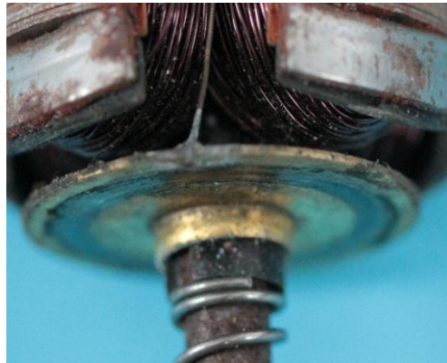
Bild 4.9: Spulens- anschlüsse: a) Massekontakt, b) Lötstelle an der Peripherie der Schleifscheibe
