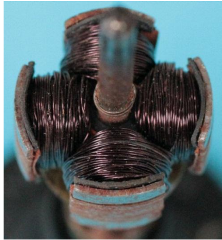
Bild 4.8: Anker: a) Polflächen des Blechpakets, b) Unterer Wicklungskopf
