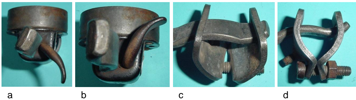
Bild 6.7: Hand- bzw. Fußhebel zur Bedienung des Dynamos: a) Betriebsstellung, b) Ruhestellung, c) Schellen zur Befestigung an der Gabel, d) Einzige Schraubverbindung an der Kipp- und Haltevorrichtung
