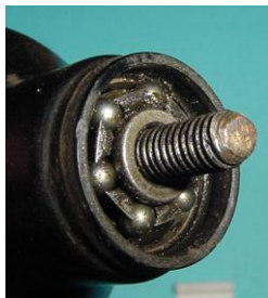
Bild 2.17: Oberes Kugellager: a) Eingesetztes Kugellager, b) Kugellager entfernt, c) Kugellager, d) Distanzhülse, e) Filzring
