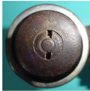
Bild 2.18: Reibrad mit Innengewinde und versenkter Kontermutter
