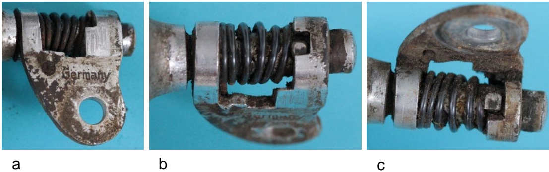
Bild 7.5: Ruhestellung der Kippvorrichtung: a) Basisblech mit der Inschrift „Germany“, b) Sperrstift schlägt an der Nutkante an, c) Unteres Ende des Sperrstifts
