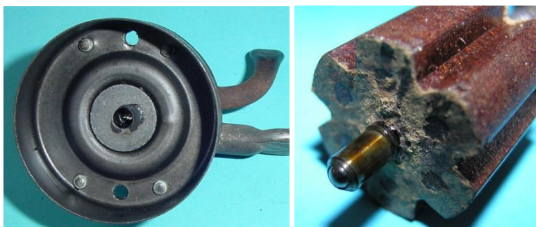
Bild 6.11: Untere Lagerung: a) Lagerbuchse im Boden, b) Kugel am Wellenende als axiales Stützelement
