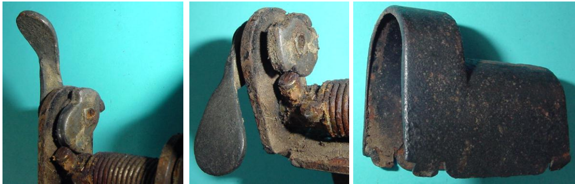
Bild 2.4: Kurvenscheibe der Kippvorrichtung: a) Ruhestellung, b) Arbeitsstellung, c) Schutzkappe
