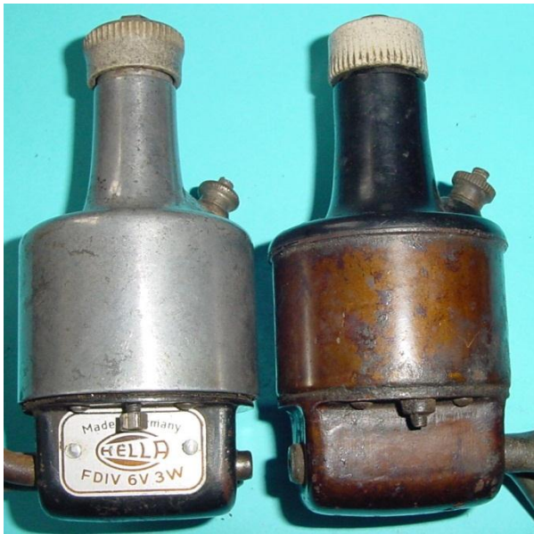
Bild 6.1: Zwei Gehäusevarianten Hella III und IV bei gleichen Konturen
