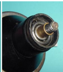
Bild 2.17: Oberes Kugellager: a) Eingesetztes Kugellager, b) Kugellager entfernt, c) Kugellager, d) Distanzhülse, e) Filzring
