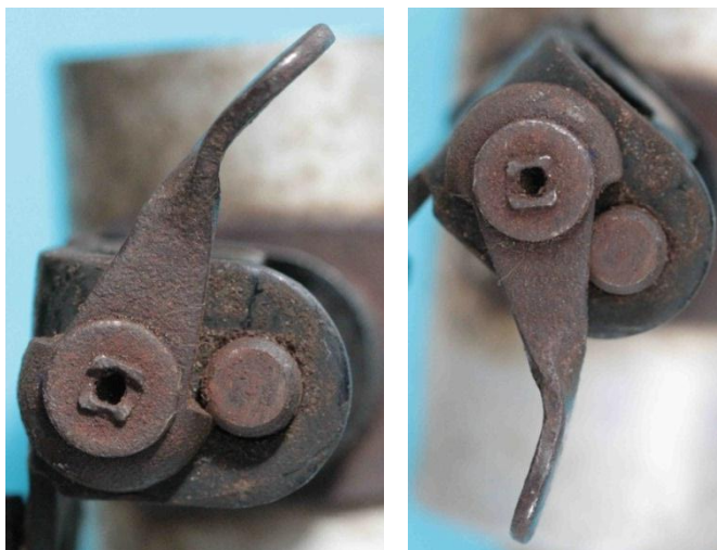
Bild 3.4: Hebelstellungen: a) Ruhestellung, b) Betriebsstellung
